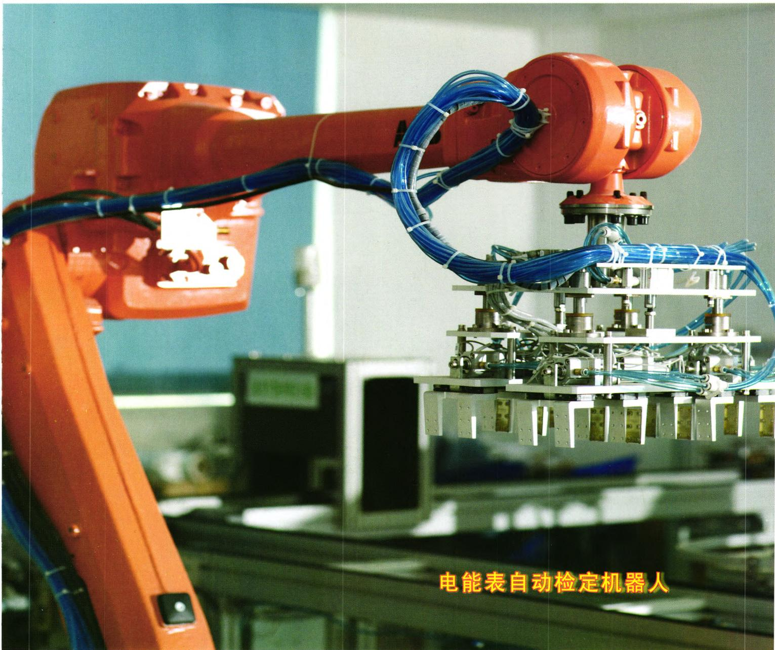
电能表自动检定机器人
