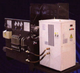
机床镗铣床液压系统
