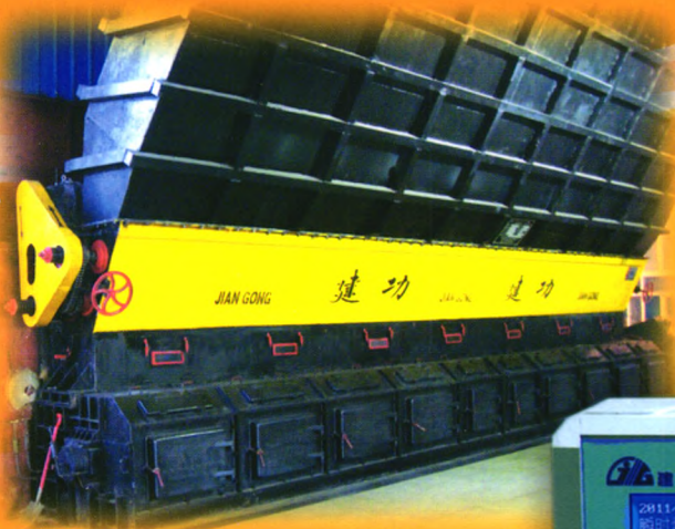
130t/h单炉排分层分行分段给煤装置
