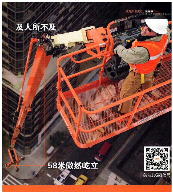
隆重推介全球领先高度的自行式直臂高空作业平台。全新1850SJ拥有更高的工作高度,更强的稳定性以及更大的作业范围。可以轻松升高至58.56米的作业高度,创新型底盘还可前后延伸。1850SJ配备454/227千克的平台载重,堪称业界一流的超强高空作业平台。
