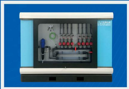
次氯酸钠发生器是通过电解食盐水(或经处理的海水)产生次氯酸钠溶液的装置,是由电解系统、投加系统、自动控制系统等部分组成,制成的次氯酸钠溶液是一种强氧化剂,具有很强的杀菌、漂白效果,是目前应用最广泛的消毒剂之一。相对于液氯和二氧化氯,其安全性高、设备操作简单,维护工作量少、运行成本低,因此水处理消毒采用次氯酸钠发生器代替传统的液氯和二氧化氯已成为一种趋势。
