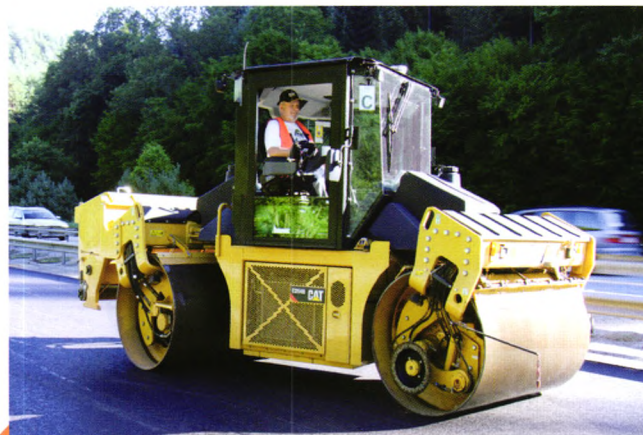
P52 GPS自动成图系统有助于压实效果更加平整均匀
