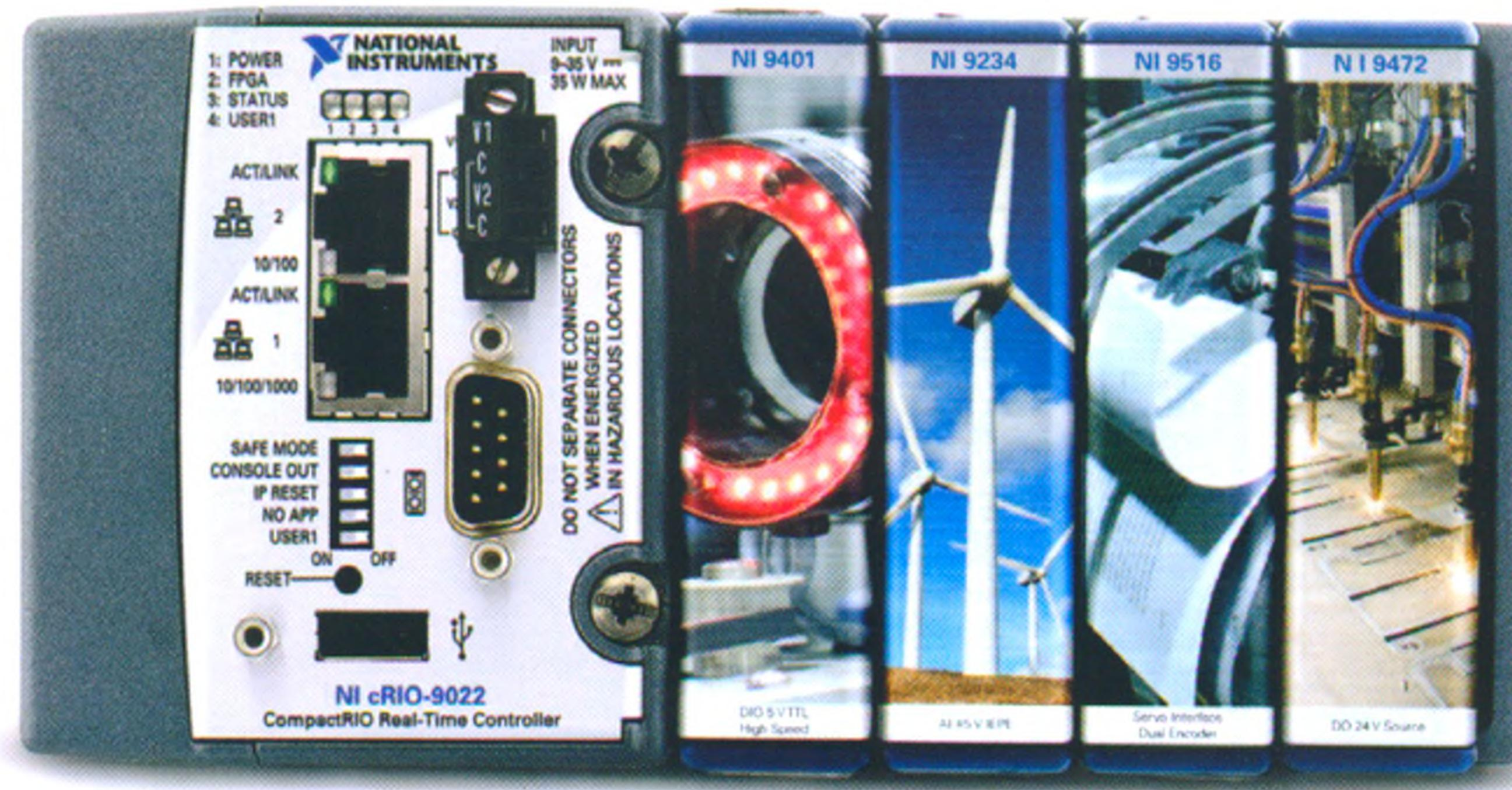
NI为控制应用提供了基于FPGA技术的现成可用的硬件平台，不仅具备工业级的可靠性，还拥有丰富的I/O模块连接各种现场信号。借助灵活开放的LabVIEW图形化编程开发环境，在简化FPGA编程复杂度的同时，还能确保在硬件平台上通过交互式的调试实现优化的控制策略。无需漫长的底层硬件开发与调试，现成可用的平台助您定制您的控制系统，将开发与调试时间降低。
