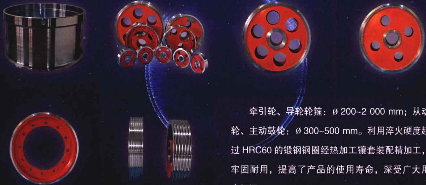
牵引轮、导轮轮箍:  $\varnothing$  200~2 000 mm; 从动轮、主动鼓轮:  $\varnothing$  300~500 mm。利用淬火硬度超过 HRC60 的锻钢钢圈经热加工镶套装配精加工, 固耐用, 提高了产品的使用寿命, 深受广大用户好评!
