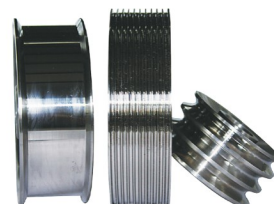
过线导轮 (表面喷涂碳化钨或全合金真空处理)
