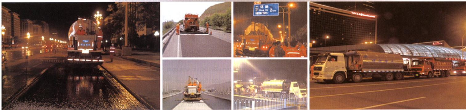
“增达”智能型橡胶沥青洒布车是在吸收国内外同类产品各项技术的基础上，结合国内施工环境开发的具有国际领先地位的高科技产品。该车在沥青罐内设有强力搅拌装置，有效地解决了橡胶沥青极易沉淀、离析的问题；优化改进的加热系统不仅加热快速而且节能环保；喷洒系统采用特殊设计，能跟随车速变化自动控制洒布量，确保洒布精确、均匀、稳定，洒布宽度可达 6.2m；在施工过程中其不仅可以洒布橡胶沥青，还可以洒布乳化沥青、稀释沥青、热沥青、重交沥青和高粘度的改性沥青。
