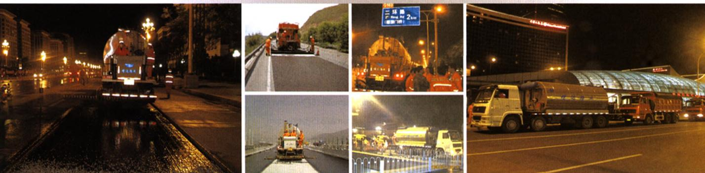
“增达”智能型橡胶沥青洒布车是在吸收国内外同类产品各项技术的基础上，结合国内施工环境开发的具有国际领先地位的高科技产品。该车在沥青罐内设有强力搅拌装置，有效地解决了橡胶沥青极易沉淀、离析的问题，优化改进的加热系统不仅加热快速而且节能环保，喷洒系统采用特殊设计，能跟随车速变化自动控制洒布量，确保洒布精确、均匀、稳定，洒布宽度可达 6.2m，在施工过程中其不仅可以洒布橡胶沥青，还可以洒布乳化沥青、稀释沥青、热沥青、重交沥青和高粘度的改性沥青。
