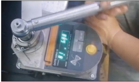
图 8 扭矩试验示意图
