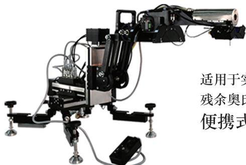
适用于实验室及车间现场残余应力、残余奥氏体含量测量而设计制造的一款便携式X射线应力仪。
