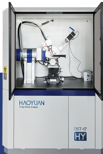
产品符合ASTM E915-2010、EN15305-2008及GB/T 7704-2017等残余应力分析检测标准。
