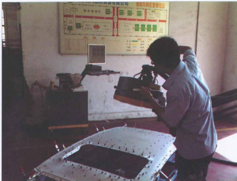
——在南京南汽模具装备有限公司的大型模具型面数控加工的质量过程控制方面, 过去采用大型桥式三坐标测量仪, 但测量过程冗长费力。现在他们选择了Cognitens拍照式检测系统, 为缩短模具的生产制造周期带来新的解决方案……
