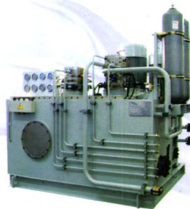
大型液压清洗系统
