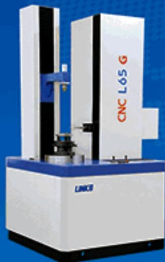
高精度齿轮测量中心
