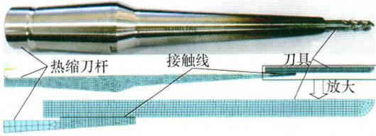
**摘要:** 为得到热缩刀杆与刀具配合公差与其最小装夹温度之间的精确关系,对影响刀杆接触面最小热位移差值的感应加热长度、热缩刀杆壁厚、锥角、配合长度、内径等因素进行了研究。采用 ANSYS 参数化设计语言,构建具有过盈特征的刀杆与刀具配合的参数化有限元模型,通过试验验证了模型的可靠性。通过获取热缩刀杆接触面的位移分布,结合刀杆与刀具接触状态的表征方法对接触面上最小热位移差值进行了计算。计算结果表明,配合面最小热位移差值随着热缩刀杆壁厚、配合长度、锥角的增加而减小,随着内径的增大而增大,且适当增大感应加热长度也有利于刀具的装夹。最终建立了配合公差所对应的过盈量  $f$  与最小装夹温度  $T$  之间的计算关系式,对刀具在热缩刀杆中的装夹及刀杆的结构设计提供理论指导。
