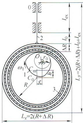
**摘要:** 针对新型的负半径滚子直动推杆盘形凸轮机构, 提出通用有效的可映射尺寸综合方法。阐释新型机构形态构成、基本/总体尺寸和尺寸综合问题准确描述、求解的基本思路与步骤, 提出四项性能评价指标及解析表达, 构建尺寸坐标系  $ORr_0e$ 、尺寸空间  $\Omega(R, r_0, e)$  并离散化-网格化处理, 采取“遍历搜索”思想方法, 在解决单一约束下边界线/解域、边界面/解空间基础上, 解决归并约束下边界线/解域、边界面/解空间问题, 成功实现朝二维、三维尺寸坐标系、尺寸空间的可视映射。据此, 发现和揭示“谷底点/脊底点”、“非劣解区间/区域/空间”、“脊面”、“谷底线/脊底线”和“壑底点”等存在性、重要内涵和求解方法, 系统全面解决了新型机构的尺寸综合问题。通过尺寸综合结果比较, 得到大载荷下, 负半径滚子较正半径滚子机构, 具有“跨数量级”尺寸紧凑、占据空间小的关键性、重要性结论即其优势所在, 对推动、促进广泛付诸工程应用具有重要理论价值和实际意义。
