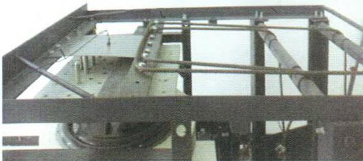
**摘要:** 根据振动时效(Vibration stress relief, VSR)原理, 采用高频振动台作为振动时效的激振装置, 设计安装于振动试验台、用于给钢板施加面内拉伸载荷的钢板张力加载机构, 在实验室搭建出钢板振动时效试验研究平台, 对振动时效消除高强度钢板残余应力的有效性进行试验研究。在 VSR 处理前后采用 X 射线衍射方法对马氏体高强度钢板和试验对照用 T2 镀锡基板的表面残余应力分布进行测量表征, 并同时测量对试样的板形瓢曲和翘曲程度。研究表明, 所设计的振动时效试验平台可以实现带张力工况下的钢板同频激振; 在一定的激振频率和时间的振动时效处理后, 两种试验钢板的残余应力均得到一定程度的消减和均匀化, 但是对于板形瓢曲和翘曲缺陷基本没有改变; 相对而言, 马氏体高强度钢板的时效效果明显弱于 T2 镀锡基板; 试验结果可以反映材料强度对于振动时效效应的显著影响和振动时效对于板形瓢曲及翘曲缺陷的微弱影响。
