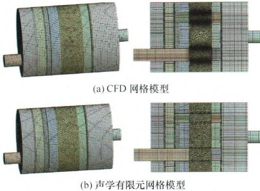
**摘要:** 为了准确研究温度与气体流动对某轿车穿孔管消声器声学性能的影响, 建立消声器的结构模型与内部流体域模型, 并分别划分流体域的计算流体力学(Computational fluid dynamics, CFD)网格与声学有限元网格。利用 Fluent 软件对消声器内部的温度场与气流速度场进行仿真计算。通过网格映射的方法, 将 CFD 网格上温度、气流速度等数据转移到声学网格中, 以 CFD 计算结果作为声场分析的边界条件, 应用声学软件 LMS Virtual.Lab Acoustics 对消声器内部声场进行数值模拟, 得到传递损失曲线。研究表明, 介质温度升高使传递损失曲线向高频方向移动; 存在气体流动时传递损失曲线向低频方向移动, 传递损失也有所增加, 尤其是在 20~200 Hz 的低频段内变化较为明显, 但总体来看变化幅度不大。
