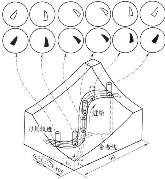
**摘要:** 刀具接触区界定了切削过程刀具与工件的相互作用范围,是研究切削力学/动力学的基础,复杂曲面加工的刀具接触区往往呈现不规则几何形状且沿曲线刀具轨迹不断变化。针对球头铣刀复杂曲面多轴加工,提出一种刀具接触区半解析建模方法。基于微元离散和刚体旋转变换的思想,将一般复杂曲面加工看成是一系列微小斜面加工的组,并且认为球头铣刀斜面多轴加工的刀具接触区,可由球头铣刀水平面三轴立铣加工的刀具接触区经刚体旋转变换而得。通过将切削余量材料看成是一系列微厚材料薄层的叠加,构建了球头铣刀水平面三轴立铣加工的刀具接触区解析模型,从而建立球头铣刀复杂曲面多轴加工的刀具接触区半解析模型。仿真实例分析了模型的精度和效率,结果表明该半解析模型能够精确高效地描述复杂曲面多轴加工的刀具接触区。
