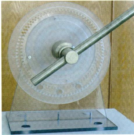
**摘要:** 重合度是衡量齿轮传动性能的重要指标,较高的重合度对于提高齿轮的承载能力和传动的平稳性具有重要意义。考虑到摆线齿形的优越性,提出一种具有高重合度的新型内啮合复合摆线齿轮副;根据内、外摆线无包心形成法与包心形成法之间的等效关系,阐明内、外齿轮齿顶与齿根之间的齿廓配合关系,给出使重合度最大化的圆弧啮合线位置及其数学描述;结合坐标变换和齿轮啮合原理,建立共轭齿廓的数学方程,并由已知的啮合线推出适用于任意齿廓形状的齿轮端面重合度的统一计算式,推算上述内啮合摆线齿轮副的最大重合度,分析影响重合度的相关因素,指出提高重合度的可能途径。据此,运用 Solidworks 软件实现了高重合度内啮合摆线齿轮副的参数化建模,结合具体实例与标准渐开线内齿轮副进行比较研究,并就同时参与啮合轮齿的对数情况进行有限元仿真分析和光弹试验测试。结果表明,所设计的内啮合摆线齿轮副具有很大的重合度,可以达到十几甚至更大,且仿真及实测结果与理论分析吻合,验证了该齿轮传动理论的正确性。
