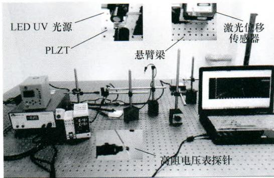
**摘要:** 提出光控压电混合驱动,即利用铁电陶瓷改性锆钛酸铅( $P_6\text{LaZrTi}$ , PLZT)在紫外光照射下产生的光电压驱动压电作动器。这种新型光控方式的研究实现了 PLZT 作动器的非接触激励、抗电磁干扰的光激励特性与压电作动器响应速度快等优势互补。基于等效电学模型建立了在光-热-力-电等多能耦合作用下,压电作动器驱动电压及应变的本构模型;对作动器应变滞后性进行试验分析并与 PLZT 作动器进行了对比;对光控压电混合驱动的影响因素进行研究,探讨了光照强度、作动器电极表面面积、厚度等尺寸参数对作动器驱动电压的影响规律。
