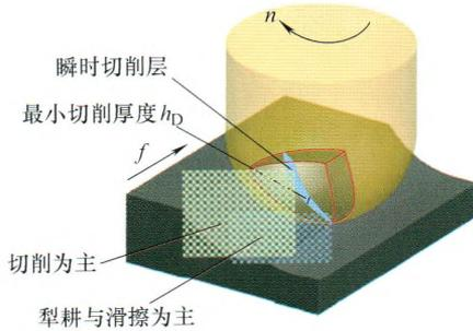
**摘要:** 汽车覆盖件模具精加工中,精加工余量较小,较小的精加工余量与刀具刃口钝圆半径处于相同数量级,为了实现汽车覆盖件模具的高品质加工,刀具刃口钝圆半径的影响应当引起重视。刀具刃口钝圆半径存在,使得塑性材料加工中存在最小切削厚度,当实际切削厚度小于模具材料最小切削厚度时,刀具与工件之间将出现滑擦,导致汽车覆盖件模具的加工精度和表面质量难以保证。提出一种确定最小切削厚度的新方法,该方法基于球头铣削方式,并验证所提出方法的有效性;以汽车覆盖件模具常用材料淬硬钢 AISI D2 为研究对象,采用所提出的最小切削厚度确定方法,确定不同硬度淬硬钢 AISI D2 材料的最小切削厚度值,研究速度效应对淬硬钢 AISI D2 材料最小切削厚度的影响规律,研究结果表明:在所选切削参数范围内,温度效应对淬硬钢 AISI D2 材料成屑的影响大于应变率效应的影响,此时随着切削速度的增加,最小切削厚度值增大。
