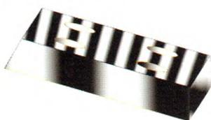
**摘要:** 检验试件是对机床动态精度的最终考量, 然而目前基于试件切削的机床性能评估还存在很多不确定性。通过分析四种常用的五轴机床精度检验试件造型方法, 计算各试件的曲率、开闭角、扭曲角等重要几何特征, 研究试件加工过程中各轴加速度冲击的跳变位置, 得出试件几何特征是其具备检验特性的关键。最终, 通过切削试验验证中国“S”试件的优越性。基于检验试件的分析有助于建立试件与机床动态性能间的映射关系, 完成加工后误差的定向溯源与辨识, 为采用试件切削的评价方法提供更加充分的依据。
