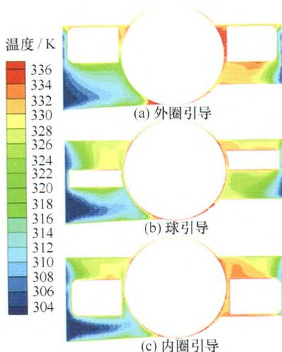
**摘要:** 滚动轴承高速运转时,轴承腔内空气流动加剧诱发漩涡及高压气障,影响油气输运及整体润滑性能。针对超高速时( $d_m n$  值 $\geq 2.0 \times 10^6 \text{ mm} \cdot \text{r} \cdot \text{min}^{-1}$ )角接触球轴承腔内的气相流动问题,考虑轴承结构特点、接触特征及运动边界,采用旋转坐标系定义组件运动,建立轴承腔内气相流动高精度分析模型,分析了在保持架不同引导方式下轴承腔内压力分布、气相流动与阻力,温度场等变化规律,并基于场协同理论评判了轴承内部关键接触润滑区域的流动与换热性能。结果表明,超高速下轴承腔内压差急剧增大,外圈引导时轴承腔内流速、流阻、流动协同角最大,钢球表面动压明显。当转速超过  $3.0 \times 10^4 \text{ r} \cdot \text{min}^{-1}$  时,轴承内圈接触区入口附近出现不同程度漩涡流动,导致接触区入口协同角增大,流动性能变差。该研究对超高速轴承结构设计、润滑结构及润滑参数优化具有重要的参考意义。
