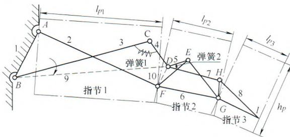
**摘要:** 欠驱动机器人手指结构紧凑、抓持力大、操作简单, 在工业机器人、拟人机器人、人体假肢及航天机器人等领域都具有广泛的应用前景。提出一种新型的全转动关节连杆式欠驱动机器人手指机构, 提出一种基于最小阻尼原理推导欠驱动手指机构在不同抓持状态下(即与目标物体的不同接触情况下)的等效机构, 进而基于等效机构实现运动学分析的方法。采用所提出的方法推导了所提出机构的运动学方程和极限运动位置求解方程。最后通过 Matlab 编程进行数值仿真, 验证了方法的正确性和有效性。仿真结果表明所提出的欠驱动结构具有较大的可达空间, 并可实现良好的抓物轨迹。
