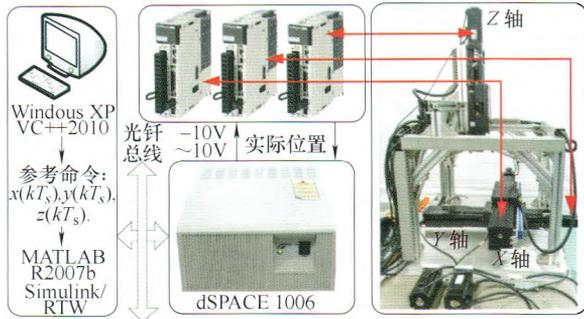
**摘要:** 在多轴数控加工中,轮廓误差直接决定零件最终加工精度。交差耦合控制和任务坐标系法通过估计轮廓误差,并设计轮廓跟踪控制器来提高轮廓精度。这两种方法存在大曲率位置轮廓误差估计精度差,轮廓控制增益整定依赖于工程经验等问题。为此,从伺服轴动态特性匹配出发,提出了一种基于轮廓误差精确计算的轮廓误差补偿控制方法。根据足点定义,采用解析方法快速准确计算轮廓误差。将轮廓误差分量分别补偿到各伺服轴的速度环和转矩环,提高各伺服轴动态特性的匹配程度。采用二维和三维 NURBS 曲线开展轮廓跟踪试验。试验结果表明:所提出的轮廓误差计算方法可以精确求解轮廓误差;所提出的轮廓误差补偿控制方法不需要建立轮廓误差与伺服跟踪误差间的映射关系,且可通过调整控制器增益定量显著减小轮廓误差。
