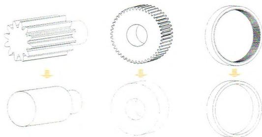
**摘要:** 针对传统集中质量法精度不高和大规模有限元模型计算量大、后处理困难的问题,在轴系单元法基础上提出一种针对行星轮系耦合振动分析建模方法。根据行星轮系结构特点,将行星轮系中各种构件分为简单轴系单元、行星架轴系单元及齿圈轴系单元等轴系模型,建立不同类型的行星轮系耦合动力学模型。研究表明,考虑结构柔性后,在低速阶段动态啮合力偏差与集中质量法求解结果基本相同,但随着转速增加,而动态啮合力偏差与系统各阶共振频率均略有降低;而同一转速下,动态啮合力偏差随着齿圈厚度增大逐渐增加,但其变化量呈逐渐减小趋势。在所有结构中,轴的柔性化对振动影响最大,而行星架柔性对振动影响最小;各级齿轮副啮频相互耦合共同成为系统激励频率,而高速级啮频为最主要激励频率;振动能量不仅沿功率流方向传递,同样也会逆功率流方向传递。
