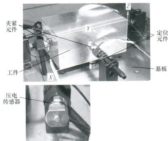
**摘要:** 装夹布局的合理规划是影响工件加工质量与生产安全的关键因素,为此系统地提出了工件位置偏离的动力学预测模型及其控制方法。首先通过将工件与夹具之间的接触模式等价地转化为线性弹簧-阻尼系统,利用运动学和弹性力学理论推导出工件的振动微分方程,以确定工件在装夹布局中的位置偏离。根据工件与夹具之间的接触为单向这一实际情况,运用胡克定律建立了工件位置偏离的约束条件。通过坐标转换方法,提出在约束条件下振动微分方程的模式分析求解方法,实现工件位置偏离的预测,试验结果表明所提出预测结果与试验结果完全吻合。其次,为使工件位置偏离达到最小,构建工件位置偏离的最小 2-范数为目标的装夹布局优化模型,通过以合理装夹布局中工件位置偏离的 2-范数为自变量构造个体适应度,提出装夹布局优化模型的遗传算法求解技术。提出的工件位置偏离预测与控制方法,能够避免工件处于非稳定状态下优化模型的求解过程,为复杂工件装夹布局方案的合理设计提供了基础理论。
