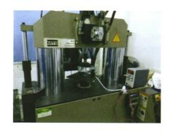
摘要:针对经典集总参数模型无法表述半主动悬置幅变特性的问题,建立了修正的集总参数模型,用于描述半主动悬置的幅变特性。首先,在MTS831 试验台上分别对半主动悬置和橡胶主簧进行了不同位移振幅激励下的动特性试验。根据试验结果,采用遗传算法对半主动悬置的主要集总参数进行了辨识,确定了受幅值影响较大的集总参数。其次,根据参数辨识结果,采用幂指数模型拟合了惯性通道液阻的幅变修正系数,应用二次多项式响应面方法获得了橡胶主簧动特性关于幅值和频率的回归方程,最终建立了修正的集总参数模型。修正的集总参数模型不仅能同时反映半主动悬置的幅变和频变特性,还具有很好的预测功能。通过修正的集总参数模型,分析了半主动悬置幅变动特性的产生机理。
