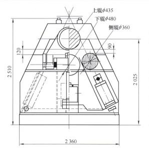
摘要:针对四辊卷板机侧辊位移跟踪控制存在负载变化、参数摄动和未建模动态等不确定性问题,提出一种基于非线性扰动观测器的自适应滑模控制策略。采用非线性扰动观测器在线获取并补偿等效扰动;针对引入非线性扰动观测器后的系统,采用反步法设计自适应滑模控制器,利用自适应律动态补偿扰动观测误差,以降低滑模控制器的切换增益。该设计方法放宽了滑模切换增益对系统不确定性上界的先验性要求,降低了外界干扰和系统不确定性对侧辊位移跟踪性能的影响。同时,采用李雅普洛夫方法证明了侧辊位移跟踪闭环控制系统的稳定性。根据工程实际参数进行仿真,结果表明,该控制策略对系统的不确定性,特别是负载变化具有较强的鲁棒性,可以满足侧辊位移快速、精确跟踪的要求。
