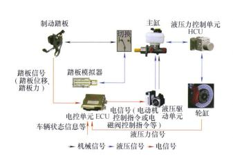
摘要:回顾电子液压制动系统液压力控制问题。电子液压制动系统(Electro-hydraulic brake system, EHB)是汽车制动系统的一个重要发展方向。主要特征是采用电子元器件替代传统制动系统中的部分机械零部件,保留了原有成熟可靠的液压部分,具有结构紧凑、响应快速、易于实现再生制动、制动力可精确控制等突出优点,容易实现多种主动安全控制功能。在剖析电子液压制动系统组成架构的基础上归纳出电子液压制动系统的液压力控制架构,以控制变量和控制算法为突破口,从主缸液压力控制和轮缸液压力控制这两个层面分别对国内外的研究进展进行综述,对能够应用于电子液压制动系统上的电磁阀特性进行分析,对其控制方式进行研究,提出对于电子液压制动系统液压力控制算法的控制精度、适应性和鲁棒性要求进一步提高。液压力控制算法对整车的制动舒适性和操纵稳定性影响也有待进一步讨论。
