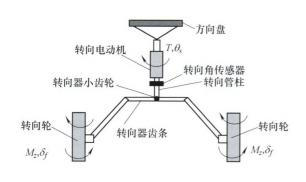
摘要:研究通过对智能汽车转向系统进行主动控制,可靠并准确 地得到期望的转向轮转角。为了提高智能汽车转向系统主动控制 的可靠性、安全性,借助横摆角速度信号、侧向加速度信号和转 向执行电动机电流信号,基于卡尔曼滤波的方法对转向管柱转角 传感器进行实时故障诊断和容错设计。根据诊断和容错结果,并 考虑执行器力矩受限的情况,基于一种条件积分方法,设计前馈 加抗积分饱和的状态反馈控制算法,使转向轮转角渐进稳定到期 望的转向轮转角。并且通过建立李雅普诺夫函数,证明控制系统 的渐进稳定。通过实车试验证明结合故障诊断和容错设计后控制 算法能够有效可靠地实现转向轮转角的精确跟踪控制。
