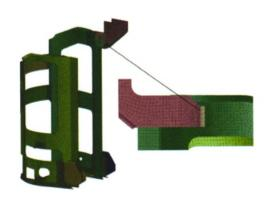
摘要:为了缩短试验周期、节约试验成本、提高试验效率,基于 Visual-Environment 软件平台,采用 3D 高斯热源模型对多焊缝复杂结构薄壁件激光焊接过程进行数值模拟计算。复杂结构薄壁件焊缝多达 19 条,为对接和搭接两种接头形式。首先采用试验与数值模拟计算相结合的方法对典型接头焊缝形貌进行优化。在此基础上,采用热循环曲线法对复杂结构薄壁件的焊接顺序和约束条件进行优化,获得了最优的焊接工艺。研究结果表明,采用 3D 高斯热源模型,选择合适的热源参数能够获得与实际激光焊接接头形貌较一致的温度场云图。采用优化后的焊接工艺所获得结构件的最大变形量与未优化的相比,由 3mm 减小至 0.5mm 以内,满足了实际生产需求。
