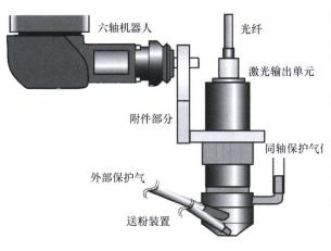
摘要:小功率脉冲激光下飞机叶片的强化是现在急需解决的问题,本试验通过采用光纤传输 300 W Nd:YAG 脉冲激光熔覆系统,在低碳钢(SM400B)上熔覆 Co 基合金(Stellite-6)和碳化钒(VC)混合粉末(VC 的质量分数变化范围为 0~100%),并对熔覆层的性能进行了研究,从而探究小功率脉冲激光下飞机叶片强化的工艺。试验结果表明,随着 VC 质量分数的增加,熔覆层组织由亚共晶组织转变为过共晶组织。当 VC 质量分数小于 80%时,熔覆层硬度、裂纹敏感性及耐磨性能随 VC 增加而增加;当 VC 质量分数大于 80%时,由于母材的稀释作用,熔覆层硬度、裂纹敏感性及耐磨性能随 VC 增加而降低。试验表明,使用 Co 基合金(Stellite-6)和碳化钒(VC)混合粉末可以形成耐磨性好、硬度高,裂纹敏感性低的熔覆层,对飞机叶片产生较好的强化效果。
