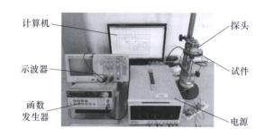
摘要:多涂层结构可显著提高基体材料的耐热性、耐磨性、耐腐蚀性等性能,因此在航空航天、船舶制造等行业得到广泛应用。在工程应用中,涂层厚度是否均匀对基体材料的物理性能产生重要影响。针对近几年出现的多层导电涂层材料,提出一种双层导电涂层厚度的电磁无损检测新方法。采用数值仿真和试验相结合的方法深入研究了多层导电涂层厚度检测中多层材料在厚度检测中的耦合问题及每层厚度与电导率对检测信号的影响问题。最后根据研究结论提出解耦算法反演各涂层厚度,并进行了试验验证。结果表明:文中提出的基于解耦算法的双涂层厚度检测方法对多导电涂层厚度的检测误差均低于10%。该方法也可进一步扩展到三涂层结构甚至四涂层结构的涂层厚度检测中。
