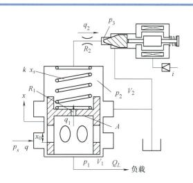
摘要:三通式比例减压阀因其较高的性价比和易维护性而成功应用于水下远程遥控机器人的螺旋桨推进器控制。然而三通比例减压阀内部压力反馈结构复杂,存在死区和液动力等非线性因素,易受螺旋桨负载特性影响而引起压力振荡。根据主阀力平衡方程、压力流量方程和螺旋桨负载特性建立了系统数学模型,并在减压阀的稳态工作点附近进行了模型线性化,通过开环伯德图和闭环频响曲线分析特征参数对阀稳定性的影响。理论分析和试验结果表明,增加阀口流量压力系数和马达泄漏系数可有效提高负载环节阻尼比和稳定裕量,系统稳定性得到显著改善。
