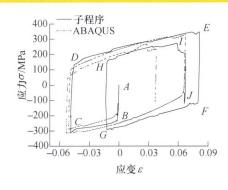
摘要:基于平面应力假设,采用 HILL48 各向异性屈服准则和 A-F 非线性随动硬化模型及塑性流动法则建立一种各向异性非线性随动硬化本构模型。运用向后欧拉回映算法,通过 Fortran 语言编写 UMAT 子程序,将该本构模型嵌入到 ABAQUS 软件中。以板料经过拉深筋的循环加载问题为研究对象,利用开发的本构模型、ABAQUS 软件中的各向同性屈服及随动硬化模型对板料经过拉深筋的变形过程进行数值模拟分析,得到切向应力-应变循环变化曲线。对比试验结果,开发的弹塑性本构模型的计算精度更高,验证了所建本构模型的有效性,该模型可以应用于板料反向加载变形行为研究。
