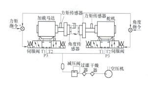
摘要: 气动伺服系统以其具有可压缩性、易实现高速等特点而适用于一种瞬时展开机构的伺服加载测试需求。通过分析气动伺服系统中存在的强非线性及动态不确定性,提出非线性复合控制策略。针对不同的特征,设计不同的控制方法。通过反馈线性化进行变化,将输出控制量分成两个部分-线性部分和非线性部分,采用极点配置原理进行线性控制分量的设计,确保系统的稳定性,借助 Maltab LMI 工具箱求解线性矩阵不等式;针对系统存在动态不确定性时缺乏鲁棒性,采用 Lyapunov 再设计方法进行非线性控制分量的设计,确保系统的鲁棒性,采用 ITAE 优化算法进行求解,确保系统的跟踪精度及快速性。通过理论分析,数字仿真及实验对比验证相结合的方法,展开气动力矩伺服加载控制研究,所设计复合控制方法有效改善了非线性和动态不确定性对系统性能产生的不良影响,提高了系统的动态性能和控制品质。
