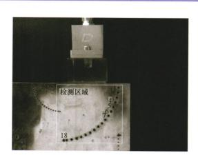
摘要:超声相控阵全聚焦成像算法具有精度高、全范围动态聚焦的优点,但存在的成像耗时长问题限制了其实际工业应用。为提高实际检测中相控阵全聚焦成像效率,以常用的楔块耦合检测为例,基于 Fermat 原理计算两层介质下各阵元的延迟时间,建立两层介质相控阵全聚焦成像算法。通过减少发射/接收阵元数,以与全矩阵下具有一致的有效孔径为条件,研究发射/接收阵元分布的权重函数,建立两层介质修正稀疏全聚焦算法。以弧形分布的侧边孔为例,进行了两层介质的全聚焦成像及稀疏全聚焦成像试验,并讨论了稀疏发射阵列对缺陷定量精度及全聚焦算法计算效率的影响。结果表明:修正稀疏全聚焦算法可在保证成像精度前提下显著提高成像效率。对于 32 阵元换能器,当稀疏发射阵元数达到 8 时,稀疏矩阵相对于全矩阵的误差值在 5.2%以内,但计算效率提高了近 4 倍。
