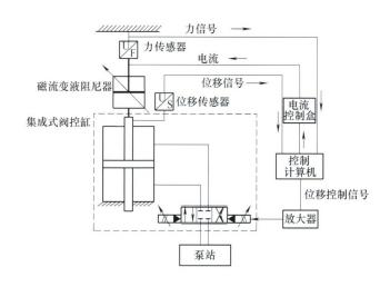
摘要: 针对磁流变液的流变特性, 分别以磁流变液的 Bingham 力学模型、多项式力学模型和 Bingham-多项式 力学模型为理论基础,建立磁流变液阻尼器的力学模型, 并对三种力学模型进行参数辨识,得到准确的数学模型。 搭建一套双通道负载模拟试验台,通过试验研究对比三 种力学模型模拟结果和试验测试结果,评估三种力学模 型的精度和 Runge 振荡现象。研究结果表明, Bingham 力学模型具有结构简单、物理量意义明确和较强的工程 实用性等优点,但缺点是模型精度较差; 六阶以上多项 式力学模型模拟精度较高,但是随着多项式阶数的升高, 模拟曲线的 Runge 振荡现象也越来越严重,而且曲线有 可能失真;提出的 Bingham-多项式力学模型能够同时解 决传统多项式力学模型中低阶曲线精度低和高阶曲线易 振荡的问题,模型的模拟结果和试验测试结果吻合精度 较高。研究结果可为磁流变液阻尼器在振动控制领域中 力学模型的选择提供参考。
