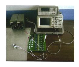
摘要:飞机机身多层铆接结构厚度较大,结构复杂,传统无损检测方法难以用于对其进行外场检测。远场涡流检测技术不受集肤效应的限制,可穿透较大厚度的被测试件,对铆接结构中缺陷的检测具有潜在优势。为在铆接结构中实现远场涡流效应,从信号增强与磁场抑制两方面入手,设计一种新型平板远场涡流传感器。信号增强方面,给激励线圈加装磁路来聚集和引导磁场,从而增强间接耦合磁场;磁场抑制方面,在激励线圈与检测线圈之间加装磁场抑制单元来抑制直接耦合磁场。通过信号增强与磁场抑制的共同作用,从而在铆接结中实现远场涡流效应。围绕传感器设计这个核心,对信号增强单元以及磁场抑制单元的尺寸形状、材料组成进行仿真研究,综合得出最优的传感器设计方案。仿真与试验的结果验证了将远场涡流检测技术应用于铆接结构中缺陷检测的可行性。
