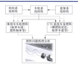
摘要:针对汽车工程中存在的两类摆振问题,车轮摆振和车身摆振,分别描述它们的行为和产生机理,综述国内外对此两类摆振问题的研究的发展历程以及主要的研究成果。摆振现象本质上是较为复杂的非线性动力学行为,针对此问题的研究在理论和实践上都存在很多困难。无论是车轮摆振还是车身摆振,首先它们都是非线性系统自激振荡的表现,其次它们的产生都归因于轮胎接地力对系统做正功,向系统输入的能量恰好能够维持系统摆振行为的产生。同时,包含弹性轮胎的车轮子系统、转向子系统和悬架子系统是影响两种摆振行为的三大关键因素。鉴于摆振问题仍然是汽车动力学领域的研究难点之一以及新型汽车的快速发展,本文也指出了摆振研究目前仍存在的一些问题,并对此类问题的进一步工作进行展望。
