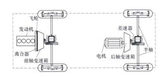
摘要:通过道路并联(Through-the-road parallel, TTRP)混合动力车辆是指将发动机和电动机安装在车辆的不同轴上,通过地面与轮胎间的作用力将动力耦合的混合动力车辆类型。这种类型的混合动力车辆,由于结构的特点在不同的动力模式下存在不同的低频频率特征。车辆的低频纵振是影响车辆舒适性和驾驶性的关键因素之一,因此,车辆的低频纵振必须得到很好的控制。研究这种类型的混合动力车辆在不同动力模式下的特点,针对不同模式建立简化模型,并建立统一的多模型预测控制策略。通过仿真 TTRP 混合动力车辆在多种动力模式下的特定工况,对设计的多模型预测控制策略进行验证。特定的工况包括急踩、松油门(Tip-in, Tip-out),不同的转矩分配等。仿真结果表明所设计的车辆低频纵振主动控制策略能够较好地抑制 TTRP 混合动力车辆在各动力模式下的低频纵振,车辆驾驶性得到了较大的提升。
