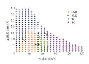
摘要:双电机耦合驱动系统是一种能有效改善电动汽车经济性且提高续驶里程的新型电驱动系统,但该系统结构复杂,存在多种驱动模式,不同模式之间进行切换可能会导致驱动系统输出转矩的突变从而导致整车产生较大的纵向冲击。根据双电机耦合驱动系统的结构特点,重点分析单电机驱动与转矩耦合驱动模式切换过程中各部件的工作状态以及各部件之间的运动学关系,以整车冲击度最小为控制目标,提出一套双电机耦合驱动系统单电机驱动与转矩耦合驱动模式切换控制策略。基于MATLAB\Simulink 仿真平台,搭建双电机耦合驱动系统前向仿真模型,验证了所制定的双电机耦合驱动系统模式切换协调控制策略的有效性,结果表明,所制定的控制策略可实现整车模式切换过程中冲击度小于 2.5 m/s³,且无动力中断。
