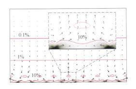
**摘要**:以叉指电极阵列为例,分别建立对称物理场、非对称物理场和行波物理场的有限元模型,求解三种情况物理场下微通道中的电场、流场、温度场和介电泳力的分布,分析交流电热流场的对流与传质过程对流场中微纳粒子介电泳的影响规律和干预方式。结果表明,对称物理场和非对称物理场内部均产生漩涡式扰动,增强了流场的对流与传质,可将处于介电泳有效作用范围之外的微纳粒子输送至电极附近区域,扩展了介电泳的实际有效作用区域。行波叉指电极阵列构建的流场则无明显漩涡,但行波物理场中介电泳力的衰减较慢,电极厚度 60 倍高度处衰减为 10%,显著提高了对微纳粒子的操控和输送能力。
