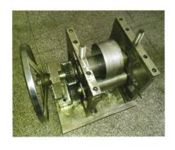
摘要:为揭示对称式三辊矫圆原理,优化矫圆策略,对三辊矫圆工艺进行理论解析和试验研究。基于平面曲梁纯弯曲弹复方程,采用双线性简单随动强化模型,通过数学归纳法建立往复弯曲弹复曲率方程和弹复曲率统一方程。理论解析结果表明:管坯周向不同初始曲率的管壁微段在矫圆加载过程中经历多次往复弯曲湮灭了初始曲率的差异,最终使各管壁微段弹复后曲率统一。通过几何关系,建立上辊压下量、弯曲曲率半径和弹区比的定量关系,进而可实现上辊压下量的预测。三辊矫圆试验验证了对称式三辊矫圆原理。试验结果表明:随着弹区比减小,残余椭圆度逐渐减小,当弹区比接近40%时,残余椭圆度接近0.3%,远小于美国石油管道协会API5L的规定。同时验证了在小变形范围内,残余椭圆度与初始椭圆度关系不大。
