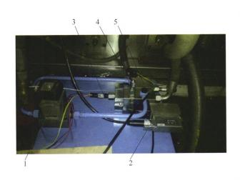
摘要:比例流量阀可根据设定信号连续比例控制执行器的速度或者转速,是重要的电液控制元件,广泛应用于各类电液系统。传统电液比例流量阀为消除负载压力变化对流量的影响,需要采用压差补偿器或流量传感器,增加了阀结构的复杂性和体积,并引起附加的节流损失。针对这些问题,根据Valvistor 阀的流量放大特性,提出基于先导流量压差变化位移校正、主阀流量放大的新型电液比例流量控制原理,该方法根据压力传感器检测的先导阀口压差实时校正先导阀芯位移,并通过主阀线性放大先导阀流量。研究中,建立新型比例流量阀的数学模型,推导得出基于补偿原理的控制策略;进一步建立阀的仿真模型,对比分析补偿前后比例流量阀的静动态特性;设计制造试验样机,通过试验验证了所提原理的可行性。测试结果表明,采用该原理可消除主阀口压差变化对输出流量的影响,动态响应快,特别适用于大流量的电液流量控制。
