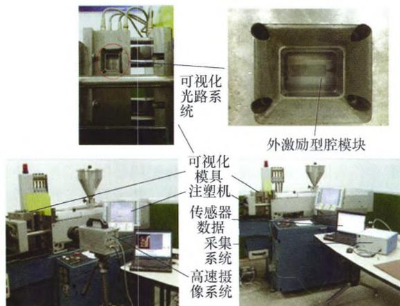
**摘要:** 注塑成型的过程中, 困气现象是制约制件性能的一个关键因素。以带凸台的环形制件的注塑成型过程为研究对象, 通过可视化装置直接观察熔体在型腔内充型流动时困气行为的动态过程, 探究成型参数(熔体温度、模具温度)对困气现象的影响机理。试验结果表明, 在一定的模具温度和熔体温度的范围内, 提高注射速度可以降低困气面积和困气位置距离; 低速注射时, 提高熔体温度或模具温度都可以降低困气面积和困气位置距离; 高速注射时, 随着熔体温度不断上升困气区域的面积和困气距离呈先上升后下降的趋势, 而提高模具温度则会导致困气区域的面积距离不断增大。
