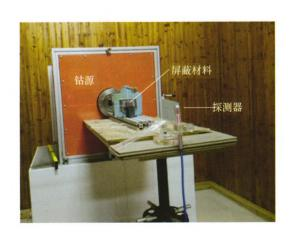
摘要: 为获得具有良好伽马射线屏蔽性能的封装材料,采用蒙特卡罗软件(MCNP4C)进行核电机器人电子器件屏蔽材料设计和屏蔽性能模拟,并分别结合小剂量率单向γ射线和大剂量率各向同性 Co-60 源对所制备的钨/氧化铝复合封装材料的屏蔽性能进行实测。结果表明: 试验值与模拟值相近, MCNP4C 软件可较好地进行材料设计和屏蔽性能评估。另外,随着钨含量的增大,材料的线性衰减系数和屏蔽率都逐渐增大,半衰减厚度值降低。钨添加量为 70%时,材料的综合性能最佳。与商业环氧塑料和氧化铝陶瓷封装材料相比,该复合材料的屏蔽率分别提高了 3.79 倍和 1.13 倍、半衰减厚度减小 7.04 cm 和 2.06 cm,可为机器人电子器件提供较好的防护作用。
