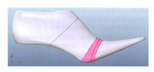
摘要:针对鞋楦数字化设计中对非线性尺寸的约束要求,提出一种基于微分坐标变形的尺寸驱动曲面变形方法,实现围长驱动的楦型设计。基于足-楦尺寸的对应关系修改鞋楦上的非线性尺寸,将围长尺寸变化映射为围线形状的变化,再由变化后的围线形状通过网格变形技术转化为楦型曲面的形状修改。通过迭代计算,可以保证围度曲线长度的精确约束;同时,根据楦型设计规律增加的位置约束和方向约束使变形后的曲面能够继承原有楦型曲面内在的形状特征;拉普拉斯变形拥有的特征保持性特点使变形后的鞋楦仍然保持原有的楦型样式,且其最小二乘意义下的求解框架有利于均布计算误差,使变形更加光顺、自然。试验结果表明,所提方法变形自然,实用性强。
