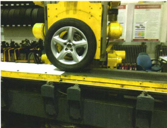
**摘要:** 对接路面轮胎瞬态侧偏特性对于车辆方向稳定性至关重要。通过仿真与试验的手段研究对接路面轮胎瞬态侧偏特性及其机理。建立用于对接路面轮胎瞬态侧偏特性仿真的轮胎模型, 通过考虑胎体复杂弹性变形, 并将印迹区域内胎面单元离散处理, 得到轮胎滚动过程中胎面单元的变形特性, 推导出基于胎面变形的轮胎力和力矩的一般表达式。利用高低附对接路面台架试验数据对模型进行了验证。通过仿真研究对接路面轮胎瞬态侧向力和回正力矩特性, 深入分析对接路面轮胎瞬态侧偏力学特性机理以及轮胎胎体弹性、轮胎侧偏角和摩擦因数阶跃幅值对这一特性的影响。分析结果表明, 胎体侧向平移刚度对侧向力松弛特性影响很显著。胎体平移刚度越大, 侧向力松弛长度越短。研究工作有助于对接路面工况轮胎瞬态特性半经验建模以及车辆在对接路面上的方向稳定性分析和相关控制策略开发。
