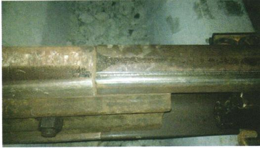
**摘要:** 由于列车的高速化和重载化, 钢轨磨损问题越来越严重, 采用修复质量高、修复速度快的激光熔覆技术可以对其进行在线快速修复。为此, 采用三维扫描仪首先对磨损钢轨进行扫描, 然后将扫描点云数据进行三维重构、路径规划及数据格式转换, 最后利用优化的数据驱动机器人手臂和激光熔覆装置对磨损钢轨进行自动修复。修复工艺结果表明, 对 5 mm 的磨损层进行 7 层修复, 利用修复道与道之间和层与层之间的回火作用, 修复层的组织马氏体含量少, 硬度为 330~360 HV; 经过 600 °C 回火处理 10 min 后, 加入钒元素的铁基合金粉末激光熔覆修复后钢轨母材、热影响区、修复层硬度均在 300~340 HV, 组织为回火索氏体; 修复钢轨的耐磨性约为钢轨母材的 87%, 达到修复目的。
