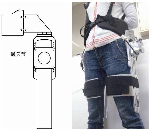
**摘要：**引入生物控制理论改善步行辅助中人机交互柔顺性和多关节协调自律控制的问题，探索一种以中枢模式发生器 (Central pattern generator, CPG) 网络为核心的、具有“对外交流、对内抑制”双重机制的人机交流协调控制方法。建立左右髌关节独立 CPG 单元及其对外交流机制，充分保障左右髌关节处的人机运动交流；建立 CPG 单元间的内部抑制机制维持髌关节间的逆相位，确保复杂多变的人机交互环境下稳定的步行辅助。穿戴式步行试验证明了该方法的有效性。
