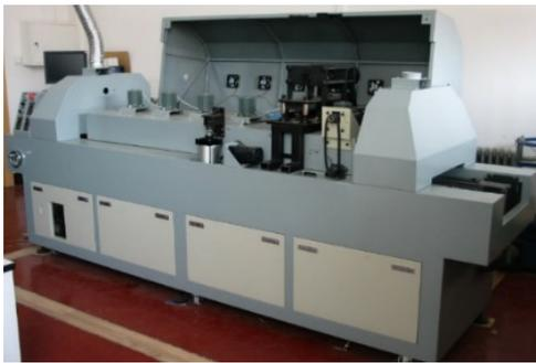
**摘要:** 废弃印刷电路板(Printed circuit boards, PCB)上的元器件具有较高的重用价值, 而元器件的重用是基于合理的线路板拆解工艺的。目前相关研究多关注拆解力的分析和计算, 然而由于拆解时元器件与线路板间存在熔融状态的焊料, 即便提供足够大的拆解力也难以保证元器件被拆解。在基于已建立的拆解力模型, 提出综合考虑拆解力和元器件分离位移的拆解能作为拆解准则, 并基于这一准则研究了垂直振动激励下元器件的拆解分离过程, 分析了废弃线路板在对边简支对边自由的边界条件下强迫振动的模态, 基于薄板振动理论建立 PCB 的运动微分方程, 获得 PCB 的加速度及位移响应; 分析了垂直振动拆解中贴片元器件和插装元器件的不同分离过程, 并且采用拆解能模型对不同拆解激振频率、位于线路板不同位置、具有不同最小拆解加速度的元器件进行拆解分析; 提出以拆解能图来比较元器件实际获得的拆解能与所需的最小拆解能, 为拆解工艺参数的确定提供依据。最后在试验中验证拆解能模型的正确性。
