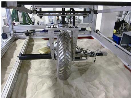
**摘要:** 载人月球探测是无人月球探测的必然发展趋势,载人月球车是载人月球探测中必不可少的探测工具和手段。宇航员驾驶载人月球车进行月面探测任务,在进行转向行驶时,车轮实际速度方向与滚动方向不一致,此时土壤对车轮产生侧向力的作用。载人月球车车轮运行在月球真空、大温差、松软月面土壤的恶劣条件下,与传统地面橡胶车轮不同,采用弹性筛网形式的车轮。基于一般刚性车轮的侧向力模型,引入三个应力修正系数,其中包括两个侧向附着力计算的应力修正系数和一个侧向推土力计算的应力修正系数。通过推导得到载人月球车弹性筛网车轮的侧向力数学模型,利用参数辨识得到应力修正系数的求解公式。对比理论修正模型与试验结果,验证了载人月球车弹性筛网轮侧向力理论模型的准确性。
