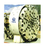
摘要:滚刀的磨损消耗是全断面岩石隧道捆进机(Tunnel boring machines, TBM)掘进成本的重要组成部分。针对于此,基于中国秦岭和挪威 Røssåga 硬岩隧道的实际工程数据,使用能量分析的方法对滚刀磨损进行了分析研究。提出了滚刀刃单位磨损功和等效磨损函数,通过分析刀盘上不同区域滚刀的运动、受力和磨损机制,建立了基于各刀位滚刀破岩载荷、滚刀安装参数和 TBM 掘进参数的滚刀刃单位磨损功计算公式。通过求解 8.8 m 和 7.23 m 直径 TBM 的等效磨损函数,并计算相应的滚刀刃单位磨损功,对比分析了不同刀盘、不同地质条件和不同刀盘区域的滚刀磨损,发现:等效磨损函数与滚刀寿命系数(CLI)成反比,等效磨损函数的对称轴位置取决于滚刀布局,对称轴位置的滚刀破岩和磨损状态最理想。揭示了刀盘内侧和外侧区域滚刀高磨损率的原因,提出了增大刀盘内侧滚刀间距、增大 30°~40°倾角的边滚刀数目的滚刀布局建议。
