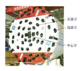
**搞要**: 裂纹是造成 TBM 刀盘失效的主要原因,由于 TBM 刀盘本身体积庞大,受力情况复杂等原因,导致 TBM 刀盘不同部位的裂纹扩展情况不同,加上无法准确预估裂纹的位置,进而无法准确地计算 TBM 刀盘疲劳寿命。针对这种情况本文提出一套基于 TBM 刀盘裂纹失效区域划分的 TBM 刀盘裂纹位置预估与分析方法。结合受力及结构形式的不同划分刀盘易发生裂纹的危险区域,根据实际掘进情况,将 TBM 刀盘掘进过程分为四种工况,分析总结各个工况下 TBM 刀盘的应力分布,结合裂纹失效统计结果,预估 TBM 刀盘 裂纹位置,根据裂纹失效区域划分的结果统计预估裂纹位置所在区域,以此作为依据分析计算 TBM 刀盘疲劳寿命裂纹所需参数,以吉林引淞 TBM 刀盘为例,刀盘易发生裂纹的部位可划分为 10 个区域,根据计算显示中心块面板,支撑筋与面板连接处、中心刀、边滚刀刀座焊接处、出渣槽等位置为裂纹易出现的位置,结合分区结果计算各区域应力幅值,为后期计算 TBM 刀盘疲劳寿命奠定基础。
