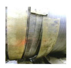
摘要: 为分析硬岩掘进机的撑靴液压缸在强振动工作环境下内衬铜套断裂的损伤机理,建立考虑撑靴与围岩接触刚度、缸筒和活塞杆接触面处等效刚度和液压油等效刚度的撑靴液压缸系统的集中参数动力学模型。研究不同支撑刚度条件下,撑靴液压缸导向套和内衬铜套接触面的法向力、切向力、法向压缩量和切向滑移量的变化规律。基于 Hertz 理论,分析掘进机在不确定地质条件下掘进时导向套与内衬铜套界面之间的接触载荷分布规律。根据连续介质损伤力学建立了内衬铜套结构含损伤材料本构模型,以液压缸动力学模型得到不同接触刚度下的内衬铜套接触面处的微动载荷为初始条件,分析了撑靴液压缸的内衬铜套的损伤演化规律。结果表明随着支撑刚度的增大,切向力和切向滑移减小,损伤的萌生和演化速率降低。适当提高围岩和撑靴之间的接触刚度,降低撑靴液压缸导向铜套的损伤概率。
