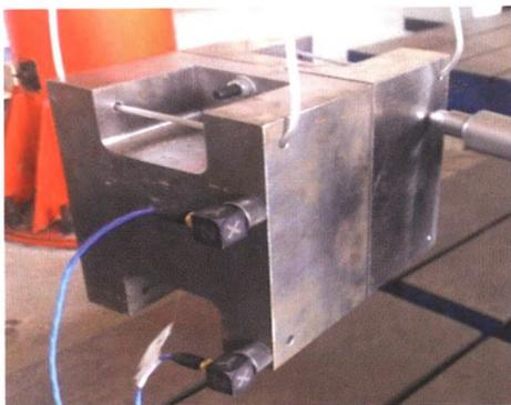
**摘要:** 螺栓连接是应用最广泛的装配形式之一, 表征栓接结合部连接参数是进行装配体结构动力学分析的关键, 针对各向同性虚拟材料模型不能准确表征结合面压力分布不均匀性的问题, 提出并开发一种基于梯度虚拟材料的栓接结合面连接参数表征模型。首先根据结合面压力分布特征, 以及结合面法向、切向刚度与压力分布间的映射关系, 建立了等效虚拟材料参数随位置坐标的变化规律模型; 分别采用等参梯度单元和高斯积分点属性梯度分布单元等效表征结合部连接参数, 采用结构静力学、动力学分析方法进行分析, 通过对比不同类型单元静力学、动力学计算结果, 验证梯度材料单元的准确性; 进而研究了基于代理模型的梯度虚拟材料参数辨识方法, 采用拉丁超立方采样来获取样本点, 采用 Kriging 模型拟合连接参数, 应用遗传算法优化虚拟材料参数。采用均匀虚拟材料模型、各向异性虚拟材料模型及梯度虚拟材料模型的仿真结果与试验数据对比, 表明梯度虚拟材料模型是一种表征栓接结合部压力/刚度分布特性的有效方法。
