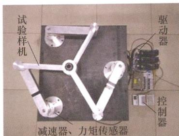
**摘要:** 以平面 2-DOF 冗余驱动并联机器人为研究对象, 结合拉格朗日方程和键合图两种方法, 建立了该机器人机电耦合多能域系统动力学模型。针对该机构特点, 提出了一种将动力学模型线性化的待定系数法, 通过该方法, 经过严密的数学推导, 得到了机电耦合多能域系统动力学模型的线性化形式, 避免了传统的简化方法得到动力学模型线性化形式带来的误差。以五次多项式改进的傅里叶级数优化并联机构末端激励轨迹。搭建了动力学参数辨识试验平台, 以加权最小二乘法对其机电耦合多能域系统的动力学参数进行了基于试验的辨识研究。所提的辨识策略不仅可以辨识出机器人机构本体的惯性参数与关节摩擦参数而且还可以辨识出电动机和减速机的等效转动惯量以及等效阻尼系数。设计了基于计算力矩的力位混合控制策略, 并将辨识出的动力学参数应用到控制策略中, 通过试验验证了机电耦合多能域系统动力学参数辨识的实用性与基于计算力矩的力位混合控制策略的有效性。
