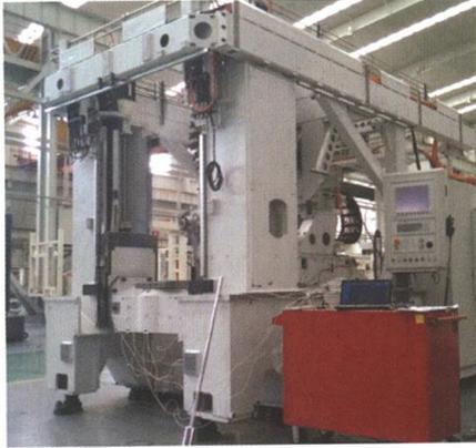
**摘要:** 传统精度设计仅考虑零部件几何公差的影响, 未涉及装配载荷作用下零部件变形的影响。为了保证机械系统在工作过程中的可靠性与稳定性, 不仅要求在产品设计与制造环节中要严格保证零部件具有良好的设计性能与制造质量, 更重要的是保证装配过程中各零部件间的配合性能。以具体的卧式加工中心为例, 通过有限元法获取零部件载荷效应下的变形数据信息, 结合小位移旋量理论、齐次坐标变换理论及表面认证思想, 建立零件载荷变形偏差的综合三维数学模型。分析结果表明: 装配载荷作用下的零件变形偏差总体上呈现出传递和累积的趋势, 系统末端变形偏差累积量达到 $-0.0249\text{ mm}$ 。因此, 零件载荷变形偏差对机械系统精度的影响不容忽视, 设计阶段的三维公差分析应该综合考虑尺寸、形位公差及载荷作用下的变形偏差对机械系统装配精度的影响, 才能形成一种面向整机精度的协调与保障机制, 为提高复杂精密机械系统的整机性能提供理论与技术支持。
