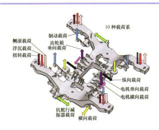
**摘要**:通过测力构架法进行转向架构架载荷识别的精度较高,但其制作程序复杂,成本较高,而且在某些情况下不具备制作和使用测力构架的先决条件。因此,提出在仅有关键测点的动应力数据和载荷-应力传递关系的条件下进行构架载荷识别的方法。这种情况下载荷-应力传递系数矩阵往往是病态矩阵,会影响载荷识别的精度。从病态矩阵的实质出发,详细分析了病态矩阵误差的来源和截断奇异值法控制误差的原理。采用截断奇异值法将某型动车组的动应力数据和载荷-应力传递关系矩阵进行载荷识别,并将得到的载荷与利用测力构架法获取的实测载荷进行对比。识别载荷在幅值、相位,以及等效载荷幅值上都与实测载荷接近。结果表明采用截断奇异值法可以较好的识别浮沉、扭转、侧滚、抗蛇形、齿轮箱、制动载荷,具有一定的工程意义。
