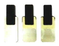
摘要: 铝塑复合构件具有强度高、质量小、易成型复杂结构等优点,在航天、能源、汽车、通信等领域的应用逐渐广泛。提出采用注射方法直接成型铝-塑复合构件的方法,采用阳极氧化对铝合金表面进行处理,获取金属表面的纳米级微结构形态。为提高金属与聚合物之间的界面作用,将阳极氧化的金属表面进行活化处理,X 射线能谱分析仪(X-ray photoelectron spectroscopy, XPS)对处理后的表面微结构进行形态和成分表征,探讨活化处理后铝合金表面组织成分的变化,并优化获得了最佳的处理时间。对表面处理完成的铝合金试样置入高温模具中进行注塑成型,成功获得了铝-塑复合构件。采用激光共焦扫描显微镜(Laser scanning confocal microscopy, LSCM)和扫描电子显微镜(Scanning electron microscope, SEM)分析拉伸剪切断裂后金属表面的界面形态,讨论了铝塑复合件的失效原因和机理,为金-塑复合产品的生产成型提供了理论基础。
