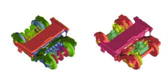
**摘要**:为研究高速列车转向架区域的气动性能及流场规律,建立列车空气动力学模型,基于 SST  $k-\omega$ 两方程模型对运行速度分别为 250 km/h、300 km/h 和 350 km/h 的高速列车气动性能进行了数值模拟,分析动车及拖车转向架各部件对列车气动性能的影响。计算结果表明:列车运行速度对转向架阻力的影响是显著的,其中对头车转向架影响最大;头车转向架的阻力占总转向架阻力的 54.9%,其中构架和轮对分别占 35.6%和 46.5%,部分部件由于前后压差形成负阻力;拖车转向架的流场结构比动车转向架更加复杂,闸片等部件对转向架区域的流场结构有显著影响;转向架区域外形和设备舱隔墙倾角也会影响其流场结构,斜角入口比直角入口的流场结构更加复杂。
