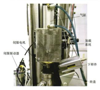
摘要:针对气动加载系统压力跟踪控制中强非线性、强耦合性、模型不精确性等问题,提出一种线性/非线性自抗扰切换控制器,该控制器结合了线性自抗扰控制器多数整定简便、理论分析简单和非线性自抗扰控制器跟踪精度高、响应快的优点,设计线性/非线性切换扩张状态观测器对系统的耦合项以及不同幅值的扰动等不确定项进行估计,并采用切换状态误差反馈控制律给予实时主动补偿,进而实现系统加载压力的实时控制,并完成了线性/非线性切换扩张状态观测器的收敛性证明。最后,在气动变载荷摩擦磨损试验机试验平台上进行试验验证,与线性自抗扰和非线性自抗扰进行对比,试验结果表明,改进的控制器具有抗干扰性强、跟踪精度高、应用性强等特点。
