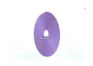
摘要:提出一种基于微流体芯片的新型油液多污染物区分检测方法,该方法设计的传感器由一个直通道微流体芯片以及嵌入芯片中的两个相同的单层线圈组成,不仅从电感原理对船舶液压油中的铁磁性和非铁磁性金属颗粒进行区分检测,也能从电容原理对油液中的水滴和气泡进行区分检测。相较于传统单线圈电感传感器,该双线圈传感器不仅能够检测多种参数,而且具有更高的分辨率。从检测原理对该方法进行了仿真及分析,然后用该传感器搭建检测系统对油液中的多种污染物进行检测试验,在试验中成功检测到了油液中40μm的铁颗粒和110μm的铜颗粒;作为电容传感器时能够检测100μm的水滴和180μm的气泡。该研究对船机油液污染物的快速区分检测提供了技术支持,这对于船舶机械系统的故障预防与诊断具有重要意义。
