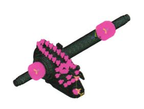
摘要:通过台架试验识别出高速列车齿轮箱装配状态下箱体的模态参数。试验中齿轮箱装配于实际的轮对系统并且模拟齿轮箱在转向架构架上的实际约束。采用多频带平稳随机激励,运用 PolyMAX 方法完成齿轮箱箱体前六阶模态参数(包括模态频率、阻尼比、振型)的识别,对比试验结果与仿真计算,两者相一致,表明参数识别可靠。对于模态参数识别过程中出现的虚假模态,通过在不同激励点的锤击试验获得轴、齿轮箱、轴箱等部件的响应,分析轴-齿轮箱、轴箱-齿轮箱、轴-轴箱等子系统之间的传递函数,确定虚假模态主要振动来源并探究车轴、轴箱等零部件对台架试验中齿轮箱箱体振动响应的影响。采用连续小波变换和奇异值分解相结合的方法弱化能量值较低的虚假模态,进一步提高箱体在位模态参数识别的准确性。
