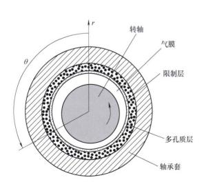
摘要:多孔质气体轴承越来越多地应用在超高速、超精密的旋转设备中。当轴承在高速重载的环境下工作时,气膜的温升会对轴承性能产生很大的影响。对含有限制层的多孔质静压气体轴承的温度特性进行研究,通过求解雷诺方程得到轴承气压分布,结合能量方程和热传导方程预测轴承的温度场分布。计算结果表明,转轴在高速转动时,气膜会产生较大的温升;当载荷越大、转速越高、轴承间隙越小时,气膜的温度越高;轴承间隙较小时,其最高气膜温度随载荷的增加变化较小。相比于载荷对温升的影响,转速对温升的影响更为明显。同时温升易使转轴产生热膨胀,且热膨胀量随转轴壁厚的增加而增加。与不考虑转轴的热膨胀变形相比,考虑转轴的热膨胀变形时,最小气膜厚度变小,最大气膜压力变大。
