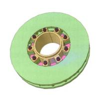
摘要:制动盘螺栓紧固结构的完整性对于保证良好的制动性能至关重要。通过建立热-机耦合有限元分析模型,研究列车在长大下坡持续制动过程中轴装制动盘螺栓的载荷演化规律。结果表明,在制动表面产生的热量向制动盘内部及其他连接结构传递的过程中,制动盘中的温度梯度是导致螺栓载荷出现变化的主导因素。螺栓的轴向拉伸载荷出现先下降后反弹的演化规律,不均匀的温度场使螺栓内部出现弯曲载荷,且螺栓的周向弯曲载荷明显大于径向弯曲载荷。对流换热系数的增加可以减小螺栓轴向拉伸载荷和弯矩的变化,但当对流换热系数增加到一定值时,这种影响逐步减小。螺栓与周围结构热膨胀系数的差异会加剧螺栓载荷的变化,可能会导致螺栓自松的风险增加或者螺栓弯曲失效。螺栓预紧力对螺栓弯矩变化没有影响,而对螺栓轴力变化有一定的影响。
