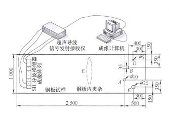
摘要: 为探讨接收孔径对超声导波合成孔径阵列成像检测的 影响机制,提出将接收矩阵作为分析工具对超声导波合成孔 径阵列成像原理展开研究。针对板中超声水平剪切(Shear horizontal, SH)导波直线合成孔径阵列,运用波幅接收矩阵 和渡越时间接收矩阵对接收孔径进行讨论,分析直线阵列信 号所特有的圆锥曲线特征和合成孔径成像算法,重点就满秩 接收孔径、半(满)秩接收孔径和单(位)秩接收孔径对超声导 波合成孔径阵列成像检测的影响机理进行研究。研究结果显 示,波幅接收矩阵和渡越时间接收矩阵具有相同的秩,与接 收阵元数成正比关系, 秩的大小决定阵列成像的信噪比, 阵 列图像信噪比随秩单调递增; 半秩接收孔径图像与满秩接收 孔径图像信噪比较为接近,单秩接收孔径图像的信噪最小, 图像背景噪声最为强烈。成像试验验证了理论分析的合理 性,表明接收矩阵是研究超声导波合成孔径阵列成像的有力 工具,接收矩阵的秩是接收孔径对阵列成像检测的结决定性 影响因素,论文研究工作可为深入开展超声导波非规则阵列 成像检测研究与应用提供基础。
