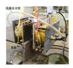
摘要:为了揭示外加横向磁场对电弧增材成形过程中电弧和熔池传热传质以及成形件微观组织影响的内在机理,建立基于 GMAW 电弧增材成形过程中电弧和熔池的弱耦合数值模型,通过数值模拟对比分析了有/无外加横向磁场作用下熔池电磁力分布、电弧和熔池传热传质的差异,发现横向磁场作用使电弧向熔池后方偏转,使熔池发生单向强制对流并驱动熔融金属和热量向熔池后方运动,从而更加直接地冲刷熔池结晶面。由此预测横向磁场作用能降低熔池凝固过程中枝晶前沿温度梯度和溶质浓度,提高枝晶前沿的成分过冷,使得靠近熔池中心的枝晶前端生长加速并细化晶粒。相同工艺条件的对比试验表明:相比无外加磁场的普通熔积,横向磁场作用下熔池底部等轴晶区域减小,整个结晶面上细密的胞状枝晶区域面积增大,验证了数值模拟的预测。研究结果可为外加磁场在电弧增材成形微观组织控制中的应用提供依据和参考。
