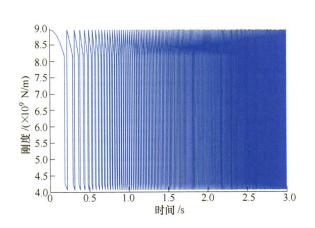
摘要:城轨列车实际运行工况是变速载的,传统的定常转速齿轮研究不能满足动态特性分析的需要。为此,提出一种新的时变速载齿轮系统动态特性研究方法。综合考虑时变啮合刚度、时变外部激励、静态传递误差、随机位移激励以及非线性侧隙的影响,建立城轨列车时变速载齿轮系统扭振模型。通过分析直齿轮啮合过程,修正齿轮啮合频率计算公式。基于微元法思想,计算城轨列车惰行工况、牵引工况和制动工况的速度、转速以及转角,得到时变啮合刚度的变化规律。研究结果揭示牵引工况的齿轮扭振运动在这三种运行工况中的扭振功率密度最低。在惰行工况下,齿轮系统低速运行呈现分频的现象,高速运行有陷入混沌运动的趋势;在牵引工况下,齿轮系统随转速的提高稳定性有所下降;在制动工况下,齿轮系统随转速的提高稳定性有所下降;在制动工况下,齿轮系统的扭振不显示含啮合频率的影响。
