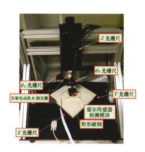
摘要:利用矩形永磁体自身有规律分布的磁场信息,提出一种使用霍尔传感器阵列作为传感检测模块的非线性计算测量方案。该方法可实现空间六自由度的微位移精密测量,并能保证测量轴间的严格数学正交特性。此方案利用矩形永磁体分布磁场与空间位置间的对应关系,建立永磁体的磁感应强度空间分布数学关系 B(X),作为测量模型,并设计均匀布置的霍尔传感器阵列检测空间磁感应强度 B。然后,基于运动连续性原理,采用顺序求解法对测量模型 B(X)进行快速解算。通过高斯白噪声条件下的 500 次蒙特卡洛仿真验证了此方案的可行性。试验结果表明,在微位移 10 mm 测量范围内,XY 平动测量误差标准差小于 80 μm, Z 向 2 mm 垂直位移范围内测量误差标准差小于 10 μm,转动π/6 范围内测量误差标准差小于 5 mrad。
