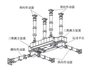
摘要:为实现转向架二系悬挂静动刚度的测试,提出针对整备状态转向架二系悬挂三向动、静态刚度进行单独测定试验方法,建立二系空簧动、静刚度测试模型,根据模型分析二系空簧动、静刚度与所受载荷和形变的关系。利用转向架参数试验台对某型号地铁拖车转向架二系悬挂的动、静刚度进行测定试验,计算出系统的测试重复性误差为 0.58%,测试重复性较好。根据试验数据得到横向止挡特性曲线与橡胶材料特性相符合,1#二系空簧纵向静态刚度试验值与设计值误差达到 18.1%,并且 1#二系空簧纵向动态刚度在 5 Hz 左右有一个快速增加的波峰。基于试验结果,推测是由于 1#空簧质量或者装配尺寸不符合要求造成了 1#二系空簧纵向刚度的异常变化,应对 1#二系空簧的装配关系进行调校,可根据测试结果对转向架二系悬挂参数及装配关系进行优化。
