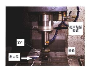
255 超声复合电加工在线参数测控及优化试验
