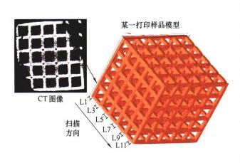
摘要:针对 SLS 快速成型产生的结构内部缺陷问题,利用检 测与统计手段建立基于试验数据的仿真预测。对同一多孔结 构的 CAD 模型,提出了设置两种打印方向进行多次成型制 备,通过 CT 分层扫描技术,对 3D 打印结构进行微结构检 测,可以发现微结构中存在缺口、翘曲、孔洞为主的缺陷, 其几何方向与打印方向具有一致性。利用三维图像重建模型 技术,统计微结构缺陷的几何参数概率分布,研究 SLS 打印 工艺参数对缺陷几何参数统计规律的影响,发现样品放置方 向设置为 45° 时容易引起结构发生翘曲,设置为 0° 时孔洞 容易形成。基于统计建立具有随机缺陷的数值仿真模型,分 析随机缺陷引起力学宏观刚度和渗透率、微观应力的性能误 差,结果表明随机缺陷使结构刚度变小,使得最大微观应力 变动非常大。通过压缩试验验证了宏观刚度数值模拟结果。 本研究中关于 SLS 几何缺陷的统计数据也适用于其他多孔 结构的分析和数值计算,对研究 SLS 打印工艺引起微结构缺 陷,及评估对力学性能影响具有重要价值。
