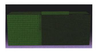
摘要: 在多功能摩擦磨损试验机上模拟微创手术中的组织夹 持牵引操作,研究了钳头与猪肝脏组织间的摩擦学行为,并 基于钳头与组织间的夹持应力分布数值模拟结果,探讨了不 同的腹腔镜开窗钳头与肝脏组织的相互作用行为。结果表 明: 在接触系数相同的情况下, 开窗数量的增加有助于增大 滑动摩擦力; 三正方形开窗钳头由于开窗轮廓最长, 在与组 织相互作用过程中,使组织在轮廓边缘产生了更多的变形, 有利于嵌入组织,与肝脏组织之间产生的能量耗散及滑动摩 擦力最大,夹持稳定性最好;对于相同类型的矩形开窗钳头, 接触系数存在一个阈值,当接触系数小于该阈值时,随着接 触系数的减小,摩擦力减小,夹持稳定性会降低;钳头与肝 脏组织接触过程中,较大的接触应力集中在钳头端部边缘和 开窗轮廓边缘与肝脏组织接触处。
