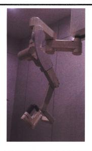
摘要:采用拉格朗日方程和 Stribeck 摩擦模型,根据便携式手术机器人主手的杆件重力、各关节摩擦力、惯性力对术者真实力感知的影响,建立了含关节摩擦力的动力学模型。基于机器人主手动力学模型,分别建立重力、摩擦力和惯性力三项的补偿模型,通过分析机器人主手力补偿反馈和附加位移的产生原因及补偿原理,提出了相应的补偿反馈力和附加位移补偿方法。通过对初步研究结果进行对比试验,验证该力补偿控制方法可用以平衡主手因自身所带的重力、关节摩擦力和惯性力产生的影响,最终实现术者真实的力感知,提高手术操作精准性。
