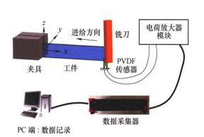
摘要: 薄壁件的弱刚性导致其在加工过程当中容易产生振动,而薄壁件加工过程中存在的非线性问题使得加工振动难以预测,尚无法建立精确的理论模型。为了研究薄壁件铣削加工过程中的振动,提出一种基于模态理论的悬臂梁工件的动态振动监测模型,利用 N 个动态位移传感器监测前 N 阶模态下悬臂梁上任意一点的振动。以铣削加工悬臂薄板为例,采用聚偏氟乙烯(Polyvinylidene fluoride, PVDF)薄膜传感器在线监测了铣削过程中工件的振动位移。工件振动位移信号的时频域分析结果表明,PVDF 薄膜传感器能够有效监测薄壁件加工过程中周期谐振信号和高频振动信号,其中高频振动易发生在切入、切出阶段,且频率多分散在周期性切削激励倍频附近。最后,只考虑工件一阶模态,计算得到刀具在工件上动态作用点处工件的振动位移,并与工件变形引起的让刀量对比,验证了该方法的有效性。
