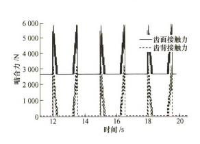
摘要:在舰船摇摆作用下,利用拉格朗日方程建立滑动轴承-齿轮副系统动力学模型。模型中引入非线性油膜力,将齿面、齿背侧啮合力同时考虑。计算了不同输入转速、扭矩作用下齿轮轴静平衡位置,及船体纵横摇摆下齿轮副的振动响应。为研究齿轮副相对于摇心偏置位置的影响作用,计算了不同偏置位置下系统的位移、啮合力及油膜力变化情况,发现随着偏置距离的增加,齿轮的振动响应、轴承油膜力幅值明显增大,油膜力方向大范围波动。此外观察了较小齿侧间隙下摇摆引起的挤齿现象,发现挤齿现象可仅在一侧偏置方向上发生。从齿轮及轴承安全性角度,为舰船设计中齿轮箱布置位置提供理论参考。
