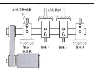
摘要:滚动轴承微弱故障信号往往包含在二阶循环平稳信号中,但容易受到噪声干扰。对循环平稳信号进行基于短时傅里叶变换的循环周期谱分析可以提高周期故障的识别能力,但其结果受到窗函数大小的影响且对于微弱故障的诊断效果不佳,提出最优小波尺度循环谱进行滚动轴承的早期故障诊断。首先利用连续小波变换对信号进行处理获得小波系数;接着采用相关峭度方法选择最优的分析尺度;然后沿着时间轴对该尺度范围内的小波系数进行循环谱分析;最后对最优尺度下的循环谱平均进行特征提取。与循环周期谱的分析结果进行对比,验证了该方法在早期故障特征提取方面的有效性。
