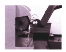
摘要:由于砂带打磨工序中往往存在外部因素干扰,因此研究抗干扰能力强的手眼标定算法是机器人砂带打磨系统的关键问题之一。通过分析机器人打磨系统中的手眼标定数学模型,并利用带尖点的标定工具快速获取测量数据,在原有奇异值分解算法的基础上,提出基于加权的改进方案,在初次计算手眼关系后计算出各个测量数据的误差,并根据测量数据误差的大小重新分配其对应的权重,最后重新计算手眼关系。通过仿真测试可知,改进后的算法较原有算法对测量数据的误差敏感度降低,标定精度稳定性好。通过试验验证可知,改进后的算法较原有算法平均标定误差比 SVD 算法减少了 45.9%,最大误差减少了 24.4%,从而验证了改进算法的抗干扰性能,并通过实际打磨测试证实了改进算法更适用于机器人打磨系统手眼标定。
