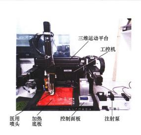
摘要:将 3D 打印技术应用于电活性聚合物材料—离子凝胶材料,采用离子凝胶的材料热压工艺所用的溶液配置方法,重点研究了在不同流量、不同扫描速度组合下,离子凝胶芯层与电极层单点成线、线拼成面后特征尺寸分布规律。实验结果表明:挤出流量的和扫描速度影响单点成线的线宽数值大小,进而影响线拼成面的单层质量。在得到单层质量最佳工艺参数及单层层厚参数的基础上,以圆柱环为例,通过多层叠加打印了厚度为 0.5 mm 的离子凝胶立体结构,给该结构的测点该施加 500 mN 的压力,该结构上下表面可产生 0.35 mV 的电压;采用复合打印技术制造出了离子凝胶的三明治结构,将打印出来的离子凝胶试件在 3.5 V 的直流电压下驱动,该试件末端 18 s 内可以发生 1.5 mm 的变形,传感驱动性能测试结果证明离子凝胶三维打印工艺可行,从而为后续该材料的复杂结构制造以及在软体机器人中的应用奠定基础。
