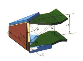
**摘要**: 微创手术操作器械,作为微创手术机器人的重要组成部分,其性能的优劣直接影响手术的质量。目前的微创手术器械大多是针对手术过程中的夹取、缝合等基本操作设计的,但由于它们通常是通过简单地将传统外科手术工具小型化获得的,造成现有微创器械普遍存在着机械效益低、磨损严重、运动不协调等问题。为了提高手术操作的高效性和稳定性,基于厚板折纸理论设计了一种专门用于微创手术的新型手术钳,分析与试验表明其可提供多于传统微创手术钳1.5 倍的夹持力,并具有更大的张角和更好的运动协调性,同时增加了手术操作的灵活性。动物试验表明其夹持组织更加稳定可靠。
