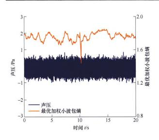
摘要:颤振是切削加工中的一种不稳定现象,它会对生产效率、加工表面和机床零部件造成恶劣的影响。因此,在加工过程中避免颤振的发生具有非常重要的意义。提出一种颤振的实时辨识与在线抑制系统,在不额外加装驱动部件的情况下,实现数控机床上加工颤振的智能抑制。该加工颤振智能抑振系统包括三部分:第一,以加权小波包熵作为特征实时地监测车削加工过程,并在颤振开始孕育时就将其辨识出来;第二,一旦检测到颤振,采用基于尺度因子的插值傅里叶算法,将颤振频率实时估计出来;第三,根据颤振频率,计算出主轴转速扰动的幅值和频率,使主轴转速按照指定的幅值和频率周期性变化,及时地将颤振抑制在其孕育阶段。通过薄壁圆盘端面车削试验对该系统进行验证,结果表明,所提颤振实时辨识与在线抑制系统能在颤振的孕育阶段,成功地将颤振检测出来,并及时进行抑制,实现了智能化的颤振抑制。
