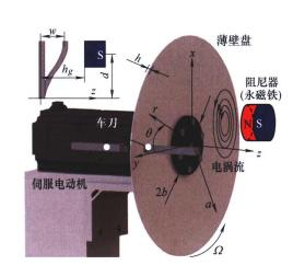
摘要: 薄壁零件具有质量轻、相对强度高等优良特性, 在 航空航天等领域有着广泛应用; 然而由于刚度小, 薄壁工 件在加工过程中容易发生变形和振动,导致产品难以满足 尺寸精度和表面质量要求。为此,提出一种非接触式的电 涡流阻尼器设计方法,旨在用于抑制加工过程中薄壁盘类 工件的多模态振动。通过建立薄壁盘-电涡流阻尼器的耦 合动力学模型,描述时空分布的系统惯量、刚度和阻尼; 通过物理模型的模态降维和局部线性化,获得电涡流阻尼 和薄壁盘振动位移的线性关系式。利用数值计算,分析电 涡流在盘面分布的有效范围,揭示永磁铁的尺寸和位置对 电涡流阻尼的影响规律,并提出永磁铁的优化布置方案, 仿真分析薄壁盘-阻尼器的耦合动力学行为,为电涡流阻 尼器的设计提供依据。最后,理论模型和仿真分析结果通 过薄壁盘-阻尼器耦合的阶跃振动和车削加工试验验证; 试验结果表明,电涡流阻尼器对薄壁盘振动有较好的抑制 作用,在薄壁件加工减振应用中提供一种简单可行的有效 方案。
