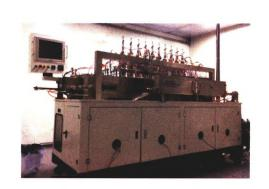
摘要:随着光学电子设备在航天航空、仪器仪表和消费电子等领域的广泛应用,其显示屏及装饰面板的设计形式多样,且 3D 曲面玻璃更是一种潮流。因此,热压成型就成为量大面广的曲面玻璃制造的核心技术。针对精密成型设备的温度分布与控制及其压力控制等问题,开展精密热压成型关键技术研究,建立多工位成型工艺的仿真模型和加热板传热模型,模拟了玻璃在成型过程中温度变化历程以及加热板表面的温度分布,优化设计出一种新型蛇管式加热管;并研制了精密温控系统和精密压力控制系统,测试结果表明,该温控系统精度在±2 ℃以内,压力控制响应精度为 0.001 MPa,能满足热压成型的要求。开发了多工位精密热压成型样机,建立一套可靠的工艺流程,并利用该样机开展了曲面玻璃的热压工艺试验研究。试验结果表明:压型温度为 800 ℃,压力为 0.6 MPa 时,可实现成型玻璃轮廓度<0.010 mm,表面粗糙度  $R_a$ <0.02  $\mu$ m,良品率达 90%以上。
