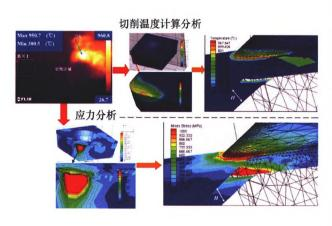
摘要:为研究钛合金已加工表面相变机理及其影响因素,首先通过分析切削过程中切削刃对切削区域的作用机制,采用能量法建立结构参数、切削三要素与切削耗能的数值描述模型,结合 Matlab 对模型进行求解,获知进给量f的变化对钛合金切削耗能 W 的影响最大,切削速度  $v_c$  次之,而切削深度  $a_p$  最小;为验证描述模型的正确性,采用 2 种不同几何结构不同牌号的硬质合金可转位刀片对典型钛合金 TC1、TC4、TA5 以及合金钢 30CrMnSiA 在正常空冷和氩气冷环境下进行对比试验,试验结果与描述模型间的误差较小,有效证明了描述模型的正确性,同时明确了钛合金已加工表面相变形成机理,并揭示了其发展的规律性。研究可为钛合金的高品质加工提供数据支撑。
