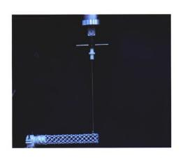
摘要: 自然腔道手术(Natural orifice transluminal endoscopic surgery, NOTES)具有恢复快、创伤小、疼痛轻等优点,在临床应用潜力巨大。为适应人体复杂腔道环境,NOTES中常采用长器械臂为手术工具提供通路及支撑。现有的器械臂往往尺寸较大且刚度低,不能满足 NOTES 的要求。提出一种可折展、变刚度的器械臂,采用编织结构作为骨架实现径向折展,同时借助包覆在编织结构交叉点处的热熔胶实现刚度调节。建立了器械臂的数学模型,得到了柔态和刚态下的刚度解析表达式。试验结果表明,通过加热及冷却热熔胶,器械臂可以实现刚柔两态转化,其刚度比接近 20,并且转换时间小于 30 s,同时可以实现约 2 倍的径向展开比。
