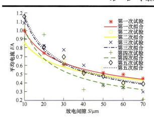
摘要: 电火花线切割半导体加工过程中,工件与钼丝之间的间隙是保证工件表面质量和切割效率的关键参数。分析了单晶硅和钼丝之间的间隙与极间电流的关系,由于该间隙在钼丝切入工件后,无法实时测量,根据电流的变化来实时预估间隙的瞬时变化,从而实时调整工件进给速度以间接保证该间隙。采用系统辨识方法建立极间电流与工件进给速度的控制模型,并利用F检验法估计模型的阶次,选择遗忘因子递推最小二乘在线预估模型参数。设计最小方差自校正控制器对切割过程进行实时控制。试验结果表明所设计的控制器增强了加工系统的稳定性,在保证加工效率的前提下,工件表面有了明显提高。
