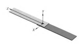
摘要: 压印连接是近年来新兴的连接方式,因其具有简单高效、低耗环保等优点,使得在应用连接方面越来越受到重视。疲劳破坏是机械构件失效的主要形式,疲劳过程中的微动磨损是造成零部件失效的主要原因之一。基于以上条件,对铝合金压印接头的疲劳性能进行了试验研究,结果显示疲劳失效部位主要集中在下板靠近压印点处,断口处发现大量微动磨屑,经能谱分析可以确定磨屑成分主要为氧化铝和金属铝;对疲劳失效断口和微动磨损区域进行了扫描电镜分析,发现压印接头的微动磨损部位主要分为两类,并对其进行了定义,一类定义为颈部微动磨损,另一类定义为环点板间微动磨损。分析发现颈部微动磨损所占比例随着外加载荷的大小而变化,且微动磨损是导致压印接头疲劳失效的重要因素。
