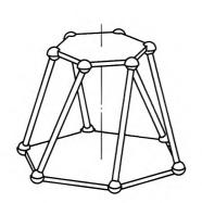
摘要:以一类动静平台均为等边三角形的 6-SS 型自运动机构为研究对象,从同源机构构造的视角探究该类机构的综合以及尺度特征。根据末端构件存在的转动、移动特征,建立空间单环 SSC 机构的共形几何代数模型,分析其运动参数与尺寸参数之间的映射关系;基于该机构在最高位置处的垂直投影,构造了具有相同映射关系的一簇 3-SS/C 机构,揭示了等边三角形平台的 6-SS 型自运动机构的同源构成本质以及所需满足的位形条件。根据机构簇存在的尺寸转换关系,设计给定的 3-SS/C 机构的同源机构,分析并得出平台设计点满足的几何规律,提出了 6-SS 型自运动机构综合的几何化方法;进一步基于所得出的几何规律,揭示了该类机构的比例尺度特征,Griffis-Duffy 平台为该类机构的特例。该项研究在丰富同源机构种类的同时,也为包含比例尺度特征的机器人机构拓扑结构设计提供了一个崭新视角。
