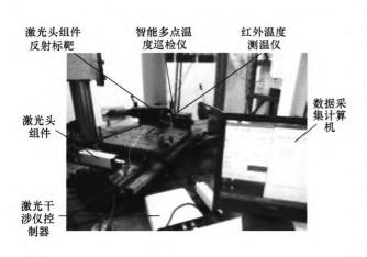
摘要:分析热动态伪滞后效应对直接进给轴驱动精度的影响,对进给轴具有的热伪动态特性进行建模和误差补偿研究。依据一维热传导和一维热膨胀理论,推导直线电机驱动进给轴热动态过程的温度分布模型和热变形误差动态模型,通过有限元分析方法和试验相结合,构建基于关键温度点的直接进给轴热伪滞后变形动态识别模型。应用激光干涉仪测量直接进给轴的热变形量,采用温度传感器和红外测温仪测量直接进给轴关键点的温度,构建进给轴动态热变形补偿系统,依据实时温度对应的热变形数据,发送热变形预测值给运动控制卡,进而向伺服控制器发送控制补偿指令,通过对直接进给轴的运动叠加控制,实现对直接进给轴的热变形补偿。在自构建的直接进给轴试验台上进行试验研究,结果表明:动态识别模型能有效的预测动态热行为,通过构建热变形补偿系统,可使直接进给轴进给精度提高 75%。
