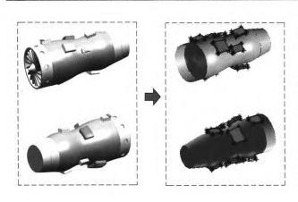
摘要:分支管路的布局优化属于 NP 难问题,其多目标优化情况则更加复杂。针对航空发动机分支管路多目标敷设问题,以分支管路长度最小化、分支点数量最小化以及管路平滑度最优为优化目标,建立了基于避障 Steiner 树的分支管路多目标布局模型。考虑到模型的复杂性,设计基于多目标粒子群优化(Multiobjective particle swarm optimization,MOPSO)的模型求解算法。其中,以分支点数量和坐标作为决策变量;针对分支管路拓扑结构特点,提出一种分支管路平滑度计算方法,结合非支配排序和网格密度计算完成个体多目标评价;通过可视图和测地线处理约束条件;通过多目标粒子群进化计算求得 Pareto 解集。所建立的分支管路多目标布局模型及求解算法考虑了多端点情况、多目标优化以及避障约束。最后通过管路敷设算例验证了可行性。
