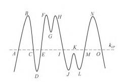
摘要:为兼顾插补含尖角 NURBS 曲线的精度与速度,提出尖角分割且速度修正插补算法。由插补弦高误差限、法向加速度及其导数约束,得满足插补精度及机床动力学性能的临界曲率;用大于临界曲率的局部极大曲率及临界曲率分割 NURBS 曲线为是否包含尖角的若干子段;用 S 曲线加减速算法规划各子段进给速度,并用段间速度及位移协调关系修正各段加速度及其导数,使各段加减速时间为整数倍插补周期。在相同约束条件下,分别用曲率单调无速度修正、尖角分割无速度修正及尖角分割有速度修正算法,规划一条含大曲率尖角 NURBS 曲线插补速度,并用一阶泰勒级数展开算法插补该曲线。对比结果表明尖角分割且有速度修正算法可稳定得到较高插补精度,因此该算法可用于含大曲率尖角 NURBS 曲线高速度高精度加工。
