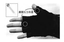
摘要: 动力手套是一种腕部康复训练装置,同时具有辅助的助力功能。康复训练是手腕进行自主康复的一种重要的辅助治疗手段,传统的康复训练装置大多采用电机驱动的刚性外骨骼结构,在运动时急剧变化的冲击力易造成关节二次伤害,同时较大的质量增加了身体的额外负担。基于气动人工肌肉设计并制作了一款柔性可穿戴动力手套装置,能够实现腕关节屈/伸、内收/外展两自由度运动,集康复训练与腕部助力于一体,轻量化柔顺的外骨骼结构提高了其便携性及舒适性。通过嵌入薄膜压力传感器能够感知手掌与物体之间的抓取力,自动实现腕关节助力功能并有效地保护腕部。对腕部进行穿戴静力分析求解手套装置的性能需求参数,并测试气动肌腱的关键指标及手套的整体性能,测试结果表明所设计的动力手套能够满足腕部康复训练要求并具有辅助的助力功能。
