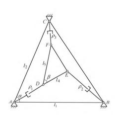
摘要:为了解决三自由度平面并联机构的正运动学分析建模和求解时,需要建立坐标系和消元的问题,基于共形几何代数(Conformal geometric algebra, CGA)提出一种脱离坐标系的几何建模和免消元计算方法。在共形几何代数框架下通过基本几何体的相交、分离和对偶运算,表示出动平台上的两个铰链位置;根据动平台三角形面积的有向性,并经过一系列的几何代数运算和化简推导出该问题的特征多项式方程;通过半角正切变换、欧拉变换或不需要任何变换可直接获得任意构型的平面并联机构正运动学分析的一元高次方程。特征多项式方程的推导脱离了坐标系,不需要经过消元,且不需要任何前提条件。数字实例求解表明提出的方法对于特殊构型和一般构型的平面并联机构都是适用的,验证了算法的正确性,结果表明算法数值鲁棒性好,为平面并联机构运动学求解理论提供了一种新思路。
