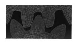
摘要:剃齿过程中,啮合周期在节圆附近出现单点接触即三点啮合区域,是导致剃齿齿形中凹误差的重要原因之一。基于负变位剃齿和平衡剃齿的原理,对负变位剃齿刀进行非等边齿形设计,通过减小副工作面的最大曲率半径,使主、副工作面同时啮入,实现平衡剃齿,有效地消除了节圆附近三点啮合区域,改善了该区域轮齿间啮合力不均匀的情况。以传动误差曲线幅值作为量纲,将非等边剃齿刀与负变位剃齿刀进行对比分析,结果表明:非等边剃齿刀能够优化负变位剃齿的不足以及平衡剃齿条件难以实现的缺点,使剃齿啮合过程轮齿间啮合力趋于平稳,实现平衡剃齿,降低传动误差幅值,为消除剃齿中凹误差提供了新的技术思路。
