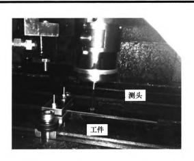
摘要:针对叶片类薄壁零件铣削加工装夹卸载后发生的残余应力变形难以准确预测的难题,提出了基于装夹力监测的残余应力变形感知预测方法。建立了残余应力变形感知预测的数学模型,对感知预测过程进行了数学表述;基于超静定结构理论提出了残余应力变形感知预测的求解方法,利用变形协调方程实现了基于装夹力变化的残余应力变形等效求解;分析了几种典型装夹形式的感知过程,提出了残余应力变形感知预测的实现步骤;搭建了残余应力变形感知预测试验平台,将叶片简化为薄板模型进行了铣削残余应力变形感知预测试验,试验结果表明,装夹卸载后残余应力变形感知预测值与实测值相比误差为 13%,具有较好的一致性,从而验证了该方法的有效性。
