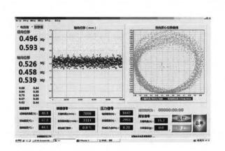
摘要:基于滚动轴承的动力学理论,建立了圆柱滚子轴承的非线性动力学微分方程组,使用希尔伯特-修斯-泰勒(Hilber-Hughes-Taylor,HHT)变步长积分算法对其动力学微分方程组进行对称多线程(Symmetric multi-processing,SMP)并行求解,联合机械系统动力学自动分析软件 ADAMS、控制仿真软件 Matlab/Simulink 搭建了圆柱滚子轴承的半物理仿真试验系统,实现了圆柱滚子轴承动力学仿真系统与物理试验机之间的信息交换,进而对滚动轴承的半物理仿真试验技术进行了探索与研究。该研究结果为滚动轴承的半物理仿真试验技术进供了一条可行的技术路线,能够对轴承的试验结果进行补充,为滚动轴承的半物理仿真试验技术提供借鉴与参考。
