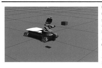
摘要:结合机器视觉和运动规划方法,对动态环境中移动物体的平滑抓取进行了研究。设计了一种运动物体跟踪算法,能够实现无障碍环境下移动物体的平滑抓取;针对环境中存在动态障碍物的情况,设计了一种基于排斥矢量的动态避障算法,与运动物体跟踪算法相结合,实现了机器人先避障后平滑抓取;基于机器人操作系统(Robot operating system, ROS)框架,在5自由度的KUKA Youbot 机械臂平台上实现了无障碍环境下对传送带上物体的平滑抓取,以及动态障碍物环境中的平滑抓取,试验结果验证了所设计算法的优越性。
