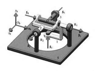
摘要:提出一类基于球面五杆机构的变胞并联机构。基于具有解耦特性的球面五杆机构,应用螺旋理论综合出一类具有变胞特性的可重构混联支链,该混联支链由一个球面五杆机构和一个四自由度串联支链混联而成,应用三条相同的所述可重构混联支链构型出一类变胞并联机构。不同于现有利用约束奇异和支链奇异综合可重构并联机构的方法,提出利用球面五杆机构的解耦特性和关节锁死的方法来实现并联机构的可重构,因此该类变胞并联机构可有效避免重构过程中的约束奇异以及支链奇异。该类变胞并联机构可在一个广泛的范围内变换其工作模式和自由度,且伺服电动机均可安装在机构的固定平台。提到的方法可应用于其他基于解耦闭链的变胞并联机构构型综合。
