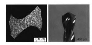
摘要: 微细钻头的几何结构是影响刀具钻削性能和微孔加工质量的关键因素。非共轴螺旋面钻尖由连续的螺旋后刀面组成,相比平面钻尖能有效的提高刀具的刃磨效率及其钻削性能。针对非共轴螺旋面钻尖,推导后刀面形成过程中螺旋运动发生线的位置方程,建立了基于砂轮和钻头接触线的后刀面数学模型。根据六轴数控工具磨床的运动原理,提出出等的基础,是出微细钻头螺旋槽的数控加工方法。进行非共轴螺旋后刀面微钻的刃磨试验,验证了该刃磨方法的可行性。进而采用制备出的具有相同几何结构参数的平面、锥面和非共轴螺旋面和锥面微钻的钻削力、后刀面磨损明显小于平面微钻,并且非共轴螺旋后刀面微钻的横列磨损程度小于平面和锥面微钻。研究证实了所提出的五轴联动刃磨方法可以有效地制备出较高钻削性能的非共轴螺旋后刀面微细钻头。
