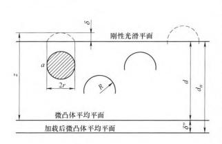
摘要:结合面接触刚度直接影响了机械设备的整机动态特性,为了建立更为准确的接触刚度模型,以分形几何理论为基础,利用单一微凸体承受局部载荷时的弹性变形特性,并基于域扩展因子引入微接触截面积分布函数,推导了考虑表面微凸体相互作用影响的结合面接触刚度分形模型。为了验证所提出模型的准确性,通过三维非接触式测量,获得了试验试样的表面轮廓数据,并根据结构函数法,计算了各个试样的表面分形参数,进而将理论接触刚度与试验结果对比分析,结果表明:法向接触刚度的增长速率与粗糙面表面临界接触面积有关,临界接触面积决定了结合面内的弹性变形占比。考虑微凸体相互作用后,所提出模型的预测曲线更加符合试验中法向载荷与接触刚度的关系。
