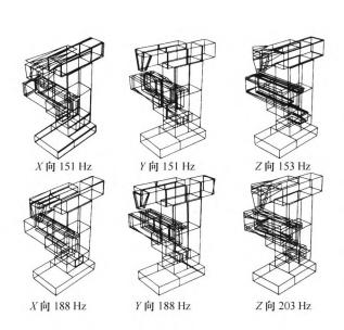
摘要: 使机床切削点动柔度最大值在整个工作频率范围内 最小,是机床实现无颤振稳定切削和高精度切削加工的要 求,也是对其进行动态优化设计所应达到的目标。基于模 态柔度和能量分布的机床结构动态优化设计原理,实现了 一种以降低切削点交叉动柔度值为目标的优化方法。该方 法利用切削点交叉动柔度与模态柔度的关系, 首先寻找薄 弱模态,再分析薄弱模态上各部件和环节的能量分布,确 定该模态上的薄弱环节,然后在一定的约束条件下,改进 这些环节的设计参数,从而实现优化目标。以某型万能工 具铣床为例, 在整机建模分析计算的基础上, 阐述了该优 化方法的具体应用。通过模态柔度和能量分布计算,判明 该机床的薄弱环节是横梁-水平主轴体系统,针对薄弱环节 设计参数的改进实现其质量和刚度的优化,优化后的静柔 度和模态柔度都有较大的降低,而固有频率则相应提高, 切削点动柔度的最大值降低近 18%。并在此基础上进行结 构改进设计,改进前后机床的谐响应分析和切削试验对比 结果表明优化方法有效地改善了机床的动态性能,再生颤 振稳定性得到大幅提高。
