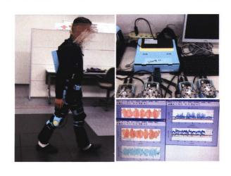
摘要:针对步行辅助中人机交互柔顺性和髋膝关节协调自律控制的问题,提出一种新型多关节协调自律控制方法,该方法基于中枢模式发生器(Central pattern generator, CPG)网络,同时具备单关节人机交流和多关节协调运动特性。建立左右侧髋、膝关节 4 个 CPG 单元及其对外交流机制,改善了各关节处的人机交互柔顺性;建立左右髋关节、左右膝关节 CPG 单元间的对称抑制连接及同侧髋膝关节 CPG 单元间的非对称内部抑制连接,获得双侧髋膝关节间的逆相位及同侧髋膝关节的自然相位,实现了人机交互环境下稳定的步行辅助。穿戴式步行试验证明了该方法对生成步行中自然髋、膝关节协调运动的有效性。最后,采用肌肉活动强度、步长和步行速度三个指标,运用对比试验的方法讨论和分析了步行辅助效果。
