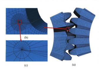
摘要:当齿轮发生故障时,时变啮合刚度的变化能够反映齿轮故障特征大小。因此,时变啮合刚度在齿轮传动过程中是一个重要的动力学参数。提出一种新的齿根裂纹啮合刚度计算方法,即解析有限元法(Analytical-finite element method, A-FM)。考虑到齿轮发生故障时,啮合刚度解析模型计算精度较低,将应力强度因子引入裂纹齿轮的啮合刚度计算过程。首先定义应力强度因子与啮合刚度之间的关系,通过建立齿轮接触模型计算裂纹尖端附近的应力强度因子,然后将计算结果替代解析模型中故障刚度部分。由于应力强度因子能够敏感地识别齿根裂纹的局部微小变化,故该方法相比于解析法具有更高的计算精度,相比于有限元法具备更快的计算效率。同时,建立6自由度动力学模型,通过对其振动响应进行分析,仿真结果验证了所提方法的可行性。
