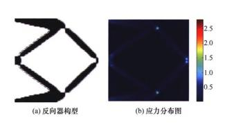
摘要:采用拓扑优化方法获得柔顺机构构型容易出现类铰链结构,导致应力集中、疲劳可靠性差。为了抑制类铰链结构,提出了一种基于最大应力约束的柔顺机构拓扑优化设计方法。采用改进的固体各向同性材料惩罚模型(Solid isotropic material with penalization, SIMP),以柔顺机构的互应变能最大化作为目标函数,采用P范数方法对所有单元的局部应力凝聚化成一个全局化应力约束,利用自适应约束缩放法使得P范数应力更加接近最大应力,以机构的最大应力和体积作为约束,建立柔顺机构最大应力约束拓扑优化模型,采用全局收敛移动渐近线算法求解柔顺机构最大应力约束拓扑优化问题。结果表明,采用P范数方法进行柔顺机构最大应力约束拓扑优化设计,能够有效抑制类铰链结构。随着应力约束极限值减少,获得机构构型由集中式柔顺机构逐渐转变为分布式柔顺机构,应力分布更加均匀,但机构的互应变能逐渐减小。
