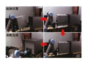
摘要:当前大型星载设备的安装采用人工操作机械臂的方式完成。由于星载设备昂贵,装配过程在半封闭非直视条件下进行,需要多人进行人工观察与口令调整,耗费数小时,装配效率低下。为提升装配效率,实现装配过程的智能化与精准化,提出一种基于机器人与视觉引导的星载设备智能装配方法。采用机器学习与双目视觉实现装配体之间的精确位置测量;通过机器人手眼标定完成视觉空间到机器人空间的运动映射;综合分析装配路径的干涉状况,对装配路径进行机器人运动规划;最后通过虚拟现实技术实现装配过程的可视化。整个装配过程可自动完成,装配时间缩短在若干分钟以内。进行了卫星与星载设备的模型装配试验,结果表明装配误差小于0.3 mm,验证了所提方法的有效性。
