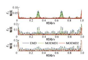
摘要: 经验模态分解(Empirical mode decomposition, EMD) 作为一种自适应的信号分解方法已经被广泛应用于诸多工程领域。为了提高 EMD 的分解性能,分别考虑从不同权值均值曲线的迭代筛分结果中选择正交性最小以及从每层内禀模态函数迭代结果中选择最优以保证整体分解最优,发展了两种均值优化经验模态分解(Mean-optimized empirical mode decomposition, MOEMD)算法。通过仿真信号分析,将 MOEMD 方法与 EMD 等现有信号分解方法进行了对比,结果表明,MOEMD 方法在分解性能和分解精度方面比 EMD 等方法有显著提高。最后,将 MOEMD 方法应用于转子碰摩故障信号分析,并与 EMD 进行了对比分析,结果表明,MOEMD 方法不仅能够有效地识别转子碰摩故障,而且识别效果优于 EMD 方法。
