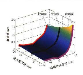
摘要:基于反向圆锥滚子等效接触模型和 Archard 磨损计算通式,提出了一种适用于标准斜齿轮齿面粘着磨损的计算方法。由时变接触线长百分比和弯-扭-轴耦合动力学模型确定齿面载荷,根据等效接触模型和 Hertz 接触理论计算齿面压力和滑移距离,求出准静态与动态载荷下的齿面磨损量。通过将主动轮磨损曲线与相关文献结果比较,验证了上述方法的正确性。几何与工作参数对磨损量的影响分析显示,齿根与齿顶处的磨损量较大,且齿根的磨损量大于齿顶,节圆处的磨损量趋近于零;齿轮前端面至后端面,主动轮磨损量逐渐减小而从动轮磨损量逐渐增大;宽齿轮的磨损量沿齿宽渐趋均布。参数分析表明:增大模数、传动比、齿宽或减小扭矩均可降低磨损量,增大螺旋角或改变转速对减小齿面磨损的作用不明显。上述研究对于提高齿轮表面质量与传动性能,对于减磨设计具有一定的参考价值。
