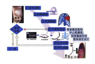
摘要: 我国每年有 98%的骨缺损患者由于缺乏理想的人工植入物而成为功能受限者,个体化植入物设计制造已经成为我国从经验医疗转型精准医疗的关键部分。聚醚醚酮(Poly-etherether-ketone, PEEK)材料被普遍认为是目前最为理想的个体化植入物原材料之一,然而个体化 PEEK 植入物的复杂结构(尤其是大尺寸植入物)需要综合考虑 PEEK 材料性能、制造方法的工艺特性、临床植入应用环境等多方面的交叉影响。介绍了面向大尺寸个体化 PEEK 植入物的精准设计方法与控性定制 3D 打印方法,确立了个体化植入物设计方法与制造技术的几点准则,并描述了研究技术在一例大范围胸骨肿瘤治疗上的应用过程,所设计与制造的 PEEK 材料一体式胸肋骨假体,最终植入患者体内,协助大尺寸缺损胸壁的重建。
