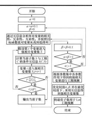
摘要:工期是晶圆制造中的重要性能指标,对其进行精准预测可促进系统运行优化,保证订单的准时交付率。针对晶圆工期影响参数多、数据体量大且作用机理复杂的特点,提出数据驱动的晶圆工期关键参数过滤方法,识别影响晶圆工期波动的关键参数。分析晶圆工期潜在影响参数,构建候选参数集;基于信息熵方法设计关键参数的入选测度,综合度量参数间的相关性、冗余性与互补性;提出过滤式的关键参数识别算法,滤取影响工期波动的关键参数子集。采用实例数据,从1202个候选参数中过滤得到78个关键参数,并采用神经网络模型进行工期预测,结果表明,该方法在预测精度和稳定性上都优于采用全局参数的多元线性回归与神经网络方法。
