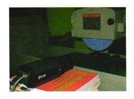
摘要:通过磨削弧区内直角三角形热源分布以及一维导热过程的简化,并基于平面连续磨削温度的理论分析,构建了成形磨削温度的数值计算模型。该模型首先能够对型面交界处平面与斜平面磨削热源的耦合作用进行描述,同时也能对型面交界处最易产生磨削烧伤这一现象进行定量化分析。依据平面磨削过程中砂轮与工件实际接触弧长和热量分配比例的理论计算模型,分别建立了成形磨削过程中平面与斜平面两个组成部分的热量分配比例计算方法。最后,设计了成形磨削温度的试验测试方法,通过成形磨削加工试验对数值计算模型的有效性进行了验证。试验结果表明,由于成形磨削过程中同时存在平面和斜平面两个磨削热源,二者之间存在耦合作用,从而导致平面与斜平面交界处的温升急剧增加,极易引起磨削烧伤。
