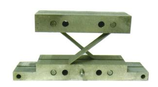
摘要: 交叉簧片柔性铰链的转动刚度特性对设计人员是需要重点考虑的,但一些相关的特性尚未被揭晓。通过对应用于静平衡仪的交叉簧片柔性铰链转角公式推导过程中保留垂直载荷的二阶项,建立铰链的转角-载荷模型。分析包含垂直为载荷高阶项的转动刚度和垂直力刚度,更好地描述了垂直载荷、几何参数对铰链刚度的影响。研究发现,只有垂直载荷及铰链转动角度均相对较小时,铰链才具有近似常值的转动刚度,并且随着垂直载荷的增加,铰链转动刚度趋于不断增大。当旋转角度较大时,垂直载荷作为铰链转动的驱动力,将会使铰链转动刚度的非线性特征体现的更明显。通过有限元仿真分析和试验验证了该类铰链的刚度特性,从而为交叉簧片柔性铰链的应用提供了依据。
