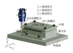
摘要:碳纤维增强树脂基复合材料(Carbon fiber reinforced polymer, CFRP)以其轻质、高强等优点,在航空航天高端装备上展现出巨大优势。然而,CFRP 中各组成相所需的切削能量及热导率具有差异性,在切断高强纤维的同时极易造成低强的纤维/树脂界面发生开裂,而热量积聚所引起的高温又会使树脂软化加剧裂纹扩展,严重影响装备的服役性能和可靠性。阐明切削力和切削热对加工损伤的影响机制是实现 CFRP 高质高效加工的关键。基于数字图像处理技术,建立 CFRP 铣削加工表层损伤面积评价方法,该方法可有效避免传统方法因只能考虑损伤的一维长度信息而无法评价加工损伤程度的问题。分析主轴转速和每齿进给对表层损伤面积、切削力以及切削温度的影响规律,并讨论切削力和切削温度对表层损伤面积因子的影响。研究表明:通过减小单次切削厚度和控制切削温度在适合区间可有效降低加工损伤。
