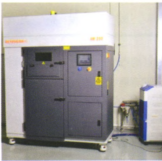
(a) AM250 激光熔融快速成型机
