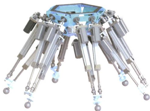
**摘要:** 针对六足并联机器人冗余驱动问题, 提出以降低能耗, 提高承载能力为目标的驱动力优化分配方法。通过建立六足并联机器人运动学与动力学模型, 得到机器人关节驱动力与脚力间转换关系。在分析机器人动态平衡条件并考虑摩擦约束、最大驱动力约束及触地约束的基础上, 建立以驱动力平方和最小为目标函数的二次规划问题。基于 QR 分解的广义消去法消去等式约束减少约束方程的数量以提高优化问题的求解速度, 采用对偶理论将问题转化为对偶二次规划问题可以进一步提高求解速度。分析了多足机器人与多指灵巧手动力学模型的不同, 因此两者的二次规划目标函数也存在不同。同时与传统的以内力最小为目标函数的方法比较, 表明该方法能够充分利用地面摩擦力以减小驱动力, 从而提高承载能力, 降低能量消耗。
