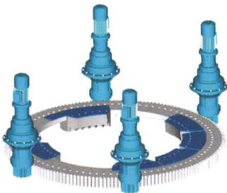
**摘要:** 多源驱动/传动系统广泛应用于新能源、航空航天、海洋工程等领域重大装备中, 其齿轮传动装置通常由多个电动机共同驱动。针对多源驱动/传动系统在工作过程中存在的多驱动源速度与转矩不同步问题, 结合其复杂耦合非线性的结构特点, 提出一种以轴系单元法为基础, 包含驱动电动机、齿轮传动装置和负载特性的多源驱动/传动系统机电耦合动力学模型。研究了不同载荷变化率以及电动机故障条件下对系统同步特性(速度同步、转矩同步)的影响规律。研究表明, 载荷变化率对多源驱动/传动系统速度同步特性影响较小; 但在载荷突变瞬间对系统转矩同步特性影响较大。电动机发生故障时, 非故障电动机间的速度和转矩同步特性基本保持不变。该研究结果将为多源驱动/传动系统同步控制策略的制定提供理论基础。
