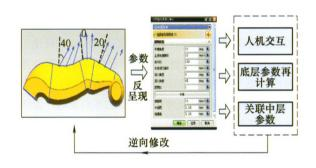
摘要:为解决复杂压铸件浇道系统生成繁琐、关联性差,以及在建模过程中设计信息易产生随机变异和理解偏差等问题,提出一种以语义为主导的 3D 建模方法,定制"三层参数和二级语义映射"机制,实现几何信息与设计意图契合统一;另外,借鉴压铸模知识原理,将浇道复杂零部件做结构、功能上的区别统一,抽象为多语义类,各类按设计优先级高低细分为多语义单元,进而构建出浇溢语义模型库。以上述理论为基础,结合拓展参数化设计技术,以 UG/NX 为开发平台,开发出浇道设计系统。实例分析表明,该建模方法使得设计者能够从语义层直观编辑浇道特征,通过调用修改接口实现模型驱动,在对诸多复杂压铸件模具设计中具有良好的精确性、高效性及广泛的自适应性,能有效地缩短开发周期。
