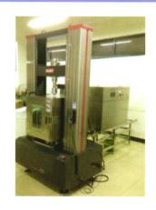
摘要: Kevlar 纤维具有高强高模、耐高温、耐辐射等优越性能,由 Kevlar 纤维制成的张力索越来越多地应用到航天航空领域。针对 Kevlar 纤维张力索蠕变问题,利用电子蠕变机测试了不同温度、不同载荷条件下的热膨胀系数和蠕变规律。通过试验发现,Kevlar 纤维张力索的热膨胀系数随着温度升高、力密度的增大而增大;确定了一种 Kevlar 纤维张力索合适的预拉伸方法;蠕变试验表明,Kevlar 的蠕变速率起初迅速下降,最后逐渐趋于恒定,且随着加载力增大、温度升高,Kevlar 蠕变现象越来越明显。基于恒温恒载假设的 Andrade理论,对 Kevlar 纤维张力索蠕变试验数据进行了拟合,建立了考虑张力和温度的蠕变特性模型。
