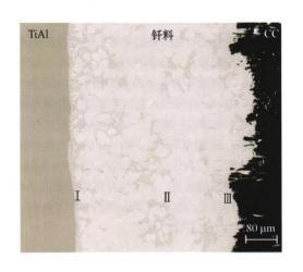
摘要:采用(Ti/Ni/Cu)<sub>f</sub> 多层箔状钎料进行 C/C 复合材料与TiAl 合金的钎焊,实现了良好的界面结合,保证了接头的高温力学性能。研究结果表明:钎焊过程中,首先在 Ti/Ni 界面处接触反应形成低熔共晶液相,Cu 元素的溶解促进了钎料的完全熔化和扩散,接头组织一般为 C/C/TiC/Al₂(Cu,Ni)Ti₃C/Ti(Cu,Ni)+Al(Cu,Ni)₂Ti/Al(Cu,Ni)1+Ti₃Al/TiAl,Ti(Cu,Ni)基体相和球状弥散分布的 Al(Cu,Ni)₂Ti 相是钎缝的主要组成部分。当钎焊温度较低或者保温时间较短时,由于钎缝中生成了大量的脆性 Ti₂Ni 相,降低了接头的力学性能;当钎焊温度较高或保温时间较长时,C/C 复合材料母材界面处开裂,且 TiC 层从母材脱落,也削弱了接头的抗剪强度。当钎焊温度为 980 ℃,保温时间为 10 min 时,C/C 复合材料与 TiAl 合金的接头室温抗剪强度达到最大值 18 MPa,600 ℃时接头的高温抗剪强度达到 22 MPa。
