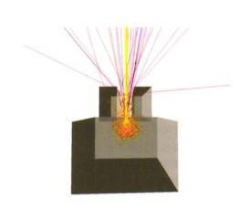
摘要:针对航天有效载荷微波部件频发的微放电现象,采用 微陷阱表面构型来抑制微波材料表面的二次电子发射,从而 达到微放电抑制效果。通过硅基材料的表面刻蚀和金属 Ag 的 表面溅射获得规整的金属表面微陷阱结构,将表面处理过的 金属样品在二次电子发射平台的电子枪20~4000 eV 照射下, 采用电流法获得金属微陷阱表面的二次电子产额曲线及抑制 特性。此外,通过将表面出射的二次电子分为弹性背散射电 子、非弹性背散射电子和本征二次电子,并跟踪电子在陷阱 结构内的级联再入射过程,建立表面圆柱孔和矩形槽微陷阱 表面的二次电子发射数值模型,模拟结果与测试结果能很好 吻合。采用数值模拟的方法构造不同深宽比的微陷阱结构表 面,最大二次电子产额、第一交叉能量以及微放电品质因子 的变化规律。研究结果表明:陷阱结构的侧壁遮挡效果能有 效抑制二次电子从表面发射,并且深宽比越大的表面陷阱结 构抑制效果更强,而在相同深宽比情况下,圆柱孔陷阱结构 比矩形槽陷阱结构对二次电子的抑制效果更好,此外,陷阱 结构的深宽比不仅能使得最大二次电子产额减小、第一交叉 能量增大,还会近线性地增大材料的微放电品质因子F。
