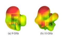
摘要:针对传统微带天线频带窄,增益低等不足,通过在天线的辐射贴片和接地板上分别刻蚀花型和十字交叉缝隙图案,设计并制作了一种基于超材料的宽频带定向性微带天线。刻有图案的金属贴片和接地板间形成电容感应等效回路并改变了天线电磁场的辐射方向。天线电磁场的辐射方向主要集中在水平-x方向而不是传统微带天线的垂直方向。相比传统微带天线,该设计天线的性能得到明显改善。仿真结果表明:天线的工作带宽为 3.5~11.6 GHz(是传统微带天线的电压驻波比小于 2,增益均大于 5 dB。测试结果表明:设计天线的电压驻波比小于 2,增益均大于 5 dB。测试结果表明:设计天线的工作带宽为 2.82~12.69 GHz(是仿真模型的 1.22 倍),相对带宽为 127.3%。该设计天线可广泛地用于弹载天线,炮瞄雷达,卫星通信网络、汽车雷达等。
