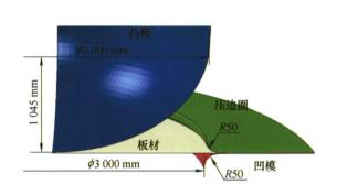
摘要:塑性失稳诱发起皱是制约薄壁曲面构件整体成形的瓶颈问题,通过考虑悬空区反胀效果的曲面薄壳流体压力成形力学分析,推导抑制起皱和破裂的非线性流体压力加载曲线,建立临界起皱应力模型为塑性失稳提供理论判据;在此基础上,针对大型贮箱整体箱底构件流体压力成形起皱预测和控制难题,理论计算大型箱底流体压力成形加载路径,分析流体压力加载路径对反胀区形状、失稳行为和应力分布影响规律,揭示曲面薄壳流体压力成形起皱抑制机理;采用我国自主研制的超大型数控流体压力成形装备(成形力 1.5 万 ½ 高压液体体积 5 m³),首次试制出直径 3 m 级运载火箭燃料贮箱整体箱底,解决了大型超薄(厚径比 2‰)曲面薄壳失稳难题。
