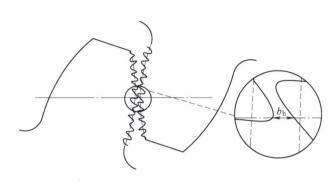
摘要:主要研究具有分形特性的齿侧间隙对齿轮-轴承系统动态特性的影响。首先建立该系统的动力学模型,考虑转轴、轴承等重要部件对齿轮系统动态特性的影响。模型中计及滑动轴承非线性油膜力、综合传递误差及齿轮时变啮合刚度等非线性因素。在对系统的动力学分析中引入分形理论,讨论齿侧间隙表现出的分形行为,并使用 W-M 函数对其进行描述。通过 Runge-Kutta 法求解动力学方程并得到系统响应的相图,Poincaré 截面图与分岔图。结果表明:当啮合刚度较大时,系统的分岔行为减少,1 周期与混沌交替出现;当齿侧间隙在小范围内波动时,相比于固定齿侧间隙,使用具有分形特性的齿侧间隙时系统响应表现出了更多细节,可以更准确地描述系统的动态特性;随着啮合刚度的增大,系统可以在分形维数 D 较大的情况下依然保持准周期运动,即刚度较大时系统较稳定。
