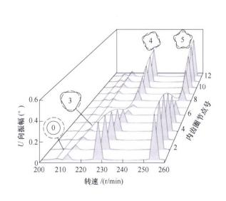
摘要:以行星轮系柔性内齿圈为研究对象,为计入拉伸、剪切和弯曲变形等因素,使数学模型更好与工程实际相匹配,根据其结构及边界特点采用平面梁单元建立弹性边界柔性直齿内齿圈的振动分析模型,并对其固有特性进行了研究。基于叠加原理和力向一点平移定理,采用组合激振法等效模拟了沿啮合线作用的啮合激励,并从频域角度揭示了啮合激励对弹性边界柔性内齿圈振型可归结为三类:平移振动模式(内齿圈各点具有相同的运动),弯曲振动模式(内齿圈发生弯曲变形的振动)和扩展振动模式(内齿圈各点仅产生径向振动);啮合激励对扩展振动模式影响较小,而对弯曲振动模式影响显著;对直齿内齿圈而言,弯曲振动模式是引起振动与噪声的主要原因;当扩展振型(波数 m=0)发生共振时,内齿圈呈等幅振动;当波数 m 不为零的振型共振时,内齿圈呈 m 个波形。
