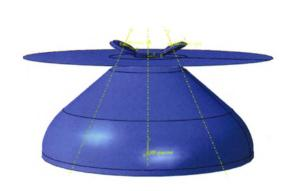
摘要:大型薄壁异型曲面整体构件是航天航空等重要领域迫切需要的高性能轻量化构件。旋压和淬火是实现该类构件整体化制造和性能控制的一种有效途径。然而,大型薄壁异型曲面旋压是多因素耦合作用下的多道次局部加载/卸载复杂过程,成形过程中易出现局部损伤破裂、起皱、隆起、不贴模等缺陷,且旋压后的淬火过程还易造成大的残余应力和淬火变形,并决定着构件的最终使用性能。在建立大型薄壁异型曲面构件旋压和淬火全过程有限元模型的基础上,分析大型薄壁异型曲面构件旋压过程中应力应变分布与变化规律;研究失稳起皱缺陷的形成机理,获得旋压工艺参数对薄壁壳体凸缘周向压应力的影响规律,提出控制凸缘起皱的方法;研究板坯尺寸波动对成形质量的影响;研究获得大型薄壁异型曲面封头旋压件淬火残余应力分布规律和淬火变形规律。
