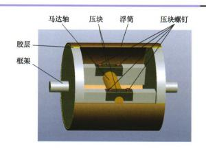
摘要:高精度陀螺仪是一种重要的惯性导航器件,广泛用于航空、航天及船舶等,对装配工艺的要求极高,尤其是随着精度要求的不断提高,组件结构的稳定性成为目前研究的焦点。而装配应力是影响组件结构稳定性的主要因素,为此,从高精度陀螺仪的结构特点和误差形成机理研究出发,建立了陀螺仪理论误差模型,分析仪表组件结构的稳定性对陀螺仪精度的影响情况。在此基础上,分别对陀螺仪中的两种主要连接结构螺纹连接和胶粘连接进行研究,并结合结构设计和装配工艺提出了有效可行的装配应力控制方法。
