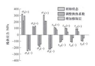
摘要:针对构件热加工过程变形控制的世界性难题,创建了差异壁厚/差异结构构件加热或冷却过程零畸变的等 Biot 数模型,首次以 Biot 数替代综合换热系数 h,并将 Biot 数引入温度场方程,由此建立了随 Biot 数变化的动态温度场和应力场耦合模型。利用 ABAQUS 软件对 ZL205A 铝合金差异壁厚构件淬火过程的温度场和应力场进行了预报。模拟结果表明,ZL205A 铝合金构件淬火变形源于差异壁厚导致的二者温度差;对于薄厚比为 1:4 制件,540 ℃固溶淬火 0.37 s 时,薄厚壁特征位置最大温差为 276 ℃,厚壁中最大热应力 84 MPa,超过相应温度下该合金屈服强度,导致制件淬火变形,且变形以径向变形为主。通过对厚壁或薄壁处以高导热或低导热系数覆层材料修饰,获得了差异壁厚的等 Biot,并对修饰后的构件进行 540℃固溶淬火变形进行预报。结果表明,与无修饰构件相比变形降低 82.6%,实现了差异壁厚的准同步淬火。
