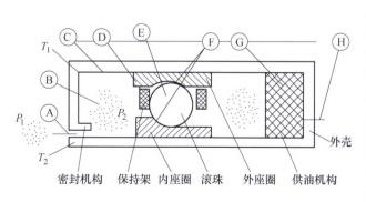
摘要:多孔聚合物轴承保持架具有质轻、噪声小、耐腐蚀性强、自润滑性能好、可以循环供油等优点,是一种能满足特殊工况的新型润滑材料。作为空间高速轴承的核心部件,多孔聚合物轴承保持架的理化性质及润滑特性在很大程度上决定了航天器的运行精度和服役寿命。介绍了棉布-酚醛、尼龙、聚酰亚胺和聚醚醚酮四种常见的空间用多孔聚合物轴承保持架材料及其制备方法。基于多孔含油轴承的润滑机理,从材料的出油速率和吸油速率两个方面总结了影响其含油润滑性能的各项因素。综述了空间轴承在材料、空间润滑及失效理论、轴承寿命验证与评估三个方面中存在的问题及其解决方法。
