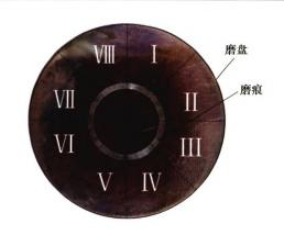
摘要:为探讨大口径厚壁管热挤压模具的磨损规律,以 ASME SA-335P91 钢、AISI H13 钢为研究对象,结合实际试验与有限元模拟,分析温度与保温时间对模具磨损的影响情况。从模具工作条件观察得到:在金属坯料与模具接触初期,模具表面温升对磨损影响较大;在金属坯料与模具处于热平衡状态时,该状态持续时间与当前温度是影响磨损的主要因素。在金属坯料与模具接触初期得到了温度-硬度方程、温度-磨损系数方程;在热平衡状态下得到了时间-硬度方程、温度-磨损系数方程。结合 Archard 磨损理论,得到了适用于大口径厚壁管热挤压模具的磨损规律。最后对有限元软件进行二次开发,结果表明,预测值与高温磨损试验值基本一致,可为该类模具磨损优化设计提供理论支持。
