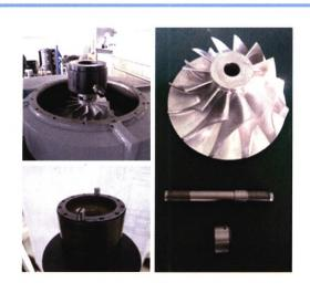
摘要:高速磁悬浮鼓风机由于采用磁轴承支撑和高速直驱的工作方式,相比于传统鼓风机可以显著提高工作效率,具有清洁、静音、维护费用低,无需油膜润滑等优点,但是相对于传统鼓风机,高速磁悬浮鼓风机对涡轮叶片的锁紧装置有特殊的要求。针对一台额定功率为315 kW额定转速为30000 r/min 的高速磁悬浮鼓风机的涡轮锁紧装置进行设计和动力学分析,建立其在加速过程、稳速运行、降速过程和意外跌落过程等4种工况下的力学模型,分析了其工作原理与失效的原因,并针对磁悬浮转子意外跌落的冲击载荷进行了结构上的改进设计,使其满足在所有工况下的可靠锁紧。改进后的锁紧装置通过试验证明了其有效性和可行性,本研究可以为同类机构的设计提供参考。
