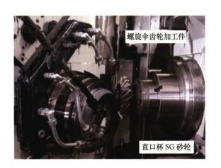
摘要:螺旋伞齿轮广泛应用于重型车辆及军用飞机的传动系统中。磨削作为螺旋伞齿轮加工中的最后一道工序,若磨削表面形貌不符合要求,将导致齿轮耐磨性及抗疲劳强度降低,传动时产生过大的噪声与振动,严重影响重载车辆传动系统的使用寿命与可靠性。为此,通过对螺旋伞齿轮磨削磨粒运动轨迹、砂轮表面形貌特征进行建模和仿真,实现对螺旋伞齿轮磨削表面形貌的预测与分析。针对螺旋伞齿轮设计磨削试验,探究不同磨削工艺参数对齿轮表面形貌的影响。研究结果表明,提高磨削速度与展成速度、增加磨粒粒度皆有利于获得良好的磨削表面形貌,仿真及试验所获得的螺旋伞齿轮磨削表面形貌基本一致,所建模型可有效地分析螺旋伞齿轮磨削表面形貌的产生过程及各加工参数对其影响机理。
