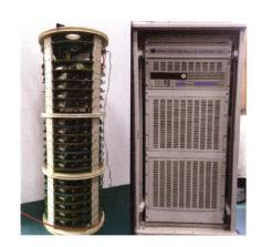
摘要:为提高海底观测网络的稳定性,提出一种海底观测网络的直流高中压变换器电路结构并讨论其动态特性。针对高中压电源变换器输入电压高,输出功率大的特点,采用串联输入串联输出和串联输入并联输出相结合的多模块复合结构,来减小体积并实现模块化设计;控制上采用提前引入补偿值的电压型 PWM 控制技术,实现抗干扰能力强和响应速度快等特性;采用继电反馈法整定误差放大器的 PI 参数,减小系统的输出超调电压和稳态波动幅值,使得该电源变换系统在大负载阶跃下的动态稳定性有所提高。为后续分析系统在启动和负载变化等大信号下的瞬态响应,建立高中压电源变换器仿真模型。仿真和试验结果表明,所采用得模块化设计能实现极小体积,并能达到散热需求,采用无超调整定规则整定的 PI 参数能极大地减小系统输出超调电压和稳态波动幅值,使得高中压电源变换器的稳态特性得到提升,在启动和负载切变过程中均表现出了良好的动态特性。
