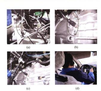
摘要: 针对车辆爬行工况下发生的严重变速器齿轮敲击问题,设计开发新型三级刚度扭转减振器,并通过专用台架试验和实车试验验证了三级刚度扭转减振器性能。首先,基于传统从动盘式扭转减振器结构特点,设计新型三级刚度扭转减振器机械结构并阐明其工作原理; 其次,利用专用台架试验,测试得到从动盘式扭转减振器和新型三级刚度扭转减振器扭矩传递特性,验证三级刚度扭转减振器机械结构设计和性能参数设计的有效性; 最后,设计实车道路试验,包括试验测试流程和传感器布置方案,综合试验信号时域、频域和时频域结果,对比分析传统从动盘式扭转减振器和新型三级刚度扭转减振器而有效振器和新型三级刚度扭转减振器可有效据性能。结果表明,该新型三级刚度扭转减振器可有效解决原车在爬行工况下传动系统剧烈的扭转波动和变速器齿轮敲击问题。
