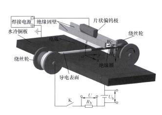
摘要: 绝缘固壁和片状偏钨极的联合调控能够有效改变电弧温度分布,从而解决超窄间隙焊接过程中底角熔合不良的问题。为了明确绝缘固壁对片状偏钨极电弧温度的影响规律和调控机理,采用一种静电探针差动分析方法对绝缘固壁约束片状偏钨极电弧载流区进行诊断。结果表明,绝缘固壁对片状偏钨极电弧的固壁约束作用更投升电弧载流区温度峰值,使钨极厚度方向载流区温度分布范围明显收缩;约束作用能够强化片状偏钨极对电弧电流密度的引导作用,从而使电弧高温区沿钨极宽度方向放电间隙小的位置发生整体偏移,且在电弧电场分布的影响下,沿弧长方向偏移程度由阳极向阴极减小;但过强的约束作用会导致钨极局部因电流密度过度集中而烧损,约束作用不足将无法对电弧载流区温度起到有效调控。
