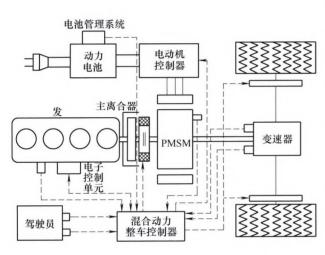
摘要: 插电式混合动力汽车兼顾传统混合动力汽车和纯电动 汽车的优点,即具有较长的续驶里程又具有较好的燃油经济 性, 插电式混合动力汽车的实时能量管理策略是发挥节能潜 力的关键技术。为解决具有手动行驶模式选择功能的 P2 构 型插电式混合动力汽车的能量管理实时优化问题,定义发动 机和电机功率分配因子, 在任何 SOC 下从电量消耗模式切 换到电量维持模式时,提出通过功率分配因子动态调整发动 机最优工作曲线获得最佳的燃油经济性的实时能量管理策 略。建立功率分配因子全局优化模型,利用自适应模拟退火 算法离线优化功率分配因子,研究功率分配因子和 SOC 对 整车燃油经济性的影响规律,得到在不同 SOC 的最优功率 分配因子控制线。从而建立基于最优功率分配因子控制线的 插电式混合动力汽车实时控制能量管理策略。在多个循环工 况下对比仿真分析不同 SOC 下的燃油经济性,结果表明基 于最优功率分配因子的能量管理策略使得燃油经济性改善 幅度最大可达 16.99%。
