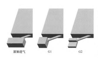
摘要: 为了揭示不同进气腔配置诱导涡系重构对气膜冷却效 果的影响, 在圆柱形气膜孔的基础上研究了三种不同冷气腔 结构以产生不同的进气预旋气膜冷却流动结构,并对三种冷 气腔在吹风比分别为 0.5, 1.0, 1.5, 2.0 的条件下进行了对 比研究。结果表明: 在低吹风比时, 冷却气体出射动量小, 三种进气方式的气膜冷却效率相当。随着吹风比的增加,进 气预旋气膜冷却的优势逐渐显著。在吹风比为 2.0 时,原始 进气冷却流体出射动量大且分布均匀, 形成了强肾形涡, 气 膜冷却效率最低; 第一种进气射流在孔上游形成一低动量 区,该区域冷气与高温主流相互作用后绕开高动量区冷气射 流后贴附壁面,在下游冷却效果明显;第二种进气冷却流体 以单向旋涡的结构喷出,在下游形成一侧旋涡"压"着另一侧 旋涡的流动形式, 使被压旋涡中冷气更好的贴附壁面, 射流 侧向速度大,扩大了射流展向覆盖区域。相对于原始进气, 第一种进气和第二种进气的平均绝热气膜效率, 在吹风比为 1.0 时,分别提高了约 10%和 25%,在吹风比为 1.5 时,分 别提高了约 50%和 550%。
