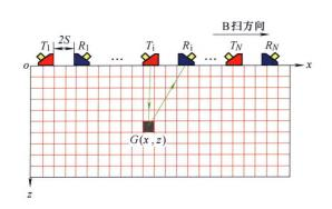
摘要:将相位相干成像(Phase coherence imaging, PCI)后处理算法应用于厚壁焊缝超声 TOFD 检测,有效改善低信噪比和水平分辨力问题。首先,利用合成孔径聚焦(Synthetic aperture focusing technique, SAFT)算法对TOFD-B图像的孔径数据集进行延时叠加处理。然后,基于 PCI 算法通过孔径数据集中各路信号的相位信息构建相干因子,用以表征 B-SAFT 图像中各像素点的相位相干性。最后,通过构建的相位相干因子对 B-SAFT 图像进行加权处理。结果表明,PCI 算法能够通过放大相位分布对像素点幅值的贡献,有效抑制噪声和提高信噪比,使壁厚78 mm 奥氏体不锈钢焊缝中 3 个 Ø3 边钻孔平均信噪比达到 30 dB以上,较 TOFD-B图像提高了 20 dB。此外,PCI算法还可增强孔径波束指向性提高分辨力,使 48 mm 壁厚 CV 焊缝中缺陷半波高水平宽度较 TOFD-B图像缩小70%以上。
