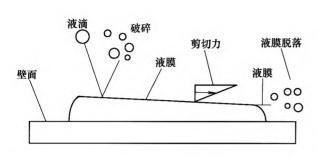
摘要: 雾化形成液膜的传热系数与厚度是决定喷雾冷却效 果的重要因素。采用数值模拟方法,基于加热壁面上的液 膜厚度、传热系数与温度分布三个角度,分析喷雾的压力、 高度与倾斜角度对喷雾冷却传热特性的影响。结果表明: 喷雾压力是影响换热效果重要的因素。相比于低压力工况, 高压力工况时壁面上形成的液膜厚度小,壁面平均温度低, 换热能力较强。压力工况越大,壁面温度下降程度越高。 主要因为喷射压力提高后, 液膜的运动速度加快, 导致与 空气之间的扰动作用加强,促进了液膜破碎和液滴的形成。 改变高度使喷射到壁面的液滴密度程度不同,导致温度分 布不均匀。研究还发现喷雾高度对换热影响存在一个最优 值, H=6 mm 时, 换热效果最好。同样, 改变倾斜角度导 致壁面分为喷雾密集区跟稀疏区,换热效果区别大。喷雾 倾角  $\theta$ =30°时壁面换热效果最好且温度分布相对均匀。通 过分析得到的变化规律为喷雾参数的设定和喷雾效果的优 化提供了理论依据。
