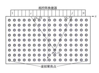
摘要: 超声相控阵技术近些年发展迅速并被广泛应用于工业无损检测领域,线阵探头全矩阵聚焦方法具有成像信噪比好、缺陷分辨力高等优势,近些年获得广泛研究,但其仍然存在采集数据量大、计算效率低的问题,使其在实际工业应用中受到限制。为了解决上述问题,基于检测系统收发通道的互易性提出三角矩阵聚焦成像算法,该方法简化了全矩阵聚焦成像算法的数据采集和成像运算过程。为验证聚焦成像方法的有效性,分别对类裂纹、平底孔和横通孔缺陷试块进行数据采集成像试验和信噪比分析,数据采集试验结果表明收发通道互换前后两信号具有很好一致性。进一步的数据比较分析表明,在成像质量方面,三角矩阵聚焦成像算法与全矩阵聚焦成像算法两者的图像信噪比变化不大;在数据采集和成像效率方面,三角矩阵聚焦成像算法降低了近一倍数据量,有效提高了计算效率。
