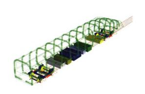
摘要:基于 Simiu 风谱的功率谱密度函数,建立自相关模型 (AR 模型),模拟随高速列车移动的点的随机脉动风速时程,分析得到随机风作用在高速列车车体上的气动激扰。建立考虑车体弹性振动和多个车下悬吊设备的刚柔耦合动力学模型,分析不同环境风速下气动激扰对车体和悬吊设备振动行为的影响。研究表明,气动激扰对车体和悬吊设备的横向和垂向振动特性明显,随着风速的增大,车体和设备振动加剧,但是对于车体横向振动来说,车辆运行速度低于 150 km/h,各风速下的差异不明显;合理选取车下悬吊系统的悬挂参数可以有效地降低车体和设备的振动,当环境平均风速 5 m/s时,车体横向采用 8 Hz 的悬挂频率比 1 Hz 的降低约 26.5%的振动;考虑气动激扰的车下悬吊系统振动行为研究可以更加真实地反映车体和悬吊设备的耦合振动关系,为设计更优异性能的车下悬吊系统提供参考价值。
