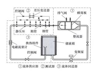
摘要:为揭示胶束减阻水溶液突扩流的紊流基本特性,对质量分数分别为 1×10<sup>-4</sup>、4×10<sup>-4</sup>的季铵盐 CTAB 稀薄水溶液通过一个横截面积比为 1:4 的突扩管的流动局部阻力、阻力发展及压力分布特性进行了试验研究。结果显示,胶束减阻突扩流在紊流基本特性上与高分子减阻剂完全不同。当突扩进口流的雷诺数小于 1.2 倍的临界值时,突扩局部阻力损失系数以小于 10%的量级小于纯水,压力恢复最大值大于纯水;当突扩来流大于 1.2 倍的临界值雷诺数时,突扩局部阻力损失略大于纯水,而压力恢复最大值与纯水基本相同。突扩进口为具有一定减阻效果的胶束减阻流,在突扩下游再次形成充分发展流所需要的压力恢复长度远大于纯水。突扩进口为暂时失去减阻效果的 1×10<sup>-4</sup>稀液流,于下游粗管内再次恢复稳定的减阻能力需要 110 倍下游管径。胶束稀液突扩流的上述紊流基本特性与胶束聚合结构的形成特性有关。
