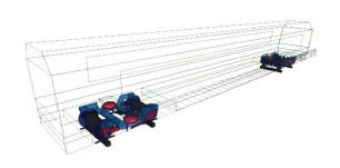
摘要: 低温环境对高速动车组动力学性能影响显著,需要 掌握低温下的车辆参数变化范围,针对-40 ℃或极低温工 况鲜有研究。基于悬挂元件低温特性试验结果,建立高寒 动车组非线性动力学仿真模型,并将常温环境下的动力学 仿真结果与线路试验结果进行对比验证; 将车辆系统悬挂 参数、轮轨匹配、轮轨界面参数考虑为正态随机分布,采 用拉丁超立方采样方法组合得到 300 种计算工况, 仿真研 究高寒动车组在-40 ℃低温环境运行时的动力学性能。 300 km/h 速度条件下, 车辆运行稳定性和安全性能满足标 准要求,但新镟修车轮在直线运行工况下的横向平稳性较 常温环境下差,主要是由于车辆发生了横向低频晃动;低 温引起橡胶元件和减振器的刚度和阻尼增大,导致在与车 体上心滚摆接近的频率范围内, 前后转向架同向蛇行运动 的阻尼比降低,引发以车体滚摆为主的横向晃动,因此高 寒动车组需要注意预防新镟轮后的车体晃动现象。为低温 环境下的高速动车组悬挂参数使用范围和动力学性能设 计提供了参考。
