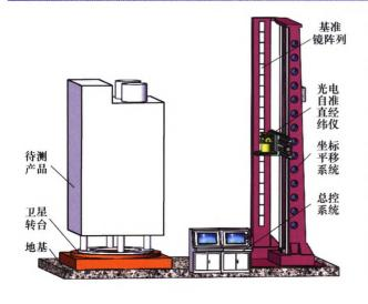
摘要:针对星上敏感器测量坐标系高精度标定的需求,提出一种空间矢量自准直测量方法,采用光电自准直经纬仪、卫星转台、基准镜阵列和坐标平移系统等,实现立方镜镜面法向矢量之间夹角的高精度自动化测量。给出空间角测量模型,基于误差传播原理推导出误差模型,并证明不确定度上限;仿真分析传感器精度对空间角测量误差的灵敏度,并在此基础上进行误差分配;设计并研制星上敏感器空间矢量自准直测量系统,对光电自准直经纬仪的转角精度、两轴垂直度和整个系统的空间角测量精度等进行试验标定;结果表明,光电自准直经纬仪转角精度优于0.6″、两轴垂直度优于0.2″,空间角测量精度优于3″,验证所提出方法的有效性、误差分配的合理性和设计方案的可行性,可为高精度星上敏感器的自动化测量标定系统的开发和应用提供参考。
