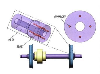
摘要: 疲劳 S-N 曲线是高速动车组结构设计中最重要的基 础数据。降低样本数据的离散性和提高寿命预测的准确性 一直是铁路车辆结构长寿命安全可靠服役的热点研究课 题, 经典的样本信息聚集原理(Sample polymerization principle, SPP)能够确保小样本疲劳数据统计处理的准确 性,但在寿命估算的可靠性上还有改进空间。通过参数搜 索的优化建立应力与标准差之间的关系,实现不同应力水 平下标准差的最优取值,从而提出一种新的基于 SPP 的概 率疲劳 S-N 曲线拟合方法。研究结果表明,与成组法相比, 基于(X-x-x-x)型数据的疲劳 P-S-N 曲线的斜率和截距的相 对误差小于 3%, 估算寿命仅为成组法 5%; 在处理(x-x-x-x) 型数据时,估算寿命约为传统方法的0.1%。在应用于高速 列车焊接结构时, 改进方法充分考虑了因焊接缺陷引入的 离散性,预测的疲劳寿命更加可靠与合理。由此可见,改 讲的 SPP 以及标准差参数寻优技术不仅可以确保小样本数 据的拟合精度,而且能够获得更加可靠的疲劳 P-S-N 曲线, 工程应用中得到更保守的预测结果。
