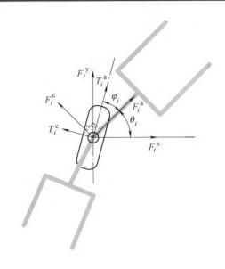
摘要:汽车列车具有容量大、单程车流运送率高等优点,可有效解决现有城市交通拥挤问题,以满足城市居民因工作与生活出行的乘车需求。但随着汽车列车长度的增加,车辆运动灵活度下降,汽车列车的操作难度增大,因此对汽车列车的转向控制方法进行研究。基于虚位移和虚功原理建立汽车列车的一般动力学方程,提出一种适用于该车型的多轴协同转向控制方法,并构建 Lyapunov 函数,采用 Lyapunov 直接法证明汽车列车能够沿目标路线行驶。以3车厢4车轴的汽车列车为例,建立仿真模型,分别对阶跃路线、正弦路线进行跟踪控制,仿真结果证明提出的汽车列车多轴转向控制方法,能够控制汽车列车跟踪多种目标路线行驶。
