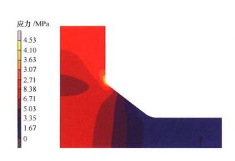
摘要: 针对低匹配焊接接头承载能力不足的问题,基于等承载思想建立等承载基本理论,通过定义广义匹配比和广义力学集中系数,提出广义力学集中系数与广义匹配比相等为等承载的实现条件。构建等承载设计的一般方法:明确接头失效形式,确定目标失效模式;确定接头危险位置;构建承载能力与几何参数、材料力学性能关系式;分别求解焊缝临界曲线并取包络线。以承受静拉伸的T型接头为例验证了以上方法的可行性:失效形式为静载断裂,按照全面屈服(焊缝)断裂模式进行设计,给出明确的实现条件;建立理论应力集中系数与几何参数的关系式;结合T型接头几何特点给出求解步骤;建立等承载T型接头弹塑性有限元模型,接头的断裂模式为全面屈服(焊缝)断裂,承载能力达到了母材的屈服水平。结果表明等承载基本理论和方法具有一定的普适性,能为更多的焊接接头等承载设计问题提供解决方案。
