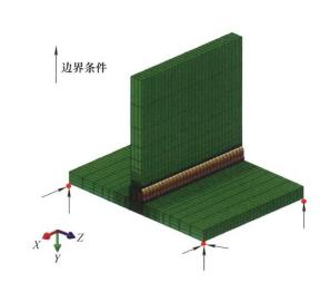
摘要: 以 Q390 高强钢厚板多层多道焊 T 型接头为研究对象, 分别基于 ABAQUS、MARC 和 SYSWELD 三款不同的有限 元软件平台,开发"热-弹-塑性有限元方法"模拟接头的焊 接温度场、残余应力与焊接变形。采用理论方法检验三种数 值模拟软件在计算焊接温度场时的热量损失情况。结果表 明,通过 ABAQUS 软件进行多层多道焊温度场的计算时, 在后续焊道单元的添加和激活过程中,会造成热量的损失, 对此提出了相应的解决方案; 另外两个软件对焊接温度场 的计算不存在热量损失问题。同时,采用试验方法实测接 头的焊接残余应力和焊接变形。通过对比数值模拟结果与 试验结果可知,三种不同的数值模拟软件对焊接残余应力 都有较高的预测精度。对于焊接变形, ABAQUS 的预测精 度最高,然而计算时间最长; MARC 次之,与 ABAQUS 相比计算效率提高了 55%; SYSWELD 对多层多道焊焊接 变形的预测精度相对较差,但其计算效率最高,与ABAQUS 相比效率提高了 66%。为充分利用各个软件的优势进行焊 接数值模拟的研究提供了较好的借鉴和参考价值。
