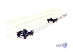
摘要:目前国内对于轨道车辆扭曲试验无论是开展现场试验还是进行仿真计算都没有成熟的经验,通过对比不同扭曲试验标准表明了出口铁路客车扭曲试验标准明显严苛。利用SIMPACK软件针对某型出口客车进行动力学建模,并依据试验标准进行了扭曲试验仿真计算,同时开展现场扭曲试验进行仿真计算结果验证。无论仿真计算还是现场试验结果均表明原有动力学参数的扭曲试验结果远超出试验标准的规定值。利用试验设计DOE方法调查了上千种不同动力学参数组合下对扭曲试验结果的影响,获得了动力学关键参数对于车辆扭曲试验的影响度,并基于各种不同参数的影响度重新优化了动力学参数。结果表明,所提出的车辆扭曲试验仿真计算流程弥补了仿真方面的不足,另一方面动力学参数影响度可以为企业产品设计提供理论依据,保证了出口车辆扭曲试验的通过性。
