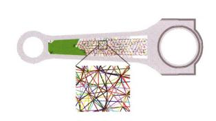
摘要:点阵材料是一种超轻高强的高性能多孔材料,目前主要以等密度构建点阵结构体。在实际情况下,点阵材料的各部分承受着不同的载荷,等密度点阵材料存在性能不能充分发挥的问题。针对上述问题,将拓扑优化引入点阵材料设计中,提出一种基于均匀化方法的多尺度拓扑优化方法,实现了变密度点阵结构体的优化设计,可根据实际载荷设计出最优的变密度点阵结构体,以达到最优性能。以汽车连杆为例,与现有商业软件 HyperWorks 采用的梁模型点阵优化方法进行对比验证。结果表明,所提出方法优化所得连杆的轻量化效果更好,应力分布更合理。该方法生成的变密度点阵结构有着更优异的性能,更适合变密度点阵结构体的优化设计。
