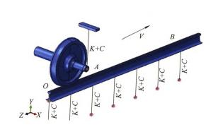
摘要: 轨道短波不平顺是引起轨道-车辆系统高频振动的主要根源,造成轮轨之间剧烈的相互作用力。利用 ABAQUS 计算软件显式模块建立的轮轨接触有限元模型,用于求解车辆高速运行时轨道短波不平顺作用条件下的高频轮轨接触力。该模型采用轮轨的真实形状建模,并且可引入任意形状的轨道短波不平顺及轨道状态参数。以某高铁线路上实测轨道短波不平顺作为输入,接触模型仿真输出的轮轨垂向力与高速综合检测列车在对应区段上实测轮轨垂向力数据之间的相关系数为 0.82,验证了所建模型的正确性。利用高频轮轨模型计算不同速度条件下不同参数的余弦型轨道短波不平顺引起的动态轮轨垂向力,对比分析计算结果表明: 动态轮轨垂向力不仅与轨道短波不平顺的幅值有关,还车辆与轨道短波不平顺波长敏感程度有关,在车辆运行速度不低于 200 km/h 的条件下,车辆对轨道短波不平顺的敏感波长分布在 100~200 mm。
