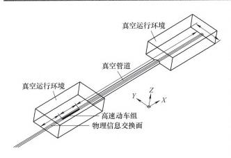
摘要:高速铁路进一步提速会面临巨大能耗、气动噪声和横风失稳等问题,构建真空环境形成管道运输可以很好地解决以上运营问题。依据最小空间尺寸计算克努森数判断真空管道内流体流动状态,考虑三维非定常可压缩效应建立列车和真空管道耦合的真空空气动力学计算模型,分析列车运行速度、真空管道真空度、阻塞比和环境温度对列车气动阻力的影响。研究表明,列车运行气动阻力与运行速度成抛物线递增关系,与管道压力成线性递增关系,与阻塞比成线性递增关系,与环境温度成线性递增关系,列车运行速度越高,真空管道真空度越低,阻塞比越高,环境温度越高,列车运行气动阻力越大。研究成果为克努森数特征长度的取值、真空管道内流体流动状态的判断、真空空气动力学数值计算的开展和真空管道交通列车气动阻力的分析提供理论依据。
