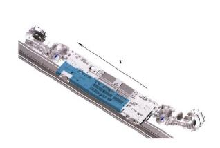
摘要: 为提高采煤机截割部行星架在复杂煤层赋存条件下的 工作可靠性,以"MG400/951-WD"型号采煤机为研究对象, 基于破煤理论,利用 Matlab 得到含坚硬夹矸的复杂煤层赋 存条件下采煤机螺旋滚筒的冲击载荷,结合刚柔耦合虚拟样 机技术建立以截割部行星架为柔性件的采煤机刚柔耦合虚 拟样机模型, 仿真发现了行星架应力集中区域。基于可靠性 灵敏度设计理论、可靠性稳健设计理论和性能退化理论,分 析行星架设计变量对渐变可靠性灵敏度的影响,构建行星架 多目标优化设计状态函数,利用改进粒子群算法,得到设计 变量最优解。结果表明, 优化后的行星架最大应力下降 56.388%,设计变量灵敏度趋于零,行星架关注区域更加稳 健,行星架可靠性得到提高。将刚柔耦合虚拟样机技术与可 靠性灵敏度设计理论、可靠性稳健设计理论、性能退化理论 和改进粒子群算法相结合,提出一种协同刚柔耦合虚拟样机 动态可靠性设计方法,对机械设备传动机构的可靠性分析与 设计具有重要工程应用价值。
