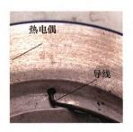
摘要:基于两相耦合的通风盘式制动器热力学研究方法与实际边界条件存在一定偏差。为提升制动器温度场和应力场的计算精度,综合运用紧耦合和松耦合算法,通过 MPCCI 数据交换平台实现 ABAQUS(固体模型)与 FLUENT(流体模型)求解器的同步迭代及耦合参数的实时共享,即温度场、应力场和空气流场的完全耦合运算,采用 Link3900 NVH 台架试验校验温度场计算结果。流体模型动区域采用滑移网格技术处理,湍流模型选择 RNG k-e 模型,边界层内的求解选用非平衡壁面函数法,确保第一层网格节点的 y+值在 30~60。根据通风盘端面和肋片结构设置不同方向的节点路径,得出耦合面温度、应力以及对流换热系数沿不同方向的变化规律。结果表明,对应节点的瞬态温度计算值与试验值表现出良好的匹配性,平均偏差低于 4%。该研究方案可有效地保证整体模型的计算精度和效率,为通风盘式制动器的优化设计提供重要的依据。
