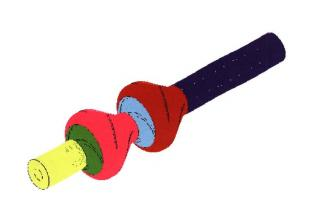
摘要:为分析固相浓度对深海采矿矿浆泵空化特性的影响,通过空化核子理论、质能方程建立气相和液相、固相和液相之间的联系,探求气固两相之间的理论关系,进行固相参数对深海采矿矿浆泵空化性能影响分析,并采用 mixture 多相流模型,RNG k- $\epsilon$ -湍流模型,Schnerr and Sauer 空化模型,在fluent 软件中对矿浆泵进行稳态空化仿真。比较不同颗粒浓度对矿浆泵流场压力分布、气相分布及工作性能的影响,为矿浆泵空化特性提供依据。研究结果表明:空化发生时的临界气泡半径与固相浓度及其流量可通过液体压强建立联系,固相颗粒浓度越大、固相流量越大,空化将提前发生,抗空化性能将下降;随着固相浓度的增加,在矿浆泵首级叶轮叶片背面入口处压力降幅增大,气相体积分数增大,泵扬程减小,汽蚀余量减小。
