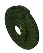
摘要: 汽车制动盘的工作温度高、易产生热疲劳, 其性能直 接影响行车安全, 对高温下制动盘的热疲劳裂纹萌生寿命的 研究十分必要。首先研究取自汽车制动盘上的灰铸铁 HT200 试样在 500 ℃下单调拉伸与压缩的性能,对应力—应变曲线 进行分析,得到其力学性能参数;接着基于这些参数,对初 始温度为 400 ℃时的制动盘在单次紧急制动工况下进行热-结构耦合仿真分析,得到制动盘的温度场和应力场分布:最 后利用应变疲劳的方法根据 Miner 线性累积损伤理论研究 500 ℃下灰铸铁 HT200 的塑性特性对制动盘热疲劳裂纹萌 生寿命的影响。研究结果表明:制动过程中的热应力远大于 机械应力,是产生疲劳裂纹的主要原因;高温下制动盘材料 HT200 的塑性特性对制动盘热疲劳裂纹萌生寿命的影响很 大,在研究制动盘裂纹萌生寿命时需考虑高温下塑性特性对 寿命的影响。利用制动盘在高温制动过程中的周向应变并考 虑高温下材料的塑性特性计算热疲劳裂纹萌生寿命,为制动 盘热疲劳寿命的评价打下基础。
