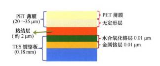
摘要: 覆膜铁具有更好的节约资源能源和绿色环保安全的性 能,可替代镀锡板等包装用材,是正在研发中的新型金属包 装材料。针对国内覆膜铁研发需求,从覆膜工艺、膜铁结合 机理、覆膜质量评价与控制、基材表面预处理及膜表面改性 等方面概括梳理国内外关于覆膜铁覆膜理论与技术的研究进 展,指出膜与基材接触区温度场是决定界面连接乃至覆膜质 量和速度的关键,实现覆膜区温度场稳定、控制界面空洞缺 陷与膜内再结晶缺陷、减小横向与纵向膜厚波动是提高覆膜 质量和效率的关键;提出从膜铁结合强度、膜厚均匀性、膜 结晶率、塑性成形加工性能等不同角度对覆膜质量进行全面 评价; 建议精细研究接触区热行为和聚合物膜熔融及凝固过 程,从细观尺度研究熔融膜在基材粗糙表面受辊压作用流动、 铺展、湿润、填充行为,从微观尺度研究膜铁化学反应键合 与聚合物再结晶;提出借鉴板形和厚度的控制理论与技术及 其研究方法,包括借鉴轧机颤振问题研究考虑覆膜辊系动力 学特性, 研究横向和纵向膜厚控制方法及技术。相关分析及 建议有助于覆膜理论与技术的创新研究。
