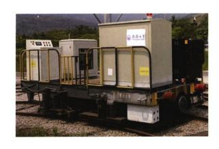
摘要: 将对称式机械差速器应用于独立旋转轮对轨道车辆, 作为左右车轮差速运行的被动控制装置。在动力学分析的 基础上建立机械差速器耦合轮对轨道车辆模型和对比模 型,包括刚性轮对车辆和独立旋转轮对轨道车辆模型。通 过仿真计算,对比研究了机械差速器耦合轮对轨道车辆和 另外两种车辆在曲线和直线上的导向性能,曲线通过安全 性及轮轨磨耗性能。研究结果表明, 在机械差速器的耦合 作用下,独立旋转轮对恢复了纵向蠕滑力和直线上运行的 复位对中能力,解决了独立旋转轮对车辆导向能力较差的 问题。同时,和刚性轮对车辆相比,机械差速器耦合轮对 轨道车辆在通过小半径曲线时, 有更好的安全性、导向性 能和轮轨磨耗性能。但由于纵向蠕滑力不足,在中等半径 的曲线上,机械差速器耦合轮对轨道车辆的动力学性能比 刚性轮对车辆稍差。总的来看, 机械差速轨道车辆解决了 独立旋转轮对车辆的导向及安全性问题,并且在极小半径 的曲线上运行时有较好的动力学性能,这种特性有利于其 在城市地面轨道交通中应用。
