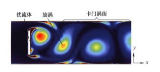
摘要: 为满足管道流体监测系统的自供电需求,针对流速/向恒定、空间有限的管道流环境下压电振子的有效激励问题,提出一种脱涡纵振式压电管道气流俘能器。介绍了其系统构成及工作原理,并进行了理论和试验研究,证明了其结构原理的可行性。研究结果表明: 平均阻力随流速/直径比增长呈二次方关系,平均阻力过大时会减小压电振子振幅,平均阻力系数随直径比上升先增加最终达到固定值(6.23); 其他参数确定时,分别存在最佳流速和最佳直径比使输出电压最大,外接电阻为 240 kΩ,流速为 32 m/s,直径比为 0.93 时,试验测得最大输出功率为 1.25 mW,应根据实际流速范围确定合理的直径比及负载以提高俘能器的输出功率,低流速时适当增大直径比、高流速时适当减小直径比有助于提高发电能力。
