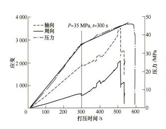
摘要: 基于超声导波的压力容器健康监测研究的第三部 分,主要考察所研究的健康监测技术在纤维缠绕压力容器 损伤定位中的应用。开展纤维缠绕压力容器的疲劳和打压 爆破试验,设计远程在线监测系统以实时获取不同工况中 纤维缠绕压力容器损伤定位结果。在打压和疲劳试验过程 中,采集压力容器在不同状态中的导波信号,并分别测量 金属内胆和复合材料层的应变变化,建立导波幅值与压力 容器疲劳状态和受压状态之间的关联。开展纤维缠绕压力 容器在打压爆破过程中的损伤定位,研究疲劳对损伤定位 精度的影响规律。结果表明,在疲劳试验中,应变片能够 连续记录并反映压力容器的应变状态,但疲劳周期随残余 应变的变化趋势不明显,而导波幅值随疲劳周次的增加而 线性下降;对经过5700周疲劳和未经过疲劳的纤维缠绕 压力容器,导波幅值随着其内部压力的增加而线性下降, 而应变值随着压力的增加线性增加,二者的对应关系可用 于判定纤维缠绕压力容器的受压状态; 利用所研发的在线 监测系统可以远程获取纤维缠绕压力容器损伤位置信息, 5 700 周的疲劳在很大程度上影响定位精度,而未经疲劳 试验的压力容器的损伤定位误差较小。
