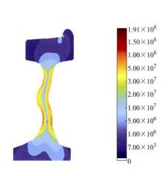
摘要:城市轨道车轮的结构优化大多集中于参数优化,设计 空间普遍有一定的局限性。以降低城市轨道车轮辐板处的结 构应力为目标,利用双向渐进结构优化算法对直辐板车轮进 行拓扑优化建模,提出一种新颖的城市轨道车轮辐板结构。 重点针对城市轨道车轮受力最恶劣的曲线工况,对直辐板车 轮的设计域进行 2D 拓扑设计,在满足体积约束条件下,通 过对删除率、进化率、增加率进行设定,使体积比经过反复 振荡从而达到较好的性能优化指标, 提高了城市轨道车轮的 应力性能,获得了城市轨道车轮的优秀拓扑结构。通过与成 熟有限元软件计算结果对比, 优化后的静强度和疲劳强度均 满足要求,证明了双向渐进结构优化算法的有效性和可靠 性。研究结果表明,双向渐进结构优化算法对城市轨道车轮 的优化设计是适用的; 优化车轮的辐板形式由直辐板进化为 曲辐板,且单元向中间圆弧处靠拢,辐板具有不等厚特征; 在不增加车轮重量的前提下,优化车轮在辐板处的最大结构 应力降低了17%。所做工作对城市轨道车轮结构应力性能的 提升具有重要的参考价值。
