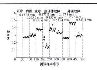
摘要:针对机械设备缺少故障样本时如何高效检测其异常度问题,在分析训练样本的分布情况以及其在自己空间边界状态的基础上,优化训练样本半径,提出一种变径边界样本界面检测器。利用变径边界样本界面检测器异常检测方法分析了轴承状态数据,不仅能反映出轴承的各种故障状态,而且能通过异常度函数反映出故障的轻重程度。变径边界样本界面检测器的设备异常度检测方法,是在学习设备正常运行数据的基础上,优化训练样本半径,利用边界样本及其方位信息,构建界面检测器,对设备的运行状态进行检测。变径边界样本界面检测器在构建过程中不需要使用设备的故障数据,适用于对缺少故障数据的机械设备进行异常状态检测。
