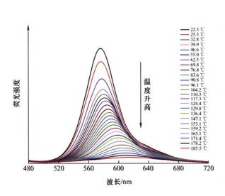
摘要: 航空发动机支撑轴承的内圈、保持架等旋转部件的温升特性在线监测对于轴承乃至整机装备的服役状态评估、预警至关重要。面向航空发动机极端工况下轴承内部旋转部件热状态监测需求,在基于碲化镉(Cadmium telluride, CdTe)量子点传感器在线测温原理及技术研究基础上,通过工艺优化提升传感器性能,使其适用于高温、高速等极端工况下航空发动机支撑轴承旋转部件的运行温度监测。控制制备 CdTe 量子点试验条件(制备时间、配体),通过结构表征探讨量子点的微观形态、平均粒径对其荧光特性的影响机制。搭建高温环境下量子点光致发光温度依赖特性监测试验平台,研究不同量子点传感器光致发光光谱的温度依赖特性及耐高温性能。基于聚乙烯醇(Polyvinyl alcohol, PVA)包覆,制备了 CdTe/PVA 高稳定性传感器,实现了量子点荧光强度、最高耐受温度、灵敏性以及稳定性的显著提升,为航空发动机支撑轴承旋转部件的在线温度监测奠定了基础。
