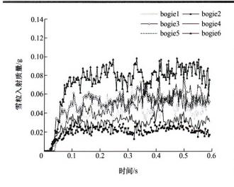
摘要:高速列车在风雪等极端环境下的运行性能日益被人们关注,而雪粒在列车转向架区域堆积会影响列车的行车安全。基于非定常雷诺平均 Navier-Stokes 方程和欧拉-拉格朗日多相流模型,将雪粒视为球形颗粒,采用三车编组形式,研究雪粒进入转向架区域的途径,并研究雪粒密度和直径变化对转向架区域雪粒堆积的影响。研究结果表明,大部分雪粒是从列车底部进入转向架区域的。随着雪粒直径部度的增加,大部分转向架的雪粒堆积量减少。而位于头车一位端转向架的雪粒堆积量增加,这是由头车一位端转向架区域流场和几何结构复杂所导致的。雪粒较易堆积在转向架的构架、制动系统和驱动系统上。而且随着雪粒直径或密度的增加,这些部位上的积雪量占转向架积雪总量的比例越来越大。
