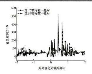
摘要:为研究大秦线路上列车车轮型面演变对固定辙叉动力学性能的影响,建立重载列车-辙叉动力学模型,分析重载列车通过固定辙叉的动力学性能和磨耗规律。结果表明,车轮通过理论尖端后,滚动圆半径不断变化使得轮叉接触点线速度发生改变,轮叉间滚动与滑动摩擦并存,对翼轨磨损较大;不同车轮对心轨冲击位置相对集中,心轨该区段伤损严重;车轮演变使轮叉接触状态发生变化,磨耗初期车轮的列车动力学性能优于标准车轮,列车平顺性更好,磨耗初期机车与货车轮叉垂向力较标准车轮分别降低了39%和56%,该磨耗阶段车轮与辙叉匹配时,辙叉的磨损最轻微。随着车轮型面演变,车轮磨耗加深,列车动力学性能逐渐恶化,磨耗后期车轮对辙叉磨耗掉块伤损的影响最剧烈。
