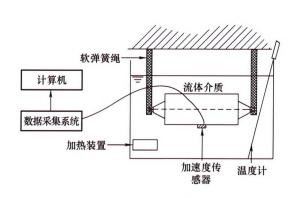
摘要:为准确分析不同流体介质中沉没辊模型附加质量和附加阻尼的变化规律,建立理论计算分析模型,对 4 种模型在 4 种流体中进行模态试验。利用锤击法,分别对加杆和不加杆的沉没辊模型进行空气中模态试验,两者结果一致性较高。加杆沉没辊模型的试验结果分析可知,水和液压油中前六阶的频响函数曲线峰值明显,甘油中仅前三阶明显;甘油的黏度变化对模型固有频率的影响较小,但随其黏度的增大其附加阻尼因数增加;随着液体密度增加,模型各阶振型对应的附加质量因数均呈线性增加,且当结构的质量和刚度增大时,其增加的斜率减小;随着结构密度增大,模型附加质量因数减小;所有模型(1,2)和(2,2)振型的附加质量因数大于弯曲振型。
