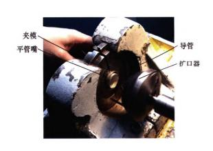
摘要: 航空扩口导管的轴向收缩量是影响管路装配质量的重要因素,对于扩口段轴向长度不合格的管件,只能凭工人经验现场调整。常用的有限元法需多次模拟才可求得轴向收缩量,效率较低。自主开发扩口管一步逆成形程序,提出径向投影法获得初始解,并采用网格光顺算法提高初始解精度,经全量理论的塑性迭代获取初始管坯尺寸,从而在几秒内快速预测出精确的轴向收缩量,为设计阶段管坯尺寸的确定提供依据。将扩口管一步逆成形程序的轴向收缩量预测过程与商用有限元软件 LS-DYNA、Abaqus 对比,一步逆成形程序极大地简化了前处理操作,提高了计算效率。选取多个不同规格的典型航空用导管进行冲压扩口成形试验,一步逆成形程序模拟量相对于试验值的误差在 6.33%以内。扩口管一步逆成形程序计算速度快,求解精度高,可准确预测扩口管轴向收缩量,具有工程应用意义。
