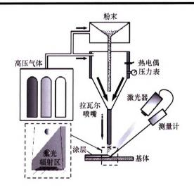
摘要: 针对纯铜具有良好的导电、导热和加工性能,但同时也具有硬度低,耐磨性能差的特点。采用超音速激光沉积 (Supersonic laser deposition,SLD)和冷喷涂(Cold spray,CS) 技术在纯铜表面制备了 WC/Cu 复合涂层,并对所制备涂层的微观结构、相组成、显微硬度和摩擦磨损性能进行了对比分析。研究结果表明,CS 涂层的厚度约为 1 128  $\mu$ m,WC 含量为 7.73%,显微硬度为 147.4  $HV_{0.2}$ ,但涂层/基体结合处存在明显间隙。SLD 涂层厚度随着激光功率的逐渐升高而增加,最高涂层厚度达 2 344  $\mu$ m,WC 含量可高达 17.22%,显微硬度可达 161.3  $HV_{0.2}$ ,且涂层/基体结合良好。SLD 涂层能基本保留原始粉末的相组成,但高激光功率下制备的样品存在轻微氧化。SLD 涂层相比于 CS 涂层和铜基体具有更小的摩擦因数、磨损宽度以及磨损量,表现出更好的耐磨性能,为铜及其合金的表面性能优化提供了一种新方法。
