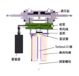
摘要:为能够准确预测超磁致伸缩电静液作动器(M-EHA)的动态输出特性,提出一种考虑流体体积模量和密度变化的非线性动力学建模方法。采用 Jiles-Atherton 磁滞模型对超磁致伸缩材料的本征非线性进行描述,并通过整流阀振动方程、流量方程、管路压降方程和液压缸动力学方程对流体整体传动特性进行建模。为研究流体体积模量和密度变化的影响,将流体有效体积模量处理为压力的函数,并结合电液模拟理论研究了管路中流体的可压缩性、惯性以及黏性对于M-EHA 输出性能的影响,最终建立了其非线性动力学模型。采用 4 阶龙格库塔法对模型进行迭代求解,并结合试验对比分析,研究了驱动频率、偏置压力以及负载与作动系统输出性能随驱动频率呈双峰变化趋势,且随着偏置压力增加,峰值频率上升,在 2.6 MPa 偏压时,达到最佳输出水平,为高性能 M-EHA的设计开发与优化奠定了理论基础。
