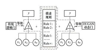
摘要:相对于 DUGAN 动态故障树分析方法,离散时间 T-S 动态故障树分析方法增强了故障树描述静、动态失效行为的 能力,且可以直接定量分析,但存在分析计算误差、且不能 反映系统可靠度变化趋势。为此,提出连续时间 T-S 动态故 障树分析方法。定义描述静、动态失效行为的连续时间 T-S 动态门,提出基于下级事件时序关系及事件发生冲激函数描 述与上级事件发生可能性的连续时间 T-S 动态门描述规则构 建方法,利用冲激函数冲激点的积分特性,进而提出基于描 述规则执行度与上级事件发生可能性及冲激函数积分的上 级事件故障概率密度函数和故障概率分布函数的分析计算 方法。所提连续时间 T-S 动态故障树分析方法具有相对于 DUGAN 动态故障树分析方法更强的失效行为描述能力,解 决了离散时间 T-S 动态故障树分析方法的分析计算误差问 题、且能反映系统故障概率变化。通过与基于 Markov 链、 离散时间贝叶斯网络、连续时间贝叶斯网络的 DUGAN 动态 故障树分析方法及离散时间 T-S 动态故障树分析方法进行对 比,验证了所提出的连续时间 T-S 动态故障树分析方法具有 可行性,且更有优势。
