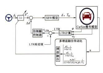
摘要:转向传动比是汽车操纵稳定性及主动安全性的重要影响因素,理想转向传动比忽略转向执行机构影响,仅考虑汽车单一运动稳定性,难以实现汽车主动转向防侧翻实际要求。考虑线控转向执行机构动力学特性,提出融合汽车横摆、横向及侧倾运动增益的线控转向传动比,设计多增益融合转向传动比的主动转向防侧翻控制策略。建立线控转向系统模型,分析线控转向系统动力学特性;由汽车系统动力学理论求解横摆运动、横向运动及侧倾运动的转向传动比增益,采用遗传算法进行不同工况的转向传动比优化,获得多增益融合线控转向传动比;根据典型工况汽车稳定性分析规律,设计多增益融合线控转向传动比的汽车主动转向防侧翻控制策略。实例仿真结果表明,多增益融合线控转向传动比能同时改善车辆低速转向灵活性和高速转向稳定性,设计的控制策略在绊倒型及非绊倒型工况均能够有效地防止汽车侧翻,减少控制器对驾驶员转向意图的干预。
