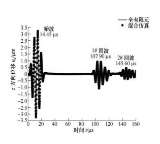
摘要: 金属小径管广泛应用于航空航天、化工等工程领域关键 结构中,对其进行定期无损检测至关重要。作为一种先进电磁 无损检测方法,电磁超声导波检测在金属小径管损伤定量评估 中具有优势。目前,金属管道缺陷电磁超声导波检测的仿真主 要采用有限元等数值模拟方法,涉及电磁场和结构场计算。然 而,电磁超声导波检测通常采用激励电流的频率为几百千赫兹, 在管道中激发的涡流趋肤深度极小,导致仿真需大量网格进行 求解域剖分以确保仿真精度,检测信号计算时间较长。鉴于此, 提出一种集成解析法和有限元法的金属小径管缺陷电磁超声导 波检测混合仿真方法,采用解析法求解电磁场相关场量,将所 求洛伦兹力导入有限元仿真中求解结构场,实现电磁场量和结 构场量的快速计算,高效求取检测信号,对金属小径管缺陷定 位时,精度高达约98%。在通过全有限元仿真验证所提混合仿 真方法正确性的基础上,结合系列仿真和试验研究,对所提导 波换能器激发的超声导波模态进行了识别,对该换能器在金属 小径管损伤检测和定位方面进行了可行性验证。
