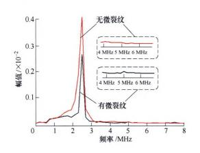
摘要:为了探索利用非线性表面波检测奥氏体不锈钢应力腐蚀早期损伤的方法,应用 ANSYS 和 ABAQUS 有限元数值模拟软件,基于弹塑性变形本构关系,采用重构的方法,实现应力场与超声场的耦合,进一步探讨恒应力状态下微裂纹的宽度与深度、受力方向(拉/压)与大小对非线性超声表面波传播特性的影响。结果表明,恒载荷作用下,微裂纹宽度与非线性系数呈负相关,深度与非线性系数呈正相关;拉应力作用下,微裂纹变宽,透射表面波能量降低,界面周期性振动引发的拍击和滑移效应减弱,抑制高次谐波的产生,而且微裂纹极限宽度随着拉应力的增大而减小;压应力的作用效果与之相反。所以非线性表面波与恒应力状态下微裂纹之间交互作用的研究对应力腐蚀早期损伤的检测有重要的工程应用价值。
