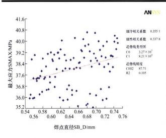
摘要:建立 BGA 无铅焊点再流焊焊后残余应力有限元分析模型,对其进行热结构耦合条件下的焊后残余应力分析;基于钻孔应变法设计并完成了焊后残余应力测量验证性试验;基于灵敏度法分析焊点高度、焊点直径、焊盘直径和焊点间距对焊点残余应力影响显著性及大小排序;以对残余应力影响显著的因素为变量,采用响应面-遗传算法对焊点结构参数进行了优化。结果表明,验证试验结果证明了仿真分析结果的有效性;置信度为90%时,焊点直径、焊点间距和焊点高度对焊点残余应力影响显著,灵敏度从大到小排序为焊点直径>焊点间距>焊点高度;焊点焊后残余应力最小的最优结构参数水平组合如下:焊点直径 0.55 mm、焊点高度0.36 mm、焊点间距 1.07 mm;对该焊点仿真验证表明最大焊后残余应力下降了 0.998 MPa。研究结果对减小 BGA 焊点焊后残余应力具有一定的指导意义和参考价值。
