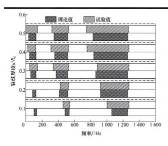
摘要:转轴不同的受力条件使裂纹具有不同的裂纹模式,在利用弹性波传播特性对横向裂纹进行检测时需要考虑裂纹模式的影响。在不同裂纹模式下推导得出裂纹的局部柔度系数,随后建立不同的裂纹模式下弹性波的传递矩阵,搭建转轴裂纹试验台,分析出其裂纹模式为模式 III,同时定性分析裂纹深度对转轴中弹性波传播特性的影响。试验结果验证了理论分析出的裂纹模式的正确性,而裂纹深度主要影响弹性波阻带带宽和中心频率。研究结果可为变截面转轴裂纹模式的选取提供参考,也为横向裂纹的检测提供了一种方法。
