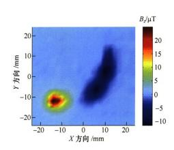
摘要: 奥氏体不锈钢具有良好的耐腐蚀性、高韧性和塑性, 在石化特种装备和海洋结构中有着广泛应用。奥氏体不锈钢 通常在高温、高压、强腐蚀介质中服役,结构表面可产生各 种类型不规则裂纹缺陷,威胁结构安全服役。由于不导磁、 弱导电、晶粒粗大的特性,传统无损检测对奥氏体不锈钢表 面不规则裂纹检测和评估存在诸多挑战。提出基于交流电磁 场检测(Alternating current field measurement, ACFM)技术的 奥氏体不锈钢不规则裂纹可视化重构方法,建立奥氏体不锈 钢不规则裂纹 ACFM 有限元仿真模型,分析不规则裂纹周 围电磁场畸变规律,提出垂直方向磁场(垂直于试块方向磁 场,称为  $B_z$ )图像梯度场的不规则裂纹表面轮廓可视化重构 方法,利用不规则裂纹检测试验验证可视化重构方法的效 果。结果表明,ACFM 探头感应电流可在奥氏体不锈钢不规 则裂纹端点聚集,聚集电流引起垂直方向磁场  $B_z$  畸变, $B_z$ 图像梯度场可反映电流聚集位置, B2图像梯度场可视化重构 方法能够实现奥氏体不锈钢不规则裂纹表面轮廓可视化成 像显示及精确评估。
