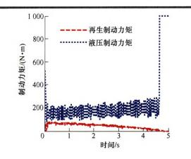
摘要:为提升再生制动系统能量回收效率以及平衡动力电池包中单体动力电池的性能差异,提出一种基于 BMS 的轮毂电机变压充电结构,并对变压充电再生制动控制方法进行深入研究。介绍基于 BMS 的轮毂电机变压充电结构组成方式以及变压充电再生制动控制方法的工作原理;在建立轮毂电机变压充电理论模型的基础上,探索轮毂电机电动汽车的变压充电再生制动控制规律;采用最小二乘法设计充电电压求取控制算法,并通过台架试验验证充电电压求取公式的拟合精度;通过 Matlab/Simulink 仿真,模拟在不同制动工况下采用再生-液压复合制动系统进行防抱死控制的仿真过程。结果表明,变压充电再生制动控制方法能够精确实施轮毂电机的再生制动行为。
