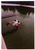
摘要:为避免自治型水下机器人-机械手系统(Autonomous underwater vehicle-manipulator system, AUVMS)的机械臂完全伸展引起振动冲击,提出一种基于虚拟工作空间约束的AUVMS 协调运动规划方法。利用机械臂灵活工作空间的子集组成的虚拟工作空间对机械臂的运动范围进行约束,通过软关节角运动范围处理运载器和机械臂之间的运动干涉,采用基于凸包射线检测算法判断机械手末端与虚拟工作空间之间的位置关系;推导AUVMS不同自运动状态所对应的运载器命令速度,实现虚拟工作空间内机械臂尽可能少的移动目标。仿真与试验结果表明,基于虚拟工作空间约束的AUVMS协调运动规划方法解决了机械臂出现完全伸展的问题,其轨迹跟踪精度相比加权最小范数法有着明显提高,位置误差保持在±0.04 m内,姿态误差保持在±3°内。
