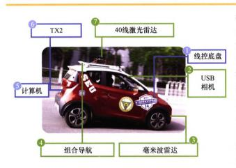
摘要:针对单一传感器感知维度不足、实时性差的问题,提出一种激光雷达与相机融合的城市自主车辆实时目标识别方法。建立两传感器间的坐标变换模型,实现两传感器的像素级匹配。改进 yolov3-tiny 算法,提高目标检测准确率。对激光雷达点进行体素网格滤波,根据点云坡度进行地面分割。建立聚类半径与距离作用模型,对非地面点云进行聚类。引入图像中包络的思想,获取目标三维边界框以及位姿信息;将视觉目标特征与激光雷达目标特征融合。试验结果表明,改进的 yolov3-tiny 算法对于城市密集目标具有更高的识别率,雷达算法能够完整的完成三维目标检测以及位姿估计,融合识别系统在准确率、实时性方面达到实际行驶要求。
