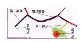
摘要:针对目前基于栅格地图的路径规划算法,机器人导航无法同时满足实时性与精确性要求,以及原始 Voronoi 图算法生成的全局路径过于臃肿和现有骨架提取的方式生成的路线过于冗余,导致过多占用机器人存储量的问题,提出一种改进的骨架提取算法,先对已知先验信息的栅格地图进行二值化、腐蚀、膨胀预处理,再生成全新的精简骨架,之后对每一次导航规划的路径进行基于改进的三次样条平滑处理,在此基础之上结合局部路径规划器 DWA 算法,实现机器人导航。通过多次仿真试验和真实环境试验,结果表明,利用所设计的算法得到的精简骨架比原始 Voronoi 图以及现有骨架更为简洁,优化之后的路径也更加平滑,提高了移动机器人运动的稳定性及移动效率,并以最安全的方式指导机器人移动。
