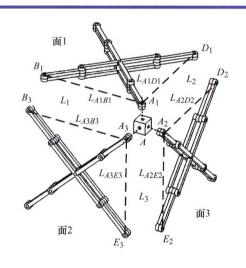
摘要:随着航空航天技术的飞速发展,大型空间折展机构的功能需求越来越多样化,具有多种展开模式的可重构可展机构应运而生。以可展立方体机构作为研究对象,介绍了其机构组成以及分层构造方法。通过分析立方体机构的相邻面单元间约束,绘制了面单元的机构简图,得到了面单元在正方形和长方形外轮廓下的几何约束条件。分析了三个相邻面单元的耦合运动情况,得到了三个面的可能运动模式,并在此基础上得到了立方体机构的可能运动模式。通过顶点连接、边连接、面连接,得到了两个立方体机构的组合机构,并开展了各种连接条件下的多模式分析。最后通过制作原理模型样机,搭建了边连接和面连接的立方体组合机构的典型构型,验证了理论分析的正确性。
