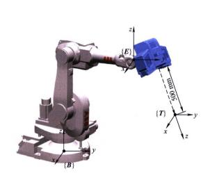
摘要:采用机器人在位光学检测系统实现法兰密封型面误 差检测与表面缺陷识别是解决核电现场人工检修可靠性 差、存在核辐射伤害等问题的有效途径,但如何在狭小空 间生成无干涉碰撞扫描测量路径、实现多次测量数据融合 与型面误差计算是目前面临的主要难题。为此设计了具有 6 自由度运动功能的机器人在位自动光学检测系统,单幅 测量范围 200 mm×160 mm~800 mm×640 mm、测量景 深 400~800 mm、机器人工作半径 1 200 mm, 研究了测 量系统手-眼标定矩阵计算与扫描位姿优化方法,并根据 法兰密封型面完整测量需求生成扫描工位与机器人运动 路径,提出面向法兰密封型面特定结构的测量数据融合与 型面误差计算方法,开发出具备机器人测量路径控制、大 规模测量点云预处理、三维匹配与色谱显示、型面误差计 算与技术报告输出等功能的 RobotScan 软件。按照德国 VDI/VDE 标准对机器人检测系统精度进行了验证,单球 直径、双球球心距的最大偏差小于 0.025 mm、平均偏差 小于 0.02 mm, 可满足核主泵复杂零件在位自动光学检测 应用需求。
