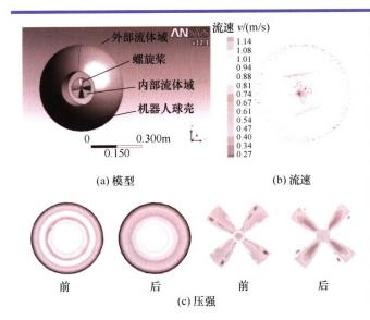
摘要: 面向水底信息获取和环境观测需求,基于球状壳体抵抗水压能力强,转动水阻力小,便于姿态控制特点,提出球形水底观测机器人构型,由螺旋桨推进、姿态调节和复合滚动装置组成欠驱动六自由度水下移动平台,球壳作为密闭舱保护内部电子器件,结合重摆以滚动形式实现水底滚动。通过对机器人流体力学仿真计算出水动力系数并建立水下动力学方程,进一步对机器人的螺旋桨推进、飞轮转向和球壳滚动进行分析,得出球壳优化尺寸以及飞轮匹配惯量和球壳滚动特性。基于球形机器人水下移动平台和地面监控软件的水底观测系统架构,研制出球形水底观测机器人原理样机,结合机器人的构型和运动特点制定出降落、滚动和调姿三段式水底运动观测策略,水池试验表明设计的球形水底观测机器人水中推进速度可达到 1.4 m/s,水底移动速度可达到 0.5 m/s,姿态调节速度可达到 30°/s,能够实现水底图像采集,辅助岸上科研人员执行水底观测任务。
