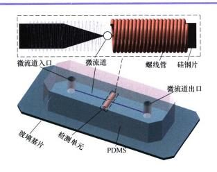
摘要:为丰富螺线管型传感器对液压油污染物的检测内容,提出并制作一种基于微流体芯片的对置螺线管型多功能检测传感器。理论推导了对置螺线管线圈的金属颗粒电感检测模型和非金属颗粒电容检测模型。为进一步提高检测灵敏度,试验对比分析了硅钢片对对置螺线管线圈的电感检测和电容检测的灵敏度。试验结果表明,硅钢片能够显著提升对置螺线管线圈的金属颗粒检测灵敏度,60~70 μm 铁颗粒和160~170 μm 铜颗粒的检测信噪比分别提升 127.44%、222.07%,也能提高对置螺线管线圈的非金属颗粒检测灵敏度,但不显著,140~150 μm 水滴和240~250 μm 气泡的检测信噪比分别提升 21.92%、7.95%。该研究对提高螺线管型传感器的液压油污染物检测能力提供了技术支撑,对液压系统健康状态监测以及故障诊断具有重要意义。
