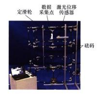
摘要:发展空间太阳能电站技术具有极其重要的战略意义,受运载火箭运输能力的限制,提出了一种可实现三维体展开的桁架机构作为空间太阳能电站的主结构。通过多方案对比分析,构建了可展桁架基本组成单元,在确定了驱动原理的基础上,进行了可展桁架运动学分析,验证了驱动方案的可行性。基于能量相等原理,建立了桁架连续梁等效模型,分析了运动学特性,并进行了参数优选。最后,研制了缩比原理样机,进行了展开试验、刚度测试试验及动力学试验。结果表明,该可展桁架具有较大的折展比及较轻的质量,铰链间隙是影响系统刚度的关键因素。
