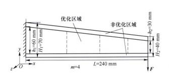
摘要:受外形尺寸限制,一些结构的优化区域无法划分为均匀一致的有限元网格。由此产生的单元体积依赖性,常规周期性拓扑优化无法求解。提出一种基于导重法的结构类周期性布局优化方法。以最小柔度为目标函数,结构质量为约束条件,构建结构类周期性布局优化的数学模型。利用导重法推导出结构类周期性布局优化的迭代准则,解释其物理意义并给出其优化流程。以单元应变能密度为基础,提出一种改进的过滤方案以解决结构类周期性布局优化中单元体积依赖性问题。利用所提出的方法,对循环对称结构、二维汽车轮毂结构和梯形结构进行结构类周期性布局优化研究。研究结果表明,子域数目不同时均可以得到具有类周期性布局的最优拓扑形式。通过性能指标和相对应变能两个指标来评价三个算例的最优拓扑形式,验证了利用导重法求解结构类周期性布局优化的可行性和有效性。
