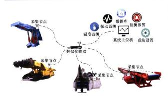
摘要:针对当下煤机设备状态监测系统时效性差、通信电缆铺设困难、需要定期更换电池等问题,提出了一种基于无线传感器网络与自供电技术的监测系统设计方法。系统由能量采集模块、无线传感器网络及监测上位机组成,通过能量采集模块收集煤机设备振动能量为节点电路供电,采用无线传感器网络与上位机实现设备关键状态信息的采集、传输与处理。测试结果表明,系统可在 30 m 有效范围内实现对煤机设备运行状态的实时监测,能量采集模块最大输出功率可达378 mW,能够有效收集设备振动能量实现系统能源自供给。
