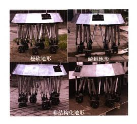
摘要:针对现有的机器人承载能力不足、复杂环境下适应能力弱以及运行速度慢等特点,创新性地提出了一种基于异形Stewart 平台的电动并联式六轮足机器人,该机器人集成了轮式运动与足式运动的优点,可实现轮式、足式以及轮足复合式运动。首先,对机器人的机械结构与控制系统进行设计,然后,为了实现在复杂环境下稳定的行走,足式上设计三足"对角步态"、"两足步态"和"单足步态"的稳定行走算法,实现了机器人稳定且匀速行走;设计了一种在足式步态中调整"支撑项"与"腾空项"占空比的控制算法,克服了足端与地面接触瞬间对机身整体速度带来的影响。轮式运动设计了6轮协同控制,具备6轮独立驱动、独立转向等功能。轮足复合式运动模式下具有变高度、变支撑面、变轮距等功能。通过对电动并联式六轮足机器人多种运动模式进行试验,结果验证了电动并联式六轮足机器人性能的优越性以及控制算法的有效性。
