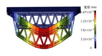
摘要:针对滚轮滑车悬吊式重力补偿装置运行阻力大、气浮支撑式补偿装置无法满足机构向气浮平台方向运动的问题,提出了基于龙门架式支撑结构与横、纵双向气浮导轨相结合的悬吊式重力补偿装置设计方案。采用多段拼接技术解决了超长纵向导轨生产与装调难题;采用在纵向导轨拼缝两侧增设节流孔的方法,提升了纵向滑车在拼缝处的运行平稳性;在纵向导轨上采用倒"V"形工作表面,解决了因外力未通过质心可能引起横向导轨运行偏转的问题;采用挤压成型中空铝型材与碳纤维增强梁相结合的方法实现了大跨距横向导轨的减重与抗弯刚度的提升。经分析与试验验证,在单个悬吊点处悬挂90kg负载,该装置最大运行阻力系数不超过0.037%,运行范围可达2m×20m,在速度不超过1m/s,加速度不超过0.3 m/s的使用条件下,具有良好的动态跟随能力,可满足太阳翼、天线等大型空间可展开机构地面展开试验与性能测试的需求。
