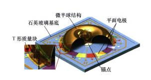
摘要:分析了微半球振动陀螺的装配误差形成机理,对装配精度要求进行了计算。在微半球结构锚点直径为1 mm 的情况下,要保证装配间隙均匀度小于10%,锚点面的高度偏差需要小于0.1 μm。通过数值计算和有限元模型,分别研究了装配误差对电极驱动能力、静态检测电容、静电刚度调节能力,以及1阶模态振型的影响。计算结果表明,电极间隙不均匀对检测、驱动和静电刚度修调能力的影响分别呈1、2、3次方关系,同时会引起微幅的结构偏摆。为提升电极装配间隙均匀性,设计了一种基于柔性缩小单元的微位移调节机构。该机构利用螺旋调节旋钮和柔性垫块,使石英玻璃基底产生2自由度微幅摆动,从而实现较高精度的装配。测试结果表明,微半球振动陀螺装配后平均电容误差约为30%~40%,但引入了较大的寄生电容,消除该影响后,电容平均误差为12%。
