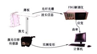
摘要:针对薄板变形重构问题,结合应变与曲率、曲线与曲率的关系,提出了一种带误差补偿的曲率积分递推算法。根据累计误差的特点,给出了误差补偿系数的选取方法,以及误差补偿因子的优化原则,通过选取合适的补偿因子,获得一组与补偿因子相对应的补偿系数。建立 600×200×2.45 mm 的铝合金薄板模型,通过仿真和实验分析,提取薄板上一条变形曲线的分布应变数据和变形数据,采用带误差补偿的曲率积分递推算法对试验数据进行重构,并引入均方根误差(Root mean square error, RMSE)评判算法在不同分段数和不同载荷情况下的重构精度。结果表明,提出的带误差补偿的变形重构算法可以精确地重构薄板的变形曲线,重构误差及相对误差均比较小。并且在载荷相同的条件下,分段数越多,所提出的曲线重构算法的重构精度也越高。
