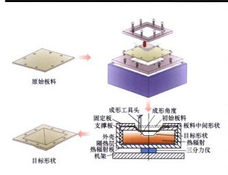
摘要:聚合物广泛应用于汽车、航空、医疗等领域,传统的聚合物加工方法只适用于产品的大批量生产,并不适用于产品的柔性化定制。常温条件下单点渐进成形方法难以满足聚合物板料复杂形状高成形性要求,为了实现聚合物的小批量、柔性化制造,得到成形精度、表面质量更好的产品,开发了桌面级热辅助单点渐进成形设备,首次提出了聚合物热辅助渐进成形方法。针对四种不同的高分子聚合物:聚碳酸酯(Polycarbonate,PC),聚醚醚酮(Polyetheretherketone,PEEK),聚甲基丙烯酸甲酯(Polymethylmethacrylate,PMMA),聚氯乙烯(Polyvinylchloride,PVC),通过螺旋刀具轨迹成形出金字塔形状,并对成形过程中的温度、成形力、几何精度及表面质量进行了分析。结果表明,热辅助渐进成形方法提高了聚合物板料的成形性,适用于个性化定制,柔性化成形聚合物板料零件。
