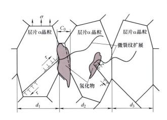
摘要: 钛合金焊接件在氢环境中服役面临着氢脆断裂风险,断裂韧度对钛合金损伤容限设计至关重要。研究了充氢量对钛合金焊接接头断裂韧度、断口形貌和断裂方式的影响,揭示了固溶氢、氢化物导致焊接接头断裂韧度演变的微观机理。 充氢  $0 \sim 0.21$  wt.% CT 试样断裂韧度  $K_Q$  值由 39.6 MPa·m<sup>1/2</sup>减小到 22.1 MPa·m<sup>1/2</sup>,扩展区断口形貌由大量韧窝+局部少量脆性断裂转为脆性断裂,氢致断裂韧度损失和脆性断裂加剧。应力诱导氢扩散使固溶氢局部富集形成富氢气团,气团存在内压剪切分量使产生局部塑性变形所需外应力下降,焊接接头表观屈服应力下降,促进微裂纹在低  $K_I$ 下孕育。位错运动无法直接切过大尺寸氢化物,位错塞积在氢化物界面处,致局部应力集中,微裂纹在氢化物界面处孕育;同时氢化物为软基体金属中的一种脆性相,应力集中致其产生高应变,氢化物自身断裂,微裂纹在氢化物内部孕育;固溶氢、氢化物均致焊接接头加速开裂。
