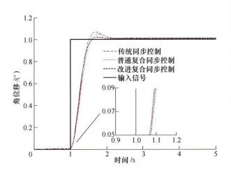
摘要:为提高双液压马达同步控制系统的同步控制精度,消除由于两组阀控马达系统的差异导致的同步误差,提出采用压力反馈的共反馈同步误差校正同步控制策略。同时采用一种改进的粒子群优化算法用于寻找同步控制系统的最优 PID 控制系数。这种改进的粒子群算法引入遗传算法中的交叉和变异操作提高传统粒子群算法的寻优性能。在考虑传动轴刚度的情况下,建立双液压马达同步控制系统的数学模型。进一步的仿真与试验结果表明,基于压力反馈的同步控制与改进的粒子群算法相结合的复合控制策略,能有效减小系统系统超调与同步控制误差,提升系统响应速度。研究成果为改善粒子群算法的寻优性能以及提升马达同步控制系统的动态响应性能与稳态精度提供了理论指导。
