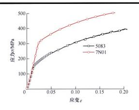
摘要:基于仪器化压入试验和有限元理论,建立考虑接头微区力学性能的热-电-力耦合的异种铝合金电阻点焊有限元模型,并用该模型模拟 5083 与 7N01 铝合金电阻点焊接头截面上的整体残余应力场分布。用金相显微镜、硬度测试仪和全释放应变法获得点焊接头的熔核形貌、硬度分布及上下表面的残余应力,探讨点焊前后微区力学性能变化对接头残余应力大小及分布的影响。试验结果表明,5083 与 7N01 铝合金进行电阻点焊后,熔核和热影响区材料发生软化,其硬度和流动应力与 7N01 母材相比明显降低。模拟结果表明,接头微区力学性能变化对残余应力分布规律的影响较小,对残余应力的峰值影响较大,熔核处于三向拉应力状态且熔核心部的残余应力最大。考虑微区力学性能的有限元模型计算得到的残余应力与试验测试结果一致,证明模型的有效性。
