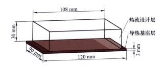
摘要:随着电子芯片的集成度越来越高,相应的热管理问题也愈加严峻,对热沉进行有效设计则成为一种很好的解决办法。采用变密度的拓扑优化方法对强制风冷热沉进行优化设计,建立由导热基座层和热流设计层组成的伪三维优化模型,并考虑更有实际意义的对流边界和利用 RAMP 法对热导率和对流传热系数进行插值;以压降最小化为优化目标,以空气吸收热 Q 最小值为 2 W 为热约束,分析三组基座温度  $T_b$ (314 K、330 K、350 K)下的优化结果。利用拉伸三维热沉的数值模拟验证伪三维优化模型的物理有效性。结果表明,基座温度  $T_b$ 升高过程中,翅片四周光滑度有所提升但表面积在缩小,占设计区域的比例分别为 18%、16%、14%;目标函数 $\phi$ 逐渐降低,分别为 0.073、0.036、0.025;设计区域内速度最大值逐渐变小但速度和温度分布更加均匀。三维热沉模拟结果中沿 Z 轴的速度和温度变化量很小,从而验证伪三维优化模型的物理有效性。
