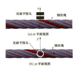
摘要:捻距作为钢丝绳重要参数之一,对其进行检测可间接反映钢丝绳受力状态和表面损伤状态。针对现有图像识别方法受限于外界光照及钢丝绳表面附着物覆盖情况、漏磁法需要磁化钢丝绳等问题,提出采用双扁平线圈差分电桥的钢丝绳捻距涡流检测方法。结合 Ar, V-Ar, 表述建立钢丝绳涡流响应分析控制方程,对单绳股涡流分布进行分析。探头正下方绳股表面涡流形成漩涡,绳股两侧曲面上涡流分布存在对称性。对扁平线圈的中径进行优化设计,当中径小于等于股间隙时,捻距检测精度高且检测灵敏度高,然后搭建试验平台进行捻距检测。试验结果与仿真均表明扫描信号中相邻波峰或者相邻波谷的间距为股间隙,一个捻距范围内扫描信号出现的波峰或者波谷数量与钢丝绳绳股数目相关。利用集合经验模态分解方法对试验结果进行后处理可以有效提取有用信号,涡流法得到钢丝绳捻距的相对误差不超过0.13%。
