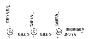
摘要:针对长贮装备服役退化后的可靠性和继续服役能力再认定问题(简称性能退化评估),总结归纳长贮装备的"状态退化性"、"环境突变性"、"使用一次性"、"后果要害性"等基本特点,分析长贮装备的退化行为与功能行为,提出描述其行为特性的退化行为方程和功能行为方程,基于确信可靠性理论和裕量可靠原则,给出功能行为能力和继续服役能力的基本测度,形成性能退化评估的理论基础,在此基础上建立进行性能退化评估的总体框架,包括健康状态与功能状态信息获取、裕量与不确定性量化、继续服役能力与功能行为能力的确信可靠性评估等。讨论性能退化评估涉及的退化行为机理、多场环境模拟、多不确定性量化等科学技术问题,分析性能退化评估理论与技术体系及其研究进展、发展趋势。
