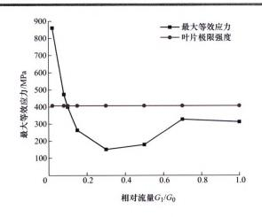
摘要: 在火电机组深度调峰工况下,汽轮机进汽量明显减少,低压缸甚至处于小流量工况下,严重威胁叶片的安全稳定运行。为了研究深度调峰工况下,叶片强度极限内最小流量确定的问题,利用 ANSYS-Workbench 软件对末级叶片进行流固耦合运算和模态分析。结果表明,最大等效应力与最大变形量所处位置不一致,最大等效应力出现在叶顶,最大变形量出现在叶片中部。随着流量的减小,最大等效应力和最大变形量呈先减小后增大的趋势。 $G_1/G_0=0.1$  时,最大等效应力为451.52 MPa,较额定工况时增加了 18.94%,最大变形量为0.725 74 mm,较额定工况时降低了 7.8%。 $G_1/G_0<0.1$  时,最大等效应力超出强度极限,不满足强度要求。随着流量的减小,叶片固有频率均能避开激振力频率,叶片不会发生共振。综合考虑应力、应变、频率、振型等强度因素,低压缸最小流量不得低于额定流量的 10%。
