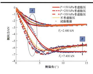
摘要:胎压的变化会显著地影响轮胎力学特性,进而影响车辆的操纵稳定性,而当前关于胎压对复合工况轮胎力学特性影响的研究还较为匮乏。为描述不同胎压下的复合工况轮胎力学特性,建立考虑胎压影响的 UniTire 复合工况轮胎模型。通过试验观察和理论模型分析相结合的方法,揭示胎压和载荷耦合效应对轮胎侧纵向滑移刚度等关键力学特性的影响规律及其机理。进一步通过分析胎压载荷耦合影响下复合工况轮胎接地印迹内总切力方向的变化规律,完善总切力方向因子表达式,建立考虑胎压载荷耦合影响的复合工况轮胎模型。利用轮胎试验数据对模型进行广泛验证,结果表明所建立的 UniTire 复合工况模型能精确地描述大范围胎压和载荷变化下的轮胎力学特性。
