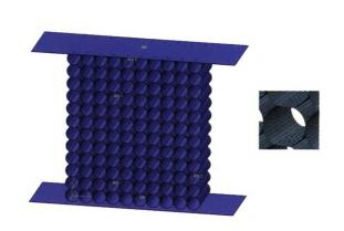
摘要:圆管蜂窝的制备是制约其发展和应用的一个关键问题。采用钎焊方法,设计钎焊工艺流程,制备铝圆管蜂窝材料,为蜂窝材料的生产提供了一种方法。对制备的蜂窝材料进行了准静态压缩试验,研究圆管的变形红海和力学响应。采用有限元对试验进行模拟,考虑钎焊焊和制备缺陷影响,建立圆管蜂窝的有限元模型,发现有限元模拟应力-应变曲线和变形过程与试验结果的影响不可忽略。在此基础上对对壁厚圆管蜂窝进行等的影响不可忽略。在此基础上对对壁厚圆管蜂窝进行等效弹性模量和塑性初始屈服应力的计算公式,等明考虑焊缝影响时解析解和模拟结果相近,都要高时增加,焊缝的影响作用增大。
