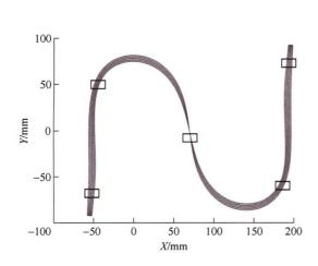
摘要: "S"形试件用于综合检测多轴机床的加工精度,但是由于"S"形试件理论切削误差的存在,导致多轴机床的精度检测产生偏差,因此,提出了一种有效减小理论切削误差的方法。基于双三次均匀 B 样条曲面模型建立了"S"形试件模型,获得了扭曲角在所选择的三条测量线上的分布规律,同时分析了扭曲角对"S"形试件理论切削误差的影响。此外,通过分析传统单点偏置方法的不足,提出了一种优化的单点偏置方法。基于此方法和 CAD/CAM 软件生成了"S"形试件的刀具轨迹。最后,通过试验验证了该方法的可行性。试验结果表明,基于优化的单点偏置方法产生的"S"形试件平均理论切削误差比传统的单点偏置方法降低了50.1%。此外,基于优化的单点偏置方法产生的理论切削误差近似小于0.005 mm,可以忽略不计。因此,所提出的方法可以有效地避免理论切削误差对多轴机床精度检测结果的干扰。该方法的核心思想可以直接应用到其他类型的检测试件。
