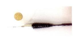
摘要:针对眼内显微手术过程中器械与组织器官之间作用力微小、不易感知,且过大的操作力会造成组织损伤甚至撕裂等问题,设计一种基于光纤布拉格光栅(FBG)的微力传感器。在建立 FBG 反馈波长变化与力的关系基础上,探讨了温度对波长变化的影响,提出了温度补偿方法。利用自行研制的微力传感器标定系统进行传感器标定试验(精度 0.42 mN)。将所研制的微力传感器集成到眼内手术镊末端,对离体猪眼球进行了连续环形撕囊操作试验。通过对 19 组数据分析,得到最大撕囊力的平均值为 22.43 mN。研究对眼科手术的精准操作和手术机器人进行微力控制奠定了基础。
