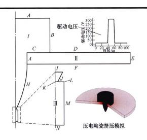
摘要:针对目前挤压管型压电式喷头结构复杂、组装工艺要求高及价格昂贵等问题,设计一种结构简化的环形压电陶瓷直接驱动喷射材料的微滴喷射装置。通过建立多物理场耦合压电式喷头微滴喷射两相流模型,研究驱动电压、流体黏度及表面张力等参数对微滴成形动力学行为的影响。在此基础上,利用构建的压电式喷头进行微滴喷射试验。结果表明:驱动电压幅值与产生微滴的速度及体积大小呈线性关系,喷射材料黏度增大产生的微滴喷射速度及体积减小,表面张力直接影响液滴形成过程的喷射材料液体丝带长度及断裂距离;采用喷嘴孔径为 65 μm 的喷头,在稳定喷射条件下,可按需产生直径约 80 μm 的均匀微滴,验证了设计的直接驱动式压电喷头按需产生均匀微滴的可行性。
