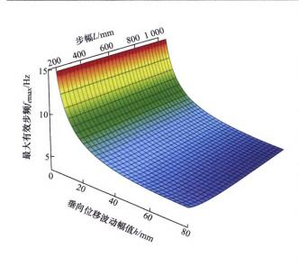
方法,用于补偿在行走过程中因闭链连杆机构的足端轨迹不可调整而导致的机身垂向位移波动,从而有效提高移动速度并提升驱动效率。首先,针对由曲柄驱动的闭链多足移动系统进行运动特性分析,获得机身垂向位移波动与最大有效步频之间的函数关系,确定机身垂向位移波动幅值为限制移动速度提升的关键因素。其次,采用矢量环路法建立并求解机械腿的运动学模型,基于反转法原理在小腿坐标系下构造与机身固定的虚拟地面,由运动周期内小腿位姿随曲柄相位的连续变化形成虚拟地面直线簇,求解包络线方程得到足地接触轮廓曲线。然后,根据轮廓曲线的补偿相位进行闭链多足移动系统的整机布置设计,并基于 ADAMS 软件进行垂向位移波动、行走速度和缓坡负重行走的动力学仿真分析。最后,设计制作原理样机并开展平地测速试验和缓坡负重行走试验,验证了应用所提足地接触轮廓曲线设计方法补偿机身垂向位移波动以提升行走速度和驱动效率的可行性。
