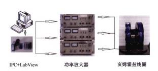
摘要:为实现微型机器人无缆驱动,设计一种基于磁弹性复合材料的磁控微型软体爬行机器人,通过三维亥姆霍兹线圈构建变换空间磁场,控制磁性材料产生磁力矩,并耦合机器人重力、摩擦力及自身的弹性变形,使得机器人实现多个连续的姿态变换,完成爬行动作。介绍微型软体爬行机器人结构和制作流程,建立机器人准静态力平衡方程,利用 Abaqus有限元仿真和试验对比分析了机器人弯曲变形、接触面摩擦、爬行步长、转向等运动特性,在此基础上建立机器人爬行动作的速度模型,研究控制信号频率与幅值对机器人爬行速度的影响,并最终实现爬行机器人的路径规划控制。试验和仿真结果表明,该机器人能实现在 xy 平面内任意方向的爬行动作,为进一步揭示磁控微型机器人的运动特性及规律奠定了基础。
