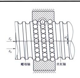
摘要:滚珠丝杠副是将旋转运动转换直线运动的精密驱动部件,对数控机床的传动精度有着重要影响。在外载荷作用下以往都是假定所有滚珠与滚道的接触载荷均匀一致的,忽略了各滚珠接触载荷的差异性,严重影响滚珠丝杠副定位误差补偿的准确性。为提高定位精度,提出一种全滚珠载荷分布模型,分析了在轴向载荷和径向载荷复合作用下所有滚珠动静态接触载荷分布状况。通过与有限元建模分析比较,验证模型的准确性。在此基础上分析了滚珠几何误差对滚珠动静态接触载荷分布的影响。基于全滚珠载荷分布模型和弹性变形理论,利用数值仿真获得复合载荷下滚珠丝杠副的位置偏差及位置跳动量变化情况。试验结果表明,提出的复合载荷作用下考虑滚珠几何误差的载荷分布模型,对提高滚珠丝杠副的位置精度预测及其定位误差补偿有较好的参考意义。
