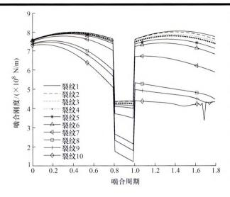
摘要: 齿轮系统在复杂的工况条件下,容易产生裂纹故障,对正常运转造成困难。时变啮合刚度作为齿轮传动系统重要内部激励之一,刚度的变化能够良好地反映齿轮的动力学响应,因此使用精确的刚度算法能够有效地进行齿轮系统动力学特征分析。考虑齿轮过渡曲线函数,通过分析完整的齿廓曲线,采用势能法计算齿轮时变啮合刚度,研究 10 种不同裂纹长度的刚度变化。考虑时变啮合刚度和齿间滑动摩擦,建立 6 自由度齿轮系统动力学模型,利用 Runge-Kutta 法仿真求解齿轮不同裂纹长度时的动力学响应。通过分析位移响应发现齿轮存在裂纹时会产生冲击特征,随着裂纹长度增加,冲击特征越来越明显。最后比较分析了多种统计指标随裂纹扩展程度的变化趋势,结果表明峭度指标对故障特征最为敏感。
