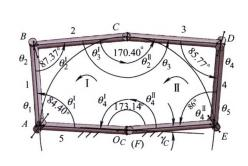
摘要:目前,5 杆和 6 杆 Goldberg 机构的闭环位移方程都是用相邻杆件外角表示的。为了能更清晰和直观地表达多杆Goldberg 机构相邻杆之间的角度关系,给出了用相邻杆件内角表示 5 杆和 6 杆 Goldberg 机构的位移方程。通过对 5 杆和 6 杆 Goldberg 机构的分析,提出了一种新的 7 杆 Goldberg 机构,给出了它的用相邻杆件内角表示的结构参数方程和闭环位移方程。通过实例验证了 7 杆 Goldberg 机构的闭环位移方程和输入输出方程的正确性。分析并给出了 7 杆 Goldberg 机构的存在条件:除了满足连杆和连架杆必要的 Bennett 约束条件之外,还必须满足不同虚拟环路的机架共线的条件。在理论上拓宽了 Goldberg 机构的概念和应用范围。
