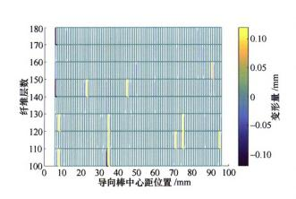
摘要:为实现三维结构复合材料的高质量成形,研究了复合材料柔性导向三维多针织造成形过程中导向阵列的变形特征。利用导向阵列边缘导向棒的中心距变化情况进行导向阵列变形特征研究,主要采用图像处理手段对中心距大小进行分析,从而获得不同织物高度条件下导向阵列中心距的变化特征,并对成形后复合材料预制体的成形精度和内部质量进行分析,建立了具有微变形的导向棒压实协调变形模型,探究导向阵列变形对预制体成形质量的影响。基于复合材料柔性导向三维多针织造成形工艺,导向阵列边缘导向棒中心距整体呈高斯分布,导向阵列变形的主要原因是导向棒自身的变形,且随织造过程进行,导向棒变形加剧。在进行导向棒选择和布置时,应选择初始变形小于 1.4 mm,变形区幅宽与变形区中心高度之比大于 0.845 的导向棒,有利于减小导向阵列变形情况,避免成形过程使导向棒进一步变形的可能。
