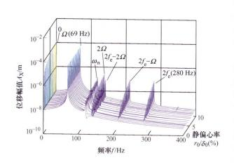
摘要:针对重力载荷下具有初始静偏心的动车牵引电机转子 振动特性,首先利用磁势乘磁导法和 Maxwell 应力张量法给 出了具有静动气隙偏心故障和任意磁极对数的电机空载/负 载运行下的不平衡磁拉力统一解析表达式,然后采用 Jeffcott 模型建立了不平衡磁拉力、机械不平衡力和重力共同作用下 的某型动车牵引电机转子系统动力学方程,并采用 Runge-Kutta 算法求解系统动力学响应,最后重点讨论了初 始静偏心和重力载荷对牵引电机转子轴心轨迹和位移频谱 的影响规律。结果表明:① 重力载荷对电机转子系统的影 响等价于在重力方向上施加一个恒定静偏心量,其与初始静 偏心的矢量叠加组成气隙的综合静偏心量;② 综合静偏心 量的大小和方向影响转子轴心轨迹的位置和方向, 偏心量越 大转子轴心轨迹的偏移距离也越大且偏移方向沿静偏心方 向;③ 静偏心量的增大使该型牵引电机转子轴心轨迹略微 增大,可以认为基本不变,同时,静偏心量增大也使转子位 移频谱成分更加显著和多样化。
