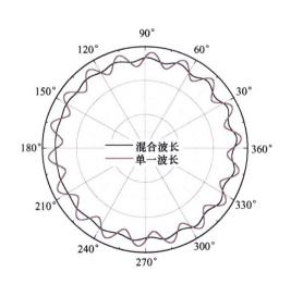
摘要: 列车车轮多边形磨耗问题广泛存在于我国高速列车 上,会显著增大轮轨之间的相互作用力,严重影响列车运行 安全性和舒适性, 其产生和发展机理值得探究。车轮多边形 磨耗与钢轨波浪形磨损(简称:波磨)从磨耗特征来看较为相 似,只是发生磨耗的载体不同,钢轨波磨是否对车轮多边形 磨耗存在根本的影响值得深入研究。以我国某线路上运行的 高速动车组列车为研究对象,通过建立车轮多边形磨耗仿真 预测模型,结合现场试验数据,调查钢轨波磨对车轮多边形 磨耗产生和发展的影响。研究表明, 钢轨波磨虽然可以导致 轮轨力和蠕滑率等磨耗关键参数沿车轮圆周发生周期性波 动,但是在车辆实际运营条件下,钢轨波磨导致车轮多边形 磨耗产生这一观点的成立条件极为"苛刻",对车轮和钢轨 波磨区段起始点的接触位置、钢轨波磨的波长以及车轮周长 都有严格的要求。在实际中该条件难以满足。因此,钢轨波 磨的存在并不是车轮多边形产生的根本原因。结果可为高速 列车车轮多边形形成机理的相关研究提供参考和指导。
