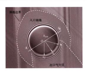
摘要:试验研究了异向卷吸作用对润滑剂回填增强效应和成膜特性的影响。采用球-盘点接触光干涉油膜测量仪,通过控制钢球运动方向产生卷吸速度与滑动速度呈夹角的异向卷吸作用。试验发现,限量供油条件下异向卷吸与同向卷吸相比,接触区入口供油状态得到明显改善,其特征是在入口区产生了与经典乏油工况不同的充盈油池,该油池的出现使油膜厚度接近于充分供油下油膜厚度。试验观察了不同角度、速度、供油量和黏度下的入口油池外形及非对称性油膜特征。接触副表面上侧带与滚道重叠并被卷吸到入口区,是入口油池形成的主要机制;热黏度楔效应是诱发油膜外形非对称性的原因;入口剪切热、侧泄、接触区热量向入口区迁移和剪稀效应,是润滑油膜厚度随角度减小的原因。试验结果表明,将经典的乏油边界条件应用于异向卷吸工况具有局限性。
