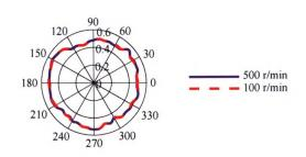
摘要:回转精度是衡量主轴加工性能的重要指标。现有的回转精度测量方法通常借助标准球并在空转条件下进行,无法计入切削载荷等负载带来的影响,难以反映主轴在切削状态下的真实精度。针对该问题,提出一种基于动力学模型的主轴回转精度动态预测方法。首先建立高保真的高速主轴-轴承系统动力学模型,并将切削力等激励载荷作为输入边界条件。然后利用测力仪测量、修正切削力,并将其输入动力学模型,实现主轴振动响应和径向回转误差的动态预测。设计并制作一套主轴回转误差在线测量装置,对回转精度预测结果进行试验验证。将不同切削工况下的仿真与试验结果进行对比分析,结果表明提出的方法能够准确预测主轴回转精度的变化规律,可以为主轴加工性能评估提供依据。
