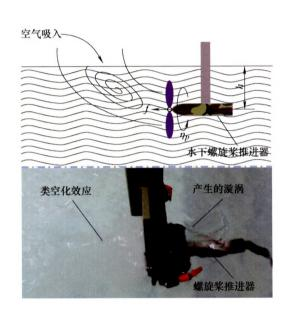
摘要:类空化效应是由于水下螺旋桨推进器近水面高速旋转时,在螺旋桨与水面之间形成漩涡,从而将空气吸入桨内导致推进器效率极大降低,引起推力损失和噪声的现象。螺旋桨推进器作为大多数水下机器人的唯一动力源,类空化效应的产生将极大影响机器人运动控制的稳定性。提出了一种基于高斯过程的水下螺旋桨推进器推力预测方法,可以实现类空化效应下的高精度推力预测。介绍了类空化效应并揭示类空化效应的产生机理。建立了基于贝叶斯估计的推进器推力模型,对未出现空化效应时的推进器推力进行准确预测。在此基础上,提出了基于高斯过程的推进器推力预测模型,利用基于贝叶斯估计的推力预测模型与基于高斯过程的类空化误差补偿,实现对类空化效应下的推力预测。通过试验验证了基于高斯过程的类空化预测模型的精确性与有效性,为水下机器人近水面的高精度运动控制奠定基础。
