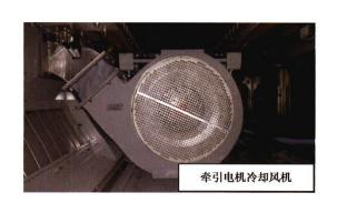
摘要: 为了获得最优高速列车牵引电机冷却风机双层悬挂参数,对轮轨和设备激励共同作用下的风机悬挂参数选择进行研究。建立车辆-设备动力学模型,并对系统振动响应进行积分求解,探讨刚、弹性悬挂,单、双层悬挂风机的振动特性。根据风机、框架悬挂参数对系统振动特性的影响筛选出最优悬挂参数取值范围,基于风机、框架悬挂参数匹配关系确定最佳悬挂频率比。研究结果表明,风机系统悬挂参数对车辆舒适度影响较小,但会影响风机系统振动,风机采用双层弹性悬挂能显著降低自身振动,当框架悬挂频率比取 0.7~0.9,风机悬挂频率比取 1.8~2.0 时风机系统能获得较好振动水平。根据悬挂参数匹配关系,最终确定风机、框架最优悬挂频率比分别为 1.8、0.9。
