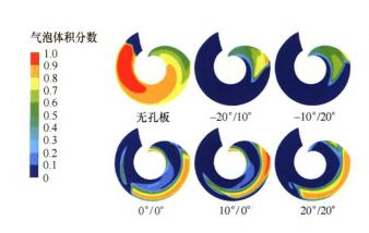
摘要:基于高速离心泵的比转速十分高,通常高速离心泵的进口处和内部是回流漩涡和空化空蚀等现象的高发区域。孔板等空化抑制装置是否能针对回流漩涡起一定的抑制作用的研究还比较少。采用对诱导轮的前置空化抑制装置进行优化,共设计了改变装置前、后倾角等几何参数的 25 种方案进行数值模拟计算分析。优选出水力性能最好的 5 种方案并进行了回流漩涡范围和强度的分。其中着重研究了 α 角度的改变是否会影响相关的的回流速度和压力。同时对高速离心泵诱导轮、叶轮内部空化发生及发展的影响分析。最终确定了-10°/20°和-20°/10°的两个最优方案,在对回流漩涡的强度和影响范围方面表现均优于其他方案;气相体积分数在诱导轮和叶轮的内部分布面积很少,强度较低;设计工况下,相较于 0°/0°方案,泵的效率约提高了2%,更好地抑制回流漩涡并提高了高速泵的抗空化性能,为高速离心泵内部空化的优化设计提供一定的参考意义。
