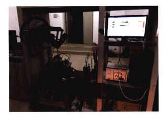
摘要: 在大多数智能车辆横向控制研究中, 存在未考虑驾 驶员误操作的影响这一不足。以人机共驾控制问题为研究 对象,将驾驶员操纵转矩和车辆状态作为控制器输入。首 先,建立转向系统和车辆二自由度模型,在车辆局部坐标 系中,根据预瞄点曲率信息实现虚拟路径的规划,基于车 辆状态和目标车道设计上层期望横摆角速度控制器。其次, 将侧向风和驾驶员误操作作为干扰输入,以车辆状态中的 横摆角速度、转向盘转角、转矩传感器测量值和期望横摆 角速度作为控制器反馈变量,考虑车辆参数摄动及传感器 测量噪声等影响,设计下层 μ 综合控制器, 使车辆跟踪期 望横摆角速度和期望的横向位移,确保车辆能稳定地跟踪 目标路径。最后,进行自动换道和车道保持仿真,并基于 Carsim/Labview 的硬件在环试验台上进行硬件在环试验, 仿真和试验结果均表明,提出的横向控制方法能辅助驾驶 员更好的跟踪目标车道,且对侧向风和驾驶员误操作均有 很好的干扰抑制性能。
