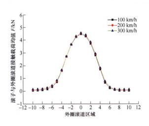
摘要:轴箱轴承作为列车走行部件中重要核心部件之一,由于其受载工况恶劣使其成为易损坏的部件之一,研究其在运行过程中滚子滚道间的载荷特性对基于载荷分布的轴承寿命预测,保证其在运用过程中的安全性和可靠性具有重要意义。基于包含轴承的车辆-轨道动力学模型,研究了轨道激扰和列车运行速度下滚子滚道接触载荷特征。研究结果表明,无激扰条件下,车速对滚子滚道接触载荷基本没有影响,但在非承载区,滚子与外圈滚道会发生接触,接触载荷与速度成平方关系;轨道激扰条件会影响能够引起滚子滚道接触载荷瞬时值发生变化;外圈受到的接触载荷标准差值,车速越快,标准差越大;对外圈受到的接触载荷根差值,车速越快,标准差越大;对外圈受到的接触载荷最大的区域进行研究,发现随着速度的增加,轨道激扰造成的振动越大,滚子滚道接触载荷数据波动越大。
