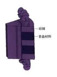
摘要: 永磁同步电机铁心再制造研究较少,性能提升困难,寻求切实可行的铁心性能再制造提升方案具有重要意义。利用旧电机硅钢材料与新型非晶合金材料制成再制造混合叠压定子,分析再制造前后电机性能变化,提出转矩叠加优化方法并对转矩进行优化分析。混合叠压再制造后,电机损耗大幅降低,效率有所提升,转矩有所减小;再制造电机转矩随着定子齿宽、绕组匝数以及电流的增大而增大;通过参数化扫描与正交分析方法,对再制造电机进行基于定子槽型尺寸与电流变化的转矩与损耗综合优化分析,确立再制造电机转矩优化方案为电机定子齿宽减小 0.8 mm,槽高增大 1.2 mm,额定电流减小 1.7 A;电机台架试验测试表明,与原电机相比,优化后再制造电机转矩基本不变,效率有所提升,验证了优化方案与仿真结果的有效性。混合叠压定子的研究为电机再制造研究及铁心性能提升方法研究提供了新的思路。
