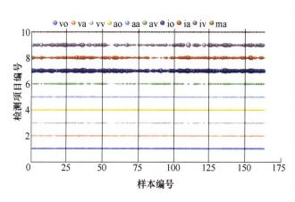
失效/故障智能诊断方法,基于极大似然分析基础上,提出一种基于"马氏距离"估算的关键特征参量影响分析方法,用于评价各特征参量对失效/故障分类的影响。该方法用于两个机械设备的失效/故障数据库的智能诊断分析,在获得高诊断识别率(失效/故障模式正确识别率分别达到 96%和86%)的同时,也识别了影响失效/故障分类的关键特征参量。分析表明特定的失效/故障模式往往取决于少数关键特征参量,而不确定的失效/故障模式的关键特征参量往往呈分散分布,关键特征的分散性会影响多维高斯贝叶斯分类
