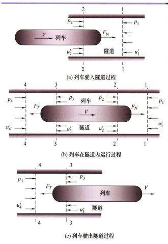
摘要: 应用一维可压缩非定常不等熵流动模型和广义黎 曼变量特征线法,研究中国标准动车组 CR400AF 单列 车通过隧道时的空气阻力。详细分析高速列车通过隧道 时空气阻力与列车周围空气压力、空气流速及压缩波和 膨胀波传播叠加三者间的关系,揭示高速列车通过隧道 时空气阻力的变化特征。研究隧道长度、阻塞比、车速 p<sub>1</sub> 及列车长度对高速列车通过隧道(尤其长大隧道)时空气 阻力的影响规律。结果表明,研究高速列车隧道压力波 时,只需要考虑列车驶入驶出隧道诱发的压缩波和膨胀 波的反射和叠加;而在研究列车空气阻力和列车周围空 气流速时还必须同时考虑压缩波和膨胀波的传播方向。 单列车通过隧道的空气阻力均随隧道长度、阻塞比、车 速和列车长度增大而增大。特长隧道时,各因素按其影 响程度由大到小排列依次为车速、列车长度、阻塞比和 隧道长度。其中,平均空气阻力与车速的2次方、与阻 塞比的 0.60~0.79 次方、与隧道长度的 0.02 次方近似 成正比。
