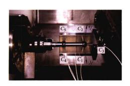
摘要:提出轴系回转精度测评的误差运动几何学原理,由转子误差运动、被测几何要素、传感器测试参数等三要素构造轴系回转精度测量的运动几何学模型,建立测量闭环矢量基本方程;推导出轴系误差运动参数测量的完备性条件,讨论回转误差运动参数测量的完备性及其演变形式,阐明各类回转精度测量数据与评价指标的运动几何学内涵。给出轴系回转误差运动的不变量定理,得到轴系回转误差运动分解为角摆误差运动与平移误差运动,建立角摆误差运动不变量、平移误差运动一下变量方法,有效地避免被测几何要素不同对测评结果的影响,为轴系回转精度的测量与评价提供理论依据。
