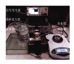
摘要:流体在螺线形流管中流动时受到的哥氏力,能够增强 流体的传质效果, 实现输送流体的功能。研究表明进出流管 一侧为斜线另一侧为螺旋线的单螺线形流管无阀泵具有泵功 能,而进出流管形状为异向螺线时相较于单螺线形流管哪种 泵输出性能更优,以及进出流管形状为同向螺线形时是否具 有"泵"功能,或者其输出是否低于异向螺线形流管无阀泵, 却没有相关研究。为了更好地发挥螺线形流管在无阀压电泵 中的优势,拓展该种类无阀泵的应用场合,需要进一步探讨 螺线形流管的布局方式对泵输出性能的影响。分析流体在螺 线形流管内部的流动情况,推导顺、逆时针流动时的速度差 公式,认为螺线形流管无阀泵流量是由进、出水流管的流阻 差造成的。利用 3D 打印技术,设计制作同向螺线、异向螺线 以及单螺线形流管三种不同流管布局的无阀压电泵,测量不 同频率下三种泵的流量。发现相同电压下, 单螺线形流管无 阀泵的流量最大,且其最佳工作频率也最大;同向螺线形流 管无阀泵也有泵输出,但是输出量很小; 当螺线形流管无阀 泵的驱动功率较小,其驱动力不足以抵抗流管沿程的流阻损 失时,反而体现不出其螺线形流管的优势。
