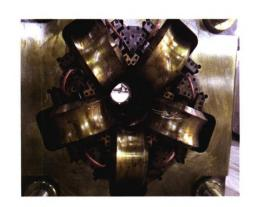
摘要: 高压气瓶是高压气体的主要盛装容器,广泛应用于石油化工、冶金、机械、交通、采矿、医药等行业部门及日常生活中。拉拔工艺是制造高压气瓶的重要方法。辊模的拉拔力是高压气瓶拉拔工艺中重要的参数之一。针对气瓶拉拔工艺,通过塑性力学对气瓶辊模拉拔过程进行分析,建立气瓶辊模拉拔过程中的几何模型和力学模型,并且给出辊模拉拔力的理论计算公式。在 34CrMo4 气瓶用钢热态拉伸试验的基础上,建立气瓶 5 辊拉拔的有限元分析模型并与所建立的理论模型的计算结果进行对比分析,分析结果表明,理论计算结果和数值模拟结果二者吻合较好,因此,建立的理论分析模型为气瓶的辊模拉拔实际生产中拉拔力的计算提供重要的理论依据。该理论计算模型和数值模型对气瓶的辊模拉拔工艺具有重要的参考意义。
