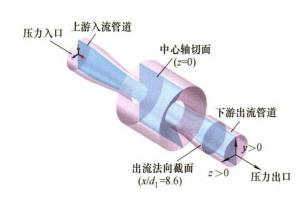
摘要:流体运动特性对管道近壁面阻力变化有重要影响。以速度梯度和切应力线性表示壁面摩擦阻力,分析了自激振荡腔室出流管道剪切涡流演变规律及圆截面涡流层次分布状态变化。采用大涡模拟数值方法,计算得到出流管道某轴切面及法向面的瞬时速度和平均速度、不同上下游管径比下出流管道的壁面切应力以及不同长径比下出流管道的法向速度梯度。研究结果表明:自激振荡脉冲射流流动受反向助推涡影响具有强烈三维特性,射流流型呈现"波浪式"运动且发生周向偏转,射流流速及流型均发生周期性波动变化;当自激振荡腔室上下游管径比大于1时,出流管道壁面切应力开始减小,且随腔室上下游管径比大于1时,出流管道壁面切应力开始减小,且随腔室上下游管径比大于1时,出流管道壁面切应力开始减小,且随腔室上下游管径比大于1时,出流管道壁面切应力开始减小,且随腔室上下游管径比增大,切应力缩减率最大达到约30%,壁面摩擦阻力随之减小;自激振荡腔室长径比在0.55时射流最大法向速度梯度逐渐减小,摩擦阻力亦随之减小。研究结果可为自激振荡脉冲增输装备设计及优化提供理论基础与科学依据。
