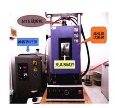
摘要:现有形状记忆合金(Shape memory alloy, SMA)管接头数值分析中没有考虑塑性变形及其影响,基于不可逆热力学框架,考虑塑性变形对逆向马氏体相变的影响,构建相变和塑性耦合的 NiTiNb SMA 唯象学本构模型,基于有限元软件ABAQUS 二次开发功能,编译用户自定义子程序,对 SMA 热机耦合作用过程进行数值模拟,并与 NiTiNb 合金低温下的拉伸和约束升温性能试验研究结果对比。结果表明,数值分析结果能够很好地描述试验所得的应力应变曲线和升温过程的应力温度曲线特征,能够描述材料预变形提高逆向马氏体相变温度的规律,得到低温变形及升温恢复过程中材料内部 Mises 应力、等效相变应变和等效塑性应变的演化规律。结果表明数值仿真与试验取得了较好的一致性,为进一步的SMA 管接头装配性能模拟及设计优化奠定基础。
