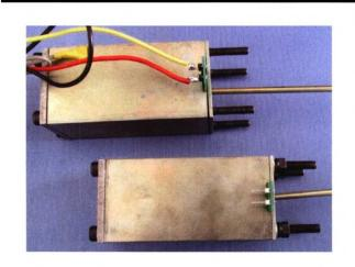
摘要: 动铁式比例电磁铁作为电液比例阀的电机械转换器,其电磁力本身对铁心位移是非恒定的,其恒定化是研究人员研究的重点之一,并因为铁心的存在导致其线圈电感很大,不利于提高电路的响应速度。为研制高性能电液比例阀/电液伺服比例阀,在前期完成了研究动圈式比例电磁铁及其相关理论的基础上,研制出高性能动圈式比例电磁铁样机,提出了利用动圈式比例电磁铁组成电液比例阀的结构方案,分析具有所提结构的电液比例阀的主要性能,提出了相应的动静态性能试验研究方案,并对这种结构方案进行试验研究。研究结果表明,利用所研制的动圈式比例电磁铁组成比例阀的方案具有动静态性能高的优点,所研制的比例电磁铁组成比例阀的方案具有动静态性能高的优点,所研制的比例电磁铁静态具有非常好的恒力特性,开环情况下被控阀芯位移对 100%输入信号的阶跃响应时间不超过 15 ms。研究结果对研制高性能电液伺服比例阀具有积极意义。
