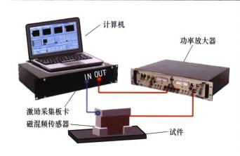
摘要:在金属材料常见的早期力学性能退化损伤中,疲劳对结构的潜在危害性最大。基于铁磁性材料的磁滞非线性特性,在高低频叠加励磁条件下,研究铁磁材料中磁混频效应的产生机理及表现形式。分析混频分量和局部磁滞回线与材料早期损伤的关系,提出磁混频非线性因子与局部磁滞损耗幂律系数两种特征参量用于铁磁性材料磁混频效应的表征。在此基础上,将磁混频检测技术用于铁磁性材料疲劳损伤检测。结果表明,提出的两种磁混频特征参量可用于铁磁性材料早期疲劳损伤的表征。为铁磁性材料早期疲劳损伤检测提供了可行的技术方案。
