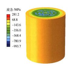
摘要:针对前混合水射流的液固湍动特性与喷丸过程多重非线性耦合作用行为,提供一种射流喷丸强化残余应力场的有限元分析法。采用液固两相流动理论与计算流体动力学方法分析喷嘴内流特性,建立射流多弹丸喷丸模型;基于弹丸速度冲击载荷加载制度,利用多线性各向同性强化弹塑性模型,应用动态接触对称罚函数法,运用 ABAQUS 软件模拟不同弹丸数量作用下射流喷丸在 45 钢材料表层产生的残余应力场,获得残余应力场的分布规律及残余应力沿深度的变化规律;得出射流喷嘴内流呈均质流流型,不同弹丸数量射流喷丸在材料表层产生的径向残余应力沿深度的变化规律相同,但在材料表面产生的径向残余压应力值受喷丸模型影响较大,对弹丸分三层排列、相邻弹丸之间径向和周向中心距离均为弹丸半径的多弹丸喷丸模型,数值模拟获得的表面径向残余压应力值与射流喷丸试验数据基本吻合。
