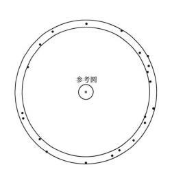
摘要: 圆度误差的准确评定对轴和孔类零件的质量评判有 很重要的意义。针对目前常用的圆度误差评定方法存在原 理误差或模型误差的问题,提出一种完全符合最小包容区 域法定义的圆度误差评定方法。该方法将区域搜索算法和 圆度误差最小包容区域法评定的几何结构相结合,利用区 域搜索算法确定准圆心,再根据准圆心位置和几何结构, 对其进行判断和调整,最终找到准确的最小包容区域圆心, 并给出最小包容区域圆度误差的精确解。构造多组仿真数 据,利用此方法的评定结果与预设值相比较,证明了该方 法的有效性和正确性;并利用该方法对其他文献中的数据 进行评定与比较,数据处理的结果进一步显示了该方法的 评定结果精确可靠,稳定性好,且效率高,可以有效地克 服现有圆度误差评定方法难以找到准确最小包容区域圆心 的缺陷。
