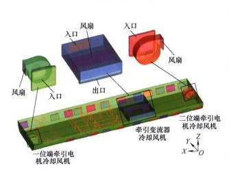
摘要:为实现抗风沙型动车组的封闭式设备舱的通风格栅合理布置,建立包含车底设备舱通风格栅和舱内设备的高速列车空气动力学模型,采用 CFD 方法对高速列车运行时的设备舱流场进行数值模拟,分析格栅布置方式对设备舱通风性能的影响。结果表明:格栅的通风性能主要受格栅布置位置处裙板外侧压力的影响;头车裙板上靠近一位端的位置适宜布置出风格栅,靠近二位端适宜布置进风格栅;中间车裙板上靠近一位端的位置适宜布置出风格栅,其他区域适宜布置进风格栅;尾车裙板上中间区域适宜布置进风格栅、两端适宜布置出风格栅。另外,设备舱底部出风风格栅、两端适宜布置出风格栅。另外,设备舱底部出风口对其附近的格栅进风性能也有一定影响,设备舱内风机的格栅进风阻力受列车运行速度的影响较小。设计阶段可定性地利用裙板上格栅位置与格栅进排风性能的关系,初步确定适宜的格栅布置方案。
