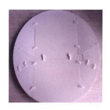
摘要:针对固体反射面可展天线结构的分块数量和包络尺寸等实际需求,对抛物面刚性可展天线结构进行分块优化和连接设计。依据可动性分析,分块优化选用双自由度的单顶点五折痕模式,但是通过约束折痕转动实现反射面运动路径可控。采用平面单位圆模型定性分析分块节点的几何参数对机构收纳比的影响。以收纳比为优化目标函数,以刚性约束、碰撞约束和可动性约束为优化约束条件,建立抛物面刚性可展天线结构的优化框架,并采用 1stOpt 结合简面体爬山法结合通用全局优化算法计算分块参数。针对面板转动过程碰撞问题,进行了面板连接节点和转动轴设计。仿真分析和 3D 打印分块模型结果说明该方法的可行性和合理性。
