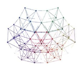
摘要: 研究折展单元机构构型综合对于可展开天线机构创新设计具有重要意义。根据三棱锥折展单元机构多运动输出期望公共运动和期望同步运动自由度要求,基于螺旋理论约束综合法,完成机构公共运动和耦合同步运动支链的构型综合,获得了多种基本折展单元构型,并结合应用实际确定一种优选三棱锥折展单元机构。根据 3RR-3RRR 单元折展机构的组网方式和组网运动的要求,采用螺旋理论进行了运动副的构型设计和优化,综合出一种具有耦合自由度的高刚度三棱锥折展单元组网机构。所采用的构型综合方法实现了螺旋理论约束综合法在折展机构构型综合中的应用,为具有多运动输出部件耦合运动要求的机构综合研究提供参考。综合得到的机构适用于星载构架天线反射器等空间曲面支撑类机构应用需求,具有广泛的应用前景。
