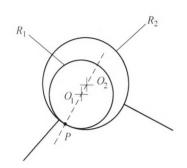
摘要:受装配与展开需求的影响,空间可展开结构的铰链中普遍存在着间隙。空间可展开结构展开到位锁死后,由于铰间隙的存在,可展开结构在外载作用下的静力平衡位置不唯一,即存在静力多稳态现象。为了揭示静力多稳态现象的内在机理,以某伞状可展开天线为研究对象,利用无质量杆间隙模型对含间隙可展开结构进行静力学建模。分析了间隙尺寸、摩擦因数与杆长配置等对含间隙可展开结构静力平衡位置的影响规律。分析结果表明,间隙与摩擦是静力多稳态现象产生的原因;间隙尺寸越大,摩擦因数越大,含间隙可展开结构在特定外力下的静力平衡位置越多;不同位置的间隙与摩擦因数对静力多稳态现象的影响程度不同;杆长配置影响静力多稳态现象;通过施加合适的预紧力,可有效控制静力多稳态现象。
