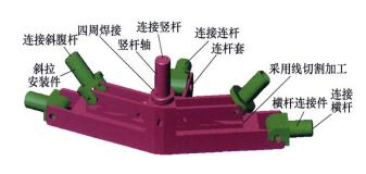
摘要:分析双圈六面体环形桁架可展开结构的展开原理,计算完全展开状态下结构振动频率,说明结构具有较好的刚度。进行展开过程动力学计算,优化展开驱动机构、节点、驱动方式及连杆等结构模型的设计,制作缩比模型,试验证明结构能顺利展开,从而验证模型设计的有效性。计算分析和试验结果表明:双圈六面体环形桁架式可展开天线结构形式简单,收缩比小,具有较好的刚度,在扭簧和电动机拉索力驱动下,能顺利展开,可作为可展开天线结构的有效支撑形式。
