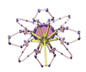
摘要: 雨伞的连杆机构是最经典的可展机构之一,它是由多个平面连杆或悬臂杆构建而成,呈现出来的是一种低刚度和低耦合性的肋式支撑结构。到目前为止,可用来构建高刚度伞状可展机构的空间闭环连杆可展单元很少。为此,开发一类含三转动副(3R)耦合支链的两层两环空间连杆,并以它们为单元构建多环耦合的伞状可展机构。基于自由度和对称性特征分析了此类两层两环空间连杆机构的结构形式。提出了一种简洁高效的模块化组合方法来综合两层两环空间连杆可展单元;根据机构的单自由度要求和结构的对称性建立了单元间的可动连接方式;根据综合得到的可展单元和单元间的可动连接方式构造出一族新型伞状可展机构。不同于传统的雨伞机构,这些新型伞状可展机构呈多环耦合状的桁架式结构,在航天装备、建筑结构、艺术结构等领域具有良好的应用前景。
