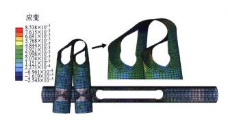
摘要: 研究了一种带有两个细长槽的复合材料管铰链空间可展结构的力学行为。基于二维 HASHIN 失效判断准则,分析管铰链在弯曲折叠过程中可能出现的失效模式和力学行为,研究其折叠过程中失效危险点位置。验证了将复合材料应用于管铰链的可行性。同时,进一步研究了管铰链的槽长、槽宽以及端圆直径对其折叠力学性能及损伤特性的影响规律。基于响应面方法,建立了以应变能最大与临界弯矩最小为目标,以复合材料失效因子为约束,以管铰链几何参数为设计变量的优化模型。采用非支配排序遗传算法对优化模型进行求解,获得了可行解分布,最后依据工程实际采用权重法求解优化模型,得到了优化结果。研究结果对于设计新型运行稳定可靠的空间可展结构具有一定的理论意义。
