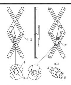
摘要:提出了一种基于剪叉机构单元的剪叉弯曲折展变胞机构单元,给出了构造该变胞机构的约束条件。建立了该机构单元运动的数学模型,通过计算分析了该机构的自由度和运动形式。提出了剪叉弯曲折展机构单元在剪叉机构运动和弯曲机构运动状态转变的工程实现方法,并通过计算分析得到了实现该方法所需的杆长约束条件和角度初始条件。提出了控制机构单元弯曲曲率的方法,通过数值计算得到了限位连杆长度与弯曲曲率的定量关系。该机构单元可以串联组合用于大尺寸物体的抓取。建立了单个机构单元以及两个机构单元组合的三维模型,进行了运动仿真模拟,验证了设计的可行性。
