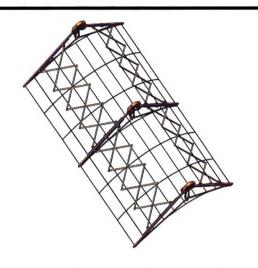
摘要:可展收抛物柱面天线可用于卫星系统中,实现无线通信、深空探测以及空间目标搜索等功能。近年来随着航天事业的迅猛发展,对空间可展天线的成形精度要求越来越高。提出并设计了一种可展收抛物柱面天线机构,该机构主要由网面支撑机构、柔索、金属丝网、轴向驱动与锁定装置、径向驱动与定位锁定装置组成。其中,网面支撑机构包括径向和轴向展收机构。研究中提出了一种新型平面可展收机构作为径向展收机构的组成单元实现天线的径向展开收拢。对可展收机构的等效机构进行了优化设计。利用剪式单元可展机构实现了轴向展收机构的设计。完成了可展收抛物柱面天线机构的驱动组件设计,在 Solidworks 中完成建模,对天线机构进行了运动学仿真。
