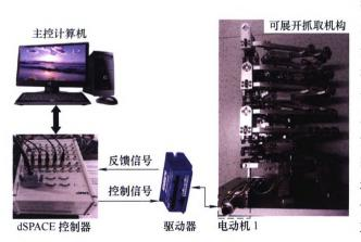
摘要:针对一种新型桁架式可展开抓捕机构的展开运动,提出该机构的动力学建模方法并设计考虑过约束等非线性因素的控制策略以提高其运动性能。对该桁架式可展开抓取机构进行简要描述,利用拉格朗日力学并通过递归的方法建立该机构展开运动的动力学模型。利用动力学模型的已知信息,设计扩张状态观测器以估计机构中的过约束等非线性因素引起的动力学项。使用扩张状态观测器作为补偿项,提出改进型的自适应鲁棒控制器,其中,通过设计非连续映射自适应控制律来估计机构的惯性参数,通过设计自适应滑模控制律来克服传统自适应鲁棒控制器中的问题。搭建可展开抓取机构的试验平台,通过与现有的不同控制器的比较试验来验证提出的控制器的有效性。
