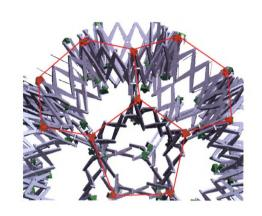
摘要: 地面雷达监测是目前对空间碎片最为有效的监测方法 之一,为了保证地面雷达测量精度,需要对其进行鉴定、校 准。校准装置需要具有恒定的外形,尽可能接近球形,同时 为满足发射时体积包络要求,亟需一种具有小折展比的可展 开球形雷达校准机构。通过对成角杆剪式单元进行分析,提 出了一种成角杆正棱锥剪式单元,该单元能够实现空间放 缩;通过对空间多面体的研究,分析了球形多面体的构造方 法;根据所构造的球面构型,通过模块化的正棱锥可展单元 组合的方法构成球形可展机构。总结了一种用于设计球形可 展机构的理论方法,并通过原理样机验证了方法的可行性, 将为我国第一颗雷达校准卫星研制打下良好的基础,具有很 好的应用前景。
