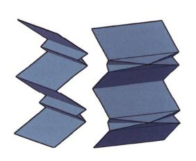
摘要:将折纸技术应用于空间薄膜结构构型设计并在展开全过程进行应力优化,设计折纸型充气管结构组合使用,完成大型空间薄膜遮阳罩折展构型设计。基于光学系统遮阳需求,采用杆系等效方法分析了两种薄膜折痕方案折展过程中的应力改变水平,并进行了遮阳罩薄膜结构的参数设计。考虑到充气管与薄膜结构的点连接和同步折展问题,采用单项点六折痕模式改进了传统的 Z 字型充气管设计方案并进行了通气性能分析。采用 ANSYS/LS-DYNA 仿真计算了薄膜结构和充气管结构的展开全过程,并进行了应力水平和气压分析,最终通过样机模型进行了展开试验验证。结果表明,组合采用改进薄膜折痕方案和改进 Z 字型充气管方案,大型空间薄膜遮阳罩的展开路径明确,收纳比高且不会造成遮阳薄膜损伤。
