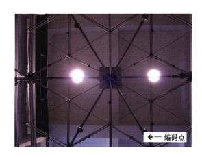
摘要:为研究金属网面式可展天线支撑桁架对反射器表面形面精度的影响,开展模块化构架式空间可展天线支撑桁架展开精度测量试验及分析研究,根据支撑桁架的结构特点,基于机器人学基本理论,建立关键节点空间数学模型,设计悬吊随动式微重力展开试验装置,采用数字近景摄影测量原理,对支撑桁架的展开精度进行测量试验,并从支撑桁架的形面精度、重复展开精度和关键节点误差等3个方面进行分析。试验结果表明:支撑桁架上关键节点的均方根误差(RMSE)值较小,由关键节点构成的曲面其形面精度较高;支撑桁架在多次重复展开试验中,关键节点中最大误差小于1 mm,结构展开的一致性较好;完全展开后,关键节点的实测值与理论值接近,支撑桁架的制造及安装精度较高。提出的测量和分析方法为其他类型金属网面式可展天线支撑桁架展开精度的研究提供了借鉴和参考。
