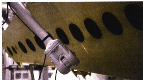
(b) 搭载机械臂上的线激光扫描仪
