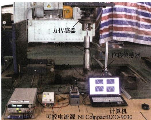
**摘要:** 研究了基于磁流变能量吸收器(Magnetorheological energy absorber, MREA)的单自由度冲击缓冲控制系统在落锤激励条件下的控制方法, 实现最大化利用 MREA 的活塞行程并在活塞行程终点落锤速度减小至 0 的落锤“软着陆”控制目标。建立了基于 MREA 的单自由度冲击缓冲系统的动力学模型和试验测试系统。为了准确模拟 MREA 的磁滞非线性力, 基于基本 RC 算子磁滞模型研究了 MREA 磁滞非线性力前馈跟踪方案。根据落锤的实时状态得出落锤下落的期望反馈, 从而得出期望阻尼力进而实现落锤的缓冲控制。仿真分析和试验测试验证了基于准确的 MREA 磁滞非线性力模型的 MREA 冲击缓冲系统“软着陆”控制方案的可行性。
