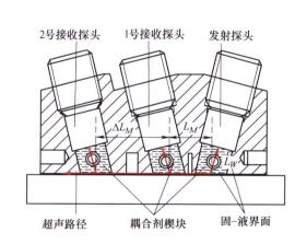
摘要: 针对金属材料零件制造中的表面残余应力无损检测难题,提出一种平面应力状态超声测量方法。基于线弹性理论,引入晶粒取向表征因子,揭示晶粒取向对超声传播的影响机制。虑及材料力学性质(弹性常数、晶粒取向等)和应力状态对声速的共同影响,建立平面应力分量-声速解耦模型。基于临界折射纵波(Lc<sub>R</sub> 波)表面应力测量原理,分析温度与耦合状态对超声信号衰减、畸变以及声时的影响规律,并设计出一种一发双收直接耦合造波探头。以单向拉伸的变截面铝合金板和搅拌摩擦焊后的轧制铝合金板为典型对象,利用自主开发的超声应力测量系统进行表面应力测量试验,分别与有限元法和小孔法进行对比,应力测量结果具有良好的一致性,可为金属材料表面残余应力测量提供可行方案。
