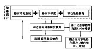
摘要: 为深入探讨轮胎-路面之间耦合振动,在考虑轮胎与路面的非均匀动态摩擦力基础上提出轮胎-路面-路基系统耦合模型。以 Kirchhoff 薄板理论为基础,建立有限长度和有限宽度板在 Winkler 地基上的路面结构动力学模型,为了真实描述轮胎与路面之间的耦合关系,将传统的基于线接触载荷分布的 LuGre 轮胎模型改进为面接触非均匀载荷分布。采用Galerkin 截断法将路面振动的偏微分方程简化为有限常微分方程,运用 Runge-Kutta 法求解控制方程,计算轮胎-道路耦合系统的响应。探讨不同的横向、纵向截断阶数对耦合系统振动响应计算精度的影响,确定最佳的截断阶数。对轮胎路面的耦合特性进行分析,分别从路面的结构变形、动态载荷和轮胎力(纵向力、侧向力和回正力矩)对比在考虑耦合和不考虑耦合作用的区别,为路面结构设计和车辆性能控制提供参考。
