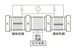
摘要:油液中的磨粒可反映发动机等设备的磨损状况,为实现油液金属磨粒的在线监测,基于电磁感应原理建立了三线圈传感器的数学模型,通过仿真分析传感器最佳结构参数(内径、间隙、宽度等),利用相干解调模型提取磨粒信号,并分析磨粒信号产生原理。系统采用多层屏蔽结构,可有效减少外部的磁场干扰,设计的传感器检测系统接入风机齿轮箱油路进行相关试验。试验结果表明,本系统可对磨粒信号进行有效提取,且磨粒信号同时受磨粒速度及磨粒尺寸的影响,可在流量为 1~18 L/min 的工况下实现 187 μm 铁磁性金属磨粒和 578 μm 非铁磁性金属磨粒的检测,后续可结合 BP神经网络对油液金属磨粒各特征参数进行自适应判别,对今后油液磨粒在线监测设备的开发提供了理论支撑及技术支持,为机械设备故障诊断提供重要依据。
