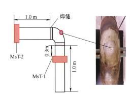
摘要:利用导波的远场检测优势和机器学习模型,开展管道弯曲处腐蚀损伤程度智能辨识方法研究。在普通碳质钢管弯头处加工不同程度的腐蚀缺陷,按腐蚀程度分为10个等级。采用自激自收和一激一收两种信号激励接收方式,在管道中激励具有非频散的 T(0,1)型超声导波,采集得到不同腐蚀程度缺陷对应的导波检测信号。在时域和频域对检测信号进行分析,提取多个导波信号特征值用于表征损伤程度,并通过BP神经网络和支持向量机两种分类模型对数据进行训练分析得到缺陷损伤辨识模型,实现弯曲处腐蚀程度的准确辨识。研究中分析两种模型的超参数对缺陷辨识模型精度的影响,对比研究两种模型对弯管腐蚀损伤辨识的性能。试验结果表明,两种损伤辨识模型对不同激励接收模式下的导波检测信号均能取得较优的分类效果。相较于BP神经网络,支持向量机在小样本条件下对弯管腐蚀损伤具有更好的辨识效果。
