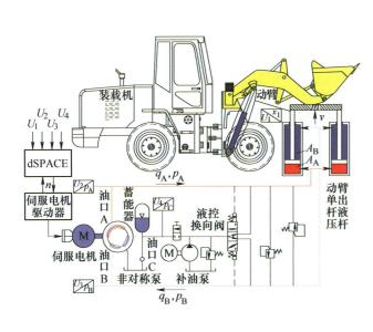
摘要: 装载机通常采用阀控液压系统驱动动臂升降, 上升过 程积累了大量的动臂重力势能,在下降过程中经液压系统节 流口节流作用耗散到环境中,频繁的升降过程产生了大量节 流和溢流损耗,造成了系统发热与能量浪费。为消除液压系 统的溢流与节流损失,提出采用闭式泵控原理驱动动臂单出 杆液压缸: 为平衡液压系统中单出杆液压缸的不对称流量和 回收利用动臂的重力势能,提出含有三个配流窗口的非对称 泵为闭式泵控液压系统供油。在非对称泵中,其中一个配流 窗口与蓄能器相连, 动臂下降阶段用于回收动臂重力势能, 上升阶段与另外一个配流窗口共同为液压缸无杆腔供油,第 三个配流窗口则与液压缸有杆腔相连。研究中,分析所提系 统的工作原理,建立联合仿真模型,构建所提系统的试验平 台,对所提系统的工作和能耗特性进行试验研究。试验结果 表明,所提系统可平衡由闭式泵控单出杆液压缸造成的非对 称注对照表,并实现动臂重力势能的回收,与原有阀控系统 相比,最高可降低系统能耗 47.19%。
