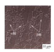
摘要:如何快速、准确地对钛合金的微观组织含量、尺寸、分布和形态进行表征是实现其组织定量调控的关键。为实现这一目标,以钛合金 Ti-6Al-4V 的等轴组织为研究对象,针对钛合金中粘连组织轮廓具有不规则性而不易进行组织分割的问题,通过采用改进的快速特征点检测与绘制模板圆相结合的方法,对其切削加工后的表面微观组织图像中的粘连组织进行分割;进而采用定向度和圆形度参数来描述钛合金微观组织的分布情况和形态,并对其体积分数和晶粒尺寸进行定量表征,以便更完整地描述钛合金微观组织的特征信息。采用该方法研究钛合金 Ti-6Al-4V 的组织随切削速度的变化情况,验证该方法的可行性和有效性。所研究的改进的快速特征点检测与绘制模板圆相结合的方法可为材料的微观组织定量表征提供一种新思路和新方法。
