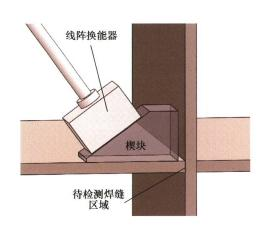
摘要: 板直角焊接结构由于被焊试件厚度薄、检测精度要求高等因素使得常规检测方法难以施展。利用相控阵超声检测技术声束灵活可控的特点,制定基于波束控制的全覆盖检测方案。为获得较好的信噪比,提出一套楔块几何参数的优化设计方法; 对采用多次反射方式入射的相控阵超声偏转聚焦法则计算方法进行了研究; 构建采用机械臂作扫查器的高精度相控阵超声自动化检测系统,对具有人工预埋缺陷的钛合金薄板直角焊缝结构进行了检测试验,验证检测方法的正确性。研究结果表明,所提出的相控阵超声检测方法,能够对裂纹、未焊合等类型缺陷进行良好表征,满足薄板直角焊缝的超声无损检测要求。
