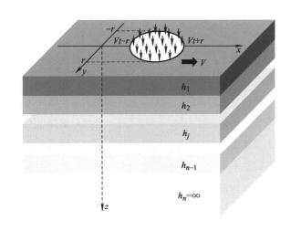
摘要: 高效准确地获取随机不平度激励下车辆-沥青路面交互 作用特性,对路面友好型车辆设计、路面服役性能评估极为 必要。采取解析法和顺序解耦的求解思路,首先推导随机不 平度激励下 1/4 车辆模型的随机动荷载; 而后借助相对坐标 变换和 Fourier 积分变换,基于波传递方法,推导移动车辆 随机动荷载作用下黏弹性多层体系沥青路面动力响应解析 解,并编制相应的数值计算程序。通过车辆-路面动力学响 应算例分析,得出沿车辆移动方向各纵向位置处的沥青路面 动力响应幅值与随机动荷载相关。通过车辆-路面系统参数 影响分析,可以发现,降低悬架和轮胎刚度系数、增大悬架 阻尼系数可以降低沥青层底纵向应变,有利于提高路面疲劳 寿命:轮胎阻尼系数对路面动力响应几乎无影响;路面不平 度的劣化会显著加剧路面疲劳损伤:增大车辆移动速度会降 低沥青层底纵向应变均值, 但会增大其变异系数, 故为了准 确评估路面疲劳寿命, 需充分考虑车辆移动速度对动力响应 均值和变异系数的综合影响。
