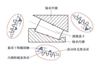
摘要: 声发射技术因具有高频、高灵敏度的感知能力,可应用于动车组轴箱轴承的状态监测和故障诊断,但目前尚缺乏轴承状态与声发射信号之间的机理性研究。以动车组轴箱轴承为研究对象,应用赫兹接触理论,基于微凸体随机分布假设,建立了轴承粗糙表面的接触模型;采用弹性力学理论,进行了轴承受载条件下的微凸体弹性变形分析;结合弹流理论,进而建立了润滑条件下滚动体与内、外圈之间的粗糙接触表面变形能量方程;分析轴承接触状态声发射信号的弹性波表征特点,获取轴承变形能与声发射感知的 RMS 之间的变化关系,从而完成了轴承的声发射感知的 RMS 之间的变化关系,从而完成了轴承的声发射检测机理研究。以典型双列圆锥滚子轴承的外圈故障为研究实例,通过理论分析和试验结果之间的比对,验证了机理分析的正确性,为声发射感知在轴承状态检测的应用提供了理论支持。
