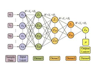
摘要:路面附着系数是车-路相互作用中最为关键的参数之一,它的精确获取也是车辆主动安全控制系统正常工作的前提和基础,为此提出一种基于改进 Keras 模型的路面附着系数估计方法。对车辆进行动力学分析,找出与路面附着系数相关的动力学参数作为神经网络模型的输入量;通过各种工况的仿真试验建立数据集;以 Keras 模型为基础,结合限幅递推平均滤波算法、K 折验证、Dropout 正则化与 Sarsa 强化学习,提出改进 Keras 模型的路面附着系数估计器。滤波算法用于除去神经网络模型输入量的噪声,K 折验证用于扩大样本空间,Dropout 正则化可以降低模型的过拟合现象,提高模型泛化能力,Sarsa 强化学习可以改善路面附着系数预测量超过边界的问题。最后,通过仿真验证表明所设计的估计器在路面附着系数估计中的有效性与可靠性,提出的方法相比原 Keras 模型平均绝对误差降低了 73%,均方根误差降低了 58%。
