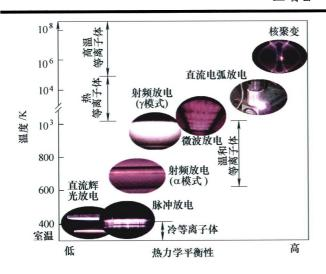
摘要: 简要介绍等离子体的相关概念和分类,根据等离子体电极结构、放电特性不同将等离子体分为热等离子体和温和等离子体,并对比两种等离子体表面强化技术的异同点。在此基础上,从当前研究进展和存在的关键科学技术问题两个角度,梳理热等离子体喷涂技术在制备热障涂层、耐磨涂层、梯度功能材料等领域的应用,对温和等离子体表面强化技术(等离子体物理气相沉积、等离子体化学气相沉积以及冷等离子体)在纳米纤维改性、高压绝缘、生物医学等领域的应用进展进行了综述。最后,从等离子体产生技术、表面强化技术应用以及微观-宏观过程控制三个角度分析了等离子体表面强化技术的未来发展方向,对等离子体表面强化技术的多学科发展融合和综合利用提供一定的参考。
