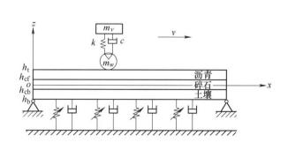
摘要: Galerkin 截断法是研究车路耦合系统动力学响应的常用方法。将路面假设为非线性黏弹性地基夹层梁模型,车辆假设为匀速运动的弹簧振子,建立车路耦合系统的振动方程。基于路面线性固有频率,提出了两种确定 Galerkin 截断收敛项的有效方案,并分析系统耦合振动响应的收敛性。观察不同车速下的路面响应和车辆振动位移。当车身发生共振时,分析不同路面厚度下 Galerkin 截断数对系统收敛性的影响。讨论系统达到收敛时,车辆悬架刚度和阻尼,路面不平度波长和幅值对路面变形和车辆振动位移的影响。数值研究表明,提出的方案对车路耦合系统的收敛性判断具有较高的准确性,大大提高了计算效率,对研究人员解决车路耦合系统动力学问题有一定的促进作用。
