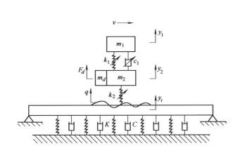
摘要:轮毂电机驱动的电动汽车簧下质量大导致轮胎动载荷 增加,电机电磁力也会加剧车辆振动,同时车辆和道路通过 动态轮胎力相互耦合。为了探究电动汽车的振动机理, 建立 电动汽车机-电-路耦合系统非线性动力学模型,考虑悬架刚 度、阳尼和轮胎刚度的非线性,并在传统路面不平顺激励的 基础上叠加了轮毂电机的电磁激励和车路耦合引起的路面 二次激励。解析推导电机电磁激励的表达式,建立轮毂电机 三维实体有限元模型,计算磁通分布及电磁转矩,验证理论 结果的有效性。利用模态叠加法推导了两端简支黏弹性地基 梁的垂向位移响应,将其作为路面二次激励引入耦合系统模 型。以车身加速度、悬架动挠度、轮胎力和轮胎四次幂合力 作为评价指标,分析电磁激励、路面二次激励、车速和车辆 非线性对车辆平顺性和道路友好性的影响。 研究发现,车辆 非线性对车辆振动和道路友好性的影响最大,电磁激励的影 响次之,路面二次激励的影响较小;车辆高速行驶时,车身 振动加剧且车辆载荷对道路损伤的影响更为显著;路面越平 坦,以上三个因素的影响越大。所提出的车辆与电机、道路 一体化建模思路, 可为电动汽车动态设计和道路友好性研究 提供借鉴。
