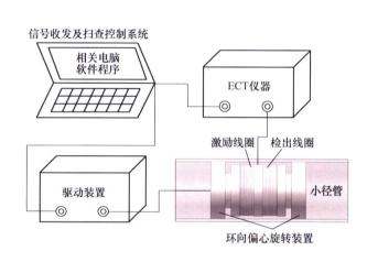
摘要:针对小径管缺陷的检测,传统检测方法基本为 Bobbin 探头,但这种方法具有不能检出缺陷的环向信息的缺点。基于涡流检测的研究,为达到检出小径管缺陷的多重信息的目的,提出并开发一种新型的环向偏心 Bobbin 探头。该探头兼具轴向扫描和偏心环向扫描的功能,能够对小径管缺陷的多重信息进行有效检测。具体研究内容基于涡流检测的方法,设计出适用于小径管的可偏心、可环向旋转的 Bobbin 探头,并建立模型进行模拟计算;通过整合获得的模拟数据,验证新型探头对于小径管缺陷的轴向、环向扫描相比于传统探头的优越性;制作探头并搭建试验系统,对所开发探头检测小径管缺陷的功能进行验证,进一步确立了该新型探头的优越性和高效性。
