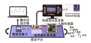
摘要:波浪能是世界上分布最广泛的可再生能源之一。海洋环境中波浪运动随机复杂且频率极低,这为海洋波浪能的高效收集利用提出挑战。设计了一种混沌平面摆式波浪能收集装置,其中混沌平面摆作为超低频随机波浪俘能机构,配合齿轮增速传递机构与电磁旋转机构实现波浪能收集装置的高功率输出。为更好响应浮标在海洋中的运动激励,对俘能机构进行动力学分析建模与优化。针对装置输出电压无规律且低频交流的特性,设计功率采样跟踪升压存储的电源管理电路。通过实验室测试与实际近海测试,装置能够对复杂波浪产生最大10 V 的开路电压,最大输出功率约 205 mW。海试中,4 小时可将 200 mAh 锂电池电压由 3.12 V 充电至3.6 V,能够作为新能源海洋浮标低功耗传感器的可持续电源。
