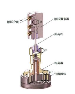
摘要: 气阀是往复压缩机最易损部件,尤其在气量调节系统工作状态下,阀片断裂、弹簧断裂等故障频繁发生,进而导致压缩机气量调节失败,严重影响企业生产。为了使往复压缩机在部分气阀气量调节失效故障下,能够不停机自动在线调整恢复到接近正常的性能,构建气缸-气阀气量分配模型,提出一种通过气阀气量分布网络收缩重构和负荷再分配的自愈调控方法。利用主动自愈调控手段,完成故障区域快速隔离,组建新的调节域并寻找自愈路径,再通过负荷自适应分配实现机组故障后的自我恢复。介绍气量调节失效故障自愈调控系统的组成,并进行故障自愈调控性能试验。试验结果表明,自愈调控系统可在故障分化的初期采用主动调控方法抑制故障的发展,在 12 s 内将气量调节失效故障的压力波动调整至许可范围内,实现机组不停机由部分气阀气量调节失效故障状态恢复到正常状态,使故障在线自愈,确保设备的健康运行。
