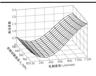
摘要: 针对板带轧制过程轧机出现的垂直振动问题,分析轧机液压与机械系统耦合作用,建立 4 自由度轧机机-液耦合振动模型。研究前后张应力、压下制度和摩擦因数对轧机振动过程中轧制力的影响,构建轧机振动轧制力增量模型。基于振动系统正负阻尼对轧机振动的稳定性影响,提出用于表征轧机振动发生概率的振动系数指标与轧机稳定判别模型。同时选取现场典型规格产品为例,分析出轧制速度、压下制度、平均张力、乳化液流量、乳化液浓度和乳化液温度等关键工艺参数对振动系数的影响规律,并编制轧机振动系数计算软件,将其应用到某厂 1730 冷连轧机组,验证了本文提出的振动判别模型的有效性。
