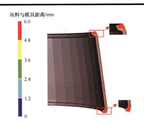
摘要:环件轧制作为一种无缝环筒类构件先进塑性成形技术,目前还难以实现铝合金薄壁带筋锥筒构件的近净成形制造。针对 2A14 铝合金薄壁异形截面环件,建立其辗扩成形宏微观耦合分析有限元模型,选用矩形截面环件作为坯料,基于有限元模拟获得了优化后的轧制孔型,并探究坯料初始温度及芯辊进给速度对材料成形性和微观组织演变的影响规律,得到微观组织均匀且孔型填充性良好的辗环工艺参数。环坯温度为 470 ℃,芯辊进给速度为 1.2 mm/s,主辊旋转转速为 30 r/min,上锥辊的压下速度为 0.6 mm/s 为最优工艺参数,能够满足 2A14 铝合金异形截面辗扩形/性控制要求,可为实际生产提供理论指导。
