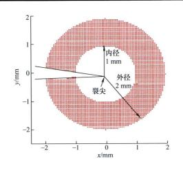
摘要:基于数字图像相关技术,使用非线性迭代法拟合工业纯钛 CT 试样表面位移场,获得了过载前、过载时、过载后循环的裂纹尖端位置随载荷的变化规律。使用数字图像相关技术获取裂纹张开位移,通过间接法测量裂纹张开力,进而研究过载对裂纹闭合效应的影响。对比过载前一循环与过载循环在卸载状态下裂纹尖端附近区域的应变场,结合裂纹尖端位置随载荷的变化规律及相对应循环的裂纹张开力,分析可知:过载在裂纹尖端附近区域产生较大塑性变形,即使卸载后仍在较大程度上得到保留,从而使裂纹闭合效应减弱,导致过载后裂纹尖端位置随载荷的变化规律与过载前明显不同,且力-位移曲线也未出现显著的转折点。
