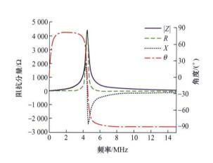
摘要: 在电磁无损检测领域, 涡流检测技术被用于导电材料 的检测,电容成像技术被用于绝缘材料的检测。而针对玻纤 复合材料修复结构这类"绝缘-导电"混合结构,单一涡流 或电容技术无法实现混合结构各层材料中多类型缺陷的全 面检测。通过采用平面线圈探头及较高频率激励,线圈电容 效应得以增强,结合线圈本身的电感效应,可同时实现电容、 涡流两种模式的检测,弥补单一技术的固有局限性。从双模 式检测系统电容效应、检测系统等效电路分析及被测对象参 数对阻抗测量影响三个角度对双模式检测技术的工作原理 进行了分析,构建了采用平面线圈探头的电容-涡流双模式 检测系统,并对玻璃钢和"玻璃钢-金属"混合结构两类典 型试块中的表面与隐藏缺陷进行了检测。结果表明,基于平 面线圈电容电感效应的双模式检测技术可同时实现对绝缘 材料与导电材料中缺陷的检测,并可根据不同激励频率下的 探头响应实现缺陷的区辨,有望满足复合材料修复结构等 "绝缘-导电"混合结构的全面检测需求。
