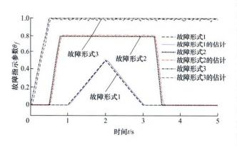
摘要:针对风电机组的传动系统、发电机和桨距系统故障的有限时间重构和实际应用中气动转矩无法准确获取等问题。提出一种新的自适应非奇异终端滑模观测器。在观测器中引入自适应律,确保滑模观测器不受未知扰动的影响。设计的非奇异滑模面能有效解决常规滑模观测器的抖振问题,避免了抖振现象造成的故障误判和漏判等问题,提高了故障诊断效率。针对变桨系统故障,通过引入故障指示参数,将桨距执行机构的液压压降模型转化为加性故障。然后,利用两个级联滑模观测器对桨距系统进行观测,给出了有限时间状态的估计和故障重构。最后,仿真结果验证了风电机组状态的有限时间估计和执行器故障的重构,达到了风电机组故障诊断快速诊断的目的。证明所提方法的正确性、可行性。
