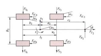
摘要:针对中置轴列车行驶过程中出现的失稳现象,建立中置轴列车的数学模型和动力学仿真模型。在 70 km/h 和 50 km/h 的行驶速度下对阶跃工况、蛇形工况和双移线工况下的侧向加速度、侧倾角和横摆角速度进行了仿真分析,并进行阶跃工况和双移线工况下的行驶稳定性试验。仿真与试验结果表明,相同速度下牵引车的最大侧倾角大于挂车;挂车的最大侧向加速度和最大横摆角速度均大于牵引车,挂车存在明显的尾部放大效应,行驶速度越快,动力学参数放大效应越明显;中置轴列车行驶过程中后方挂车各动力学参数放大效应较牵引车时间上存在明显的延迟,列车行驶速度越快,挂车响应延迟时间越短,稳定性越低,侧翻风险越大;相同行驶速度下牵引车和挂车最大侧向加速度、最大侧倾角和最大横摆角速度均出现在双移线工况下,双移线行驶工况下中置轴列车稳定性较低,侧翻风险更高。
