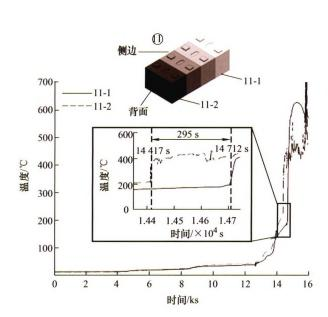
摘要:动力电池的安全问题始终阻碍着电动汽车的推广,而热失控是安全问题的主因。锂离子电池在极端滥用条件下会发生热失控,同时热失控的能量会引发模组乃至系统的热蔓延。目前,单体热失控及模组热蔓延的机理被广泛研究,有关系统层级的热蔓延研究还较少。为研究电池系统热蔓延的机理,进行电池系统热蔓延试验。根据试验中系统热失控能量释放的剧烈程度,将电池系统热蔓延分为三个阶段:始发模组内热蔓延、模组间热蔓延和轰燃。此外,根据模组的不同受热情况,模组内热蔓延的规律可总结为顺序蔓延、同步蔓延和倒序蔓延三种模式。最终,结合蔓延表征结果和电池系统结构,发现液冷板对系统蔓延路径起到导引作用,以及当系统上盖破损后,电池热失控时会伴随着火焰,进而加速系统热蔓延过程,同时还验证了空气间隙对热蔓延的延缓作用。研究揭示了电池系统热蔓延的特征,为电池系统的安全性设计提供了依据。
