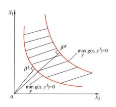
摘要:针对随机-区间变量混合模型可靠性分析问题,提出一种基于高阶矩最大熵法的结构混合可靠性分析方法。对于区间变量采用区间 Taylor 展开方法得到功能函数的下界表达式,对于随机变量首先采用最大熵方法确定功能函数概率密度表达式,然后利用 Taylor 展开和 Pearson 曲线族方法确定功能函数标准化后的六阶矩,利用 Matlab求解概率密度函数的参数,并拟合概率密度曲线,最后积分求解功能函数的最大失效概率。该方法应用于一个数值算例和一个工程结构算例,数值算例计算结果与区间蒙特卡洛方法对比,验证了该方法具有较好的精度和效率,工程结构算例以旋压设备旋轮座体在某典型产品旋压过程中的退让量为目标建立功能函数,结合有限元分析软件得到了最大失效概率,为工程结构可靠性分析提供了理论支持。
