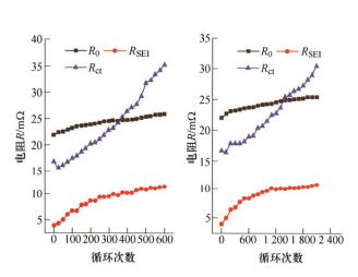
摘要: 锂离子电池的剩余寿命预测对实现高效、精准的电池管理和维护具有重要意义。电化学阻抗能够反映锂离子电池内部物理化学过程特性,在电池寿命问题研究中被广泛应用。特别地,传荷电阻描述电极界面过程进行的难易程度,可用来表征电池的寿命状态。通过开展四种工况的锂离子电池老化试验,获取传荷电阻随寿命衰减的演变规律。采用贝叶斯信息准则,对多种寿命衰减经验模型进行评价,选择并确立一阶多项式形式的经验模型。在此基础上,提出基于粒子滤波算法的剩余寿命预测方法。结果表明该方法可准确实现锂离子电池的剩余寿命预测,从而能够为电池管理和维护提供必要的电池寿命信息。
