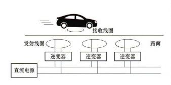
摘要:针对电动汽车动态无线充电过程中耦合系数会随着车辆横向位置偏移而发生随机变化,进而导致系统输出功率和效率降低的问题,提出一种基于加权平均效率的 LCC-S 拓扑结构参数优化设计方法。根据车辆行驶过程中横向偏移的统计特性,提出基于正态分布 3σ 原则的效率权重分配方法。该方法综合考虑了高、中、低三种不同耦合水平下的系统效率优化,使优化后的拓扑参数能够更好地适应动态无线充电系统实际工作特点,提高系统在不同偏移情况下的综合效率。采用优化参数搭建动态无线充电试验系统,并将提出的方法与 TWAE(Time-weighted average efficiency)方法进行对比分析,仿真和试验结果验证了该方法的有效性。
