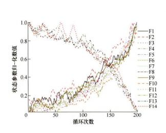
摘要:剩余寿命预测对航空发动机的预防性维修有重要指导 作用,是保障飞机安全运行,提高维修保障效率的重要手段。 一维卷积神经网络(1-dimensional convolutional neural network, 1D-CNN)和双向长短时记忆神经网络(Bidirectional long short memory, Bi-LSTM)被应用于航空发动机剩余寿命 预测模型。首先,根据工程经验在多状态参数的主成分分析 的基础上对退化过程进行随机分布拟合,得到综合性能退化 量;然后将多变量时间序列样本和对应的性能退化量代入 1D-CNN 模型进行回归分析,从而得到性能退化分析模型; 再通过 Bi-LSTM 对性能退化量进行时间序列预测,得到性 能退化的未来趋势;最后通过设定性能退化阈值,得到剩余 寿命预测结果,从而得到从多状态参数-性能退化分析-性能 退化预测-剩余寿命预测的实时动态感知模型。实例分析结 果表明,提出的混合模型与其他单一深度学习和传统模型相 比,有更低的回归分析误差和退化预测误差,能够得到更准 确可靠的剩余寿命预测结果。
