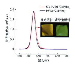
摘要:全无机钙钛矿(CsPbBr<sub>3</sub>)量子点因其优异的光学性能在 荧光温度传感器领域展现了巨大潜力。围绕高油污强干扰环境下滚动轴承内圈、保持架等旋转组件温度监测问题,针对原位生长策略不可控导致的 CsPbBr<sub>3</sub> 量子点荧光不均匀问题,提出基于静电纺丝原理制备包覆聚偏二氟乙烯(Polyvinylidene difluoride,PVDF)纤维膜的 CsPbBr<sub>3</sub> 量子点,结合正交试验法优化传感器制备工艺,并利用微观形貌表征分析手段验证其有效性。在此基础上,进一步提出利用有机硅树脂(Silicone resin,SR)涂覆工艺提升钙钛矿量子点传感器的热稳定性。最后,基于轴承保持架温度监测试验验证了静电纺丝技术结合 SR 涂覆工艺对于提升钙钛矿量子点传感器监测性能的有效性。
