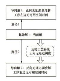
摘要: 针对作业车间调度问题(Job shop scheduling problem, JSP),以优化最大完工时间为目标,提出一种路径重连和禁 忌搜索混合算法。结合 JSP 领域知识设计路径重连,分别将 正向无延迟调度解和反向无延迟调度解作为导向解。在正向 无延迟和反向无延迟调度甘特图中,每一道工序的左边与右 边分别无可用空闲时间。提出基于当前解工序头长度的正向 无延迟调度转化算法,以及反转工件工艺路线,基于当前解 工序尾长度的反向无延迟调度转化算法。设计新的基于精英 解的回溯禁忌搜索算法,能够充分利用迭代过程中的历史解 信息。不但提取更新的当前最优解加入到精英解集合,而且 当最优解连续不更新代数达到设定值时,提取区间代数内较 好的当前解加入到精英解集合。实现精英解池的不断补充和 动态更新,使得算法可以持续进行回溯搜索。采用移动范围 更广的邻域结构进行搜索,将路径重连与禁忌搜索算法混 合,对 JSP 问题基准算例进行测试,验证了所提算法的有 效性。
