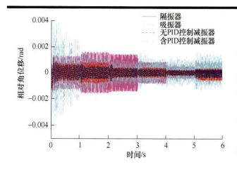
摘要: 搭建某实车动力传动系统的当量模型,建立发动机转矩激励模型,并以转速和谐次计算获得主谐次频率作为外部激励转矩的主导频率。随后对系统进行受迫振动分析,获得振动响应恶化频带,将模型简化,进行固有振动特性分析,探究振动恶化原因。然后根据系统固有振动特性匹配扭转隔振器和吸振器减振性能参数,将两种装置与动力传动系统整合,进行仿真计算,对比两种装置减振效果,并从减振机理分析两者差异性。最后将扭转隔振器和吸振器组合成减振组块安装到系统中,进行参数匹配和结构设计,制定频率调谐控制方案,利用仿真计算验证其优良的减振性能。
