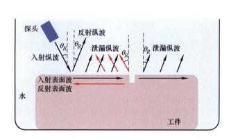
摘要:超声漏表面波可用于检测表面或近表面缺陷,其非接触检测的优点易于实现自动化检测。但由于波型转换与传播衰减,漏表面波的回波幅值较小,不利于缺陷检测和成像。仿真分析了漏表面波的传播特性及缺陷回波特征,应用主成分分析分离回波信号中的干扰波,再利用小波域隐马尔可夫模型算法分离整段信号的系统噪声,联合两种方法提取漏表面波信号中的缺陷信息,最后通过频域合成孔径算法对漏表面波扫查数据进行了高分辨率图像重建。结果表明,相比于传统 B 扫成像,基于 PCA-WHMM 的超声漏表面波 F-SAFT方法在回波信号平均信噪比上提高了 10.05 dB,平均成像误差降低了 26.3%,为金属表面及近表面缺陷检测提供了一种有效方法。
