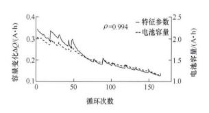
摘要:精确、可靠的电池容量预测可以避免电池滥用,提升电池使用安全;同时在此基础上开展的剩余寿命估测能够为电池系统维护及更换提供参考。基于改进双最小二乘支持向量机方法和 Box-Cox 变换,提出一种锂离子电池容量及剩余循环寿命的协同估算方法。首先提取老化电池部分容量增量曲线包络面积作为特征量,通过 Box-Cox 变换进一步提高特征量与目标估计量之间的相关性。然后基于瑞利熵理论改进传统最小二乘支持向量机算法的稀疏性,建立电池容量和剩余使用寿命协同估算模型,结合层次分析法和熵权法对估算结果进行充分地评估。最后,采用粒子群优化算法搜索改进最小二乘支持向量机算法中的最优超参数组合。估算结果显示所研究的方法能够显著提高特征参数与估计量之间的线性相关性,容量估计误差小于1.44%,剩余使用寿命预测误差小于47次循环,验证了算法的有效性。
