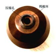
摘要:单电极单电弧热源存在热力耦合的固有特性,制约了对熔池热力行为的精确调控,需要改进成弧方式来缓解电弧热力输出的耦合效应。提出双层电弧同轴复合成弧技术,基于等离子弧焊枪,设计了新型喷嘴,将环形自由电弧与中心的压缩电弧同轴复合。电弧燃烧试验测试发现,所设计的焊枪能够形成稳定的复合电弧,电弧宽度可由环形电弧电流调节;将复合电弧与纯压缩电弧进行初步的穿孔焊接对比试验,复合电弧能够实现稳定的穿孔焊接,焊接过程中的小孔行为和焊缝结果与常规压缩电弧基本一致。开展的试验结果初步验证了双层同轴复合电弧焊的可行性,为后续改善穿孔焊接小孔稳定性奠定基础。
