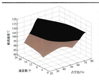
摘要:均衡系统是解决动力电池系统不一致性的有效途径,然而电池组均衡电路产热过大也易引发控制器安全问题。针对均衡电路产热引发的热安全问题,以某分布式控制器为研究对象,建立电池管理系统控制器和电路板的热力学模型;通过温度场仿真研究不同动态均衡控制策略下电路板的最高温度以及温度分布;分析开启通道位置对动态均衡电路板温度分布的影响,计算在满足热安全设计条件下的各工况下的最大均衡工作效率及热安全边界,获得一套适用于电池管理系统均衡时的热力学模型建立和热仿真分析的方法。仿真与试验结果表明,任意采样点模型误差小于4℃,可以直观准确模拟动态均衡电路板的温度分布。
