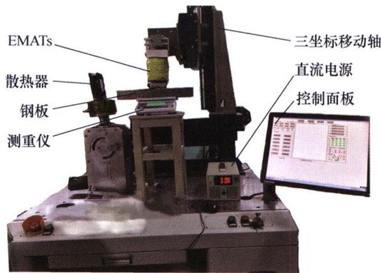
**摘要:** 电磁超声换能器一般采用具有超强磁力的稀土永磁制作,在实际检测中由于磁力不可控,存在偏置磁场不够强导致换能效率过低和磁力过强造成操作不方便等问题。提出一种偏置磁场磁力可控的电磁超声换能器,采用电磁铁与永磁铁相结合的方式,达到偏置磁场磁力可控的目的。通过有限元仿真和试验得出,提出的偏置磁场磁力可控的电磁超声换能器,在电磁铁处于关闭模式下,永磁铁能够提供基础磁场;采用增强模式或减弱模式,无被测物时,换能器下表面平均垂直磁通最大分别增强 78.58%和减弱 19.36%,而提高 2 mm 检测钢板时,换能器下方钢板表面平均垂直磁通最大分别增强 52.99%和减弱 38.02%;得出 3 种模式下,探头磁力随着提高距离缩小而增强的试验曲线;通过增强模式对铝板和钢板进行测厚试验,将检测信号幅值分别提高 46.91%和 62.01%。所设计的磁力可控电磁超声换能器不仅具有磁力可控的功能,还能够提高检测信号幅值。
