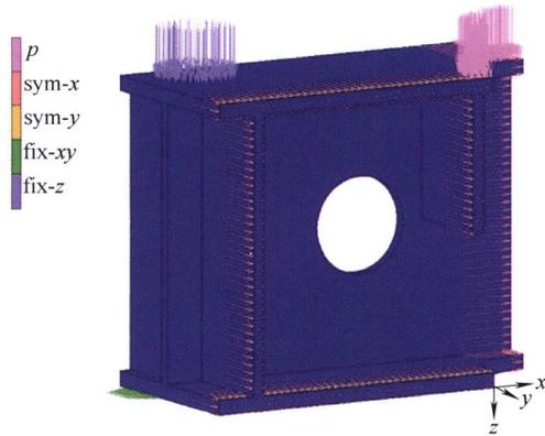
**摘要:** 安定性分析是承受循环载荷作用的结构设计与安全评定的重要理论依据,更能反映结构的实际承载能力。材料在循环载荷作用下会呈现一定的循环硬化/软化特性,从而影响结构的安定性。以常用的 Q235 钢为研究对象,分别对 Q235 板材进行单向拉伸和对称应变控制的循环加载试验,测量相应的应力-应变曲线及材料力学性能参数,研究其单向拉伸性能及循环硬化/软化特性。运用试验所测得的不同加载条件下的材料参数对箱型承载结构进行安定性数值分析,并与文献中该箱型结构的安定性试验研究结果进行对比。结果表明, Q235 在循环载荷作用下表现出循环软化特性。采用单向拉伸条件下的性能参数得到的安定性分析结果与物理试验结果相比,误差为 25.3%;采用材料循环加载条件下的性能参数得到的安定性分析结果与物理试验结果相比,误差为 6.7%,考虑循环软化特性时安定性分析结果更接近物理试验结果。
