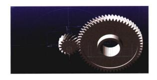
摘要:斜齿轮是汽车变速器的核心传动零部件,齿面点蚀是影响汽车变速器传动平稳与可靠性的主要故障形式之一。通过冲击函数法,接触线百分比法和齿轮系统动力学理论,建立了不同点蚀类型的斜齿轮系统动力学模型,分析了点蚀斜齿轮系统的动态响应。同时,通过齿轮疲劳点蚀试验,获得了不同点蚀程度齿轮振动加速度信号,并通过快速傅里叶变换(Fast Fourier transformation, FFT)分析,得到了不同点蚀程度对齿轮振动加速度的时域和频域特征变化规律,验证了动力学模型的准确性。结果表明,运用动力学方法分析斜齿轮系统动态响应可以对斜齿轮点蚀程度和点蚀形式进行预测和识别。
