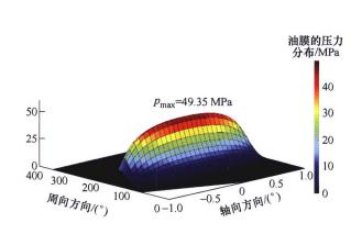
摘要:以滑动轴承为研究对象,考虑轴颈倾斜及润滑油黏压效应影响,建立轴承应力偶流体动力润滑模型,引入临界油膜厚度系数,探究应力偶流体对油膜厚度的敏感度,分析应力偶流体计入区域、应力偶系数、倾斜角及黏压效应对轴承润滑特性的影响。结果表明:随着应力偶系数的增加,润滑特性参数随油膜厚度的敏感度逐渐增加。较牛顿流体,考虑滑油应力偶效应时,轴承油膜压力显著增加,且随着应力偶计入区域的增加,轴承最大油膜压力逐渐增加,摩擦因数逐渐减小。在最小油膜厚度区域附近计入应力偶效应时,影响最为显著。轴颈发生倾斜时,倾斜作用将加剧应力偶效应,且随着应力偶系数的增加,倾斜对应力偶效应的影响愈加显著。黏压效应对应力偶流体轴承油膜压力有显著影响,但对于摩擦因数及端泄流量,其影响微弱。
