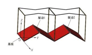
摘要:为了解决平板折展机构单元构型种类少的问题,对平板折展机构进行了构型综合,并优选出了一种机构进行运动学分析。基于对平板折展机构收拢原理的分析,运用旋量理论提出了一种平板折展单元机构的构型综合方法,综合出多种平板折展机构构型。通过分析比较优选出一种运动副全部为转动副的平板折展机构,对其构型机理及几何特征进行了分析,并基于旋量约束拓扑图计算了机构自由度。然后对其进行了运动学分析,分析了各个构件的角速度,进而推导得到了各个构件的质心线速度与质心线加速度,并进行了数值计算与仿真验证,验证了理论分析结果的正确性。研究内容可以为此类机构的设计分析与工程应用提供参考。
