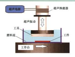
摘要: 抛光加工是实现高性能零件最终表面质量要求的重要的方法。超声振动辅助磨料流抛光是磨料流抛光与超声振动相结合的复合抛光技术,在光学玻璃、蓝宝石、单晶硅、陶瓷等硬脆性材料抛光和金属材料零件复杂表面的抛光加工中具有独特的优势,可以有效地提高表面质量和抛光效率。对近年来的技术发展进行了总结,对抛光加工基本原理研究、材料去除微观机理研究、抛光工艺方法分类及应用等方面进行了系统的论述和分析。指出了这一技术当前的研究热点和需要解决的关键问题,对今后的研究、应用和发展给出了建议和展望。
