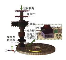
摘要: 针对机械系统中普遍存在的摩擦振动现象, 结合试 验分析和数值模拟的方法,提出采用压电材料进行摩擦振 动能量收集的新思路。本研究搭建了一种既能产生摩擦振 动,同时又能利用压电材料将振动能量转化为电能的试验 装置,摩擦学试验结果验证了利用压电材料实现摩擦振动 能量收集的可行性。利用有限元软件 ABAQUS 对试验过 程进行模拟,首先采用复特征值分析法对压电式能量收集 器的响应特性进行分析,结果表明摩擦系统在法向和切向 上出现的不稳定振动模态是实现摩擦振动能量收集的重 要因素。采用瞬时动态分析法对摩擦系统的动力学响应进 行模拟,结果表明瞬态分析能够从时域上很好地模拟试验 过程, 较大的法向载荷导致系统产生较强的摩擦振动, 从 而导致压电材料变形位移增大,进而输出较高的电压;摩 擦系统存在一定的临界速度, 使得系统能够产生最强的摩 擦振动能量,并对外输出最大电压信号;进一步地,本研 究建立起摩擦与压电相互耦合的二自由度数学模型,验证 了摩擦振动能量收集的可行性, 并定性分析了法向载荷和 运动速度对系统响应的影响。以上研究结果能为实现摩擦 振动的能量收集提供理论依据。
