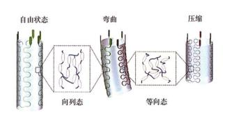
摘要:人工肌肉通常是指能够在外界物理或化学刺激下发生伸缩、膨胀、弯曲、扭转等运动并对外做功的柔性材料或器件,借助人工肌肉驱动可大幅提高机器人的柔顺适应能力和人机力学交互的舒适性。人工肌肉的发展已有超过六十年的历史,其激励方式也包括电、热、内压等多种形式;尝试从人工肌肉种类、驱动原理、性能指标、应用场合、发展趋势等方面对人工肌肉相关内容予以较全面的综述,以期为机器人或其他领域感兴趣的学者提供参考和对比。
