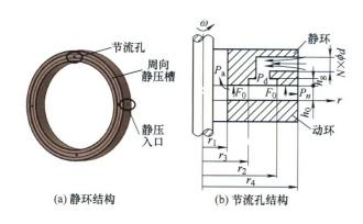
摘要:针对液体火箭发动机机械密封的二次利用问题,为避免碰磨进行了动静压机械密封的结构设计及端面槽型优化研究。采用动压和静压联合工作的原理,设计了动静压机械密封结构,并对静环节流孔及动环动压槽进行了重点设计;基于流体力学方程求解了静环的开启力及泄漏量,通过课题组已有机械密封计算软件计算了动环的开启力及泄漏量等指标;针对外螺旋槽内人字槽的组合槽型,采用正交试验的方法对槽型进行了优化,选定了最优槽型方案,该槽型优化方案的开启力为8.2 kN,泄漏量为0.66 mL/s,在保证泄漏量的前提下可以获得更大的开启力。研究结果表明,采用动静压形式的机械密封在工作中可有效减少磨损,保证泄漏量较小,满足二次利用的要求。该研究成果也可为其他高速旋转机械的机械密封结构优化提供参考。
