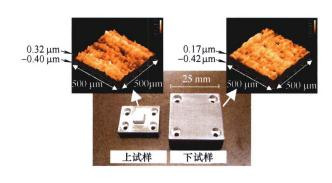
摘要:针对现有结合面静摩擦因数分形模型的静摩擦因数随结合面法向接触载荷增大而增大,与试验研究结论及统计模型不一致的问题,基于尺度等级定义微凸体的大小,严格区分微凸体高度与变形,构建各尺度等级微凸体的法向接触载荷与接触面积之间关系及其发生弹性和弹塑性第一变形时所能承受的最大切向载荷即最大静摩擦力计算模型,进而建立结合面法向接触载荷与最大静摩擦力计算模型,在此基础上,依据结合面静摩擦因数定义,提出与微凸体尺度等级关联的考虑微凸体完全弹性、弹塑性和完全塑性三种变形机制的结合面静摩擦因数三维分形模型,数值仿真分析了结合面静摩擦因数与法向接触载荷和分形维数 D 等的关系,结果表明结合面静摩擦因数随着结合面法向接触载荷的增大而减小,随着分形维数的增大而增大,并试验实例验证了所建模型的正确性,解决了现有结合面静摩擦因数分形模型与统计模型和试验结果之间的不一致性。
