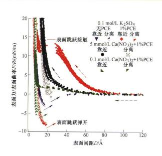
摘要: 为揭示盐溶液条件对边界润滑添加剂聚醚接枝聚羧酸盐(Poly(carboxylate ether), PCE)吸附行为的影响,利用表面力仪在一种商业 PCE 的多种水溶液中直接测量带电云母表面之间的法向作用力。力一距离测量表明 PCE 从 0.1 mol/L K<sub>2</sub>SO<sub>4</sub>溶液中微弱地吸附于云母表面,其边界吸附薄膜(厚度约 50 Å)在相当于三四个大气压的载荷条件下即从两表面间完全挤出。解吸附之后,PCE 能立即实现相同的再吸附。在相同离子强度的 0.1 mol/L Ca(NO<sub>3</sub>)<sub>2</sub>溶液中,PCE 却不吸附于云母表面。但是,在低浓度的 5 mmol/L Ca(NO<sub>3</sub>)<sub>2</sub>溶液中,PCE 在云母表面建立厚度约 40 Å 的牢固边界吸附层。二价 Ca<sup>2+</sup>离子能桥接两 PCE 边界吸附层,而单价的 K<sup>+</sup>离子不能。二价阳离子桥接吸附机理只能在有限的离子浓度范围内发生。
