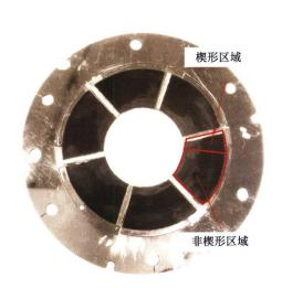
摘要: 简要介绍了气体止推箔片轴承的结构, 建立了止推轴 承数值求解的理论模型,利用有限元法和有限差分法耦合的 方式求解气体雷诺方程和气膜厚度方程。通过仿真分析获得 了止推轴承承载力随着楔形入口高度的变化关系,发现存在 一个最佳的楔形入口高度使轴承的承载力达到最大; 在最佳 楔形入口高度之前,轴承承载力随着楔形入口高度的增大而 急剧增大;在最佳楔形入口高度之后,轴承承载力随着楔形 入口高度的增加而缓慢减小。搭建了止推轴承性能测试试验 台,对试验台各部分及试验原理进行简单介绍。同时,加工 制作了3个具有不同楔形入口高度(20 µm, 70 µm、114 µm) 的止推轴承, 并在 15 000 r/min、21 000 r/min、25 000 r/min、 28 000 r/min 转速下进行了极限承载力试验,与仿真分析进 行对比。结果表明: 楔形入口高度为 20 μm 的止推轴承所表 现出来的轴承性能最好,楔形入口高度为 70 μm 和 114 μm 的止推轴承性能相差不大。在设计、制造止推轴承时,选取 适当的轴承楔形入口高度是十分重要的。
